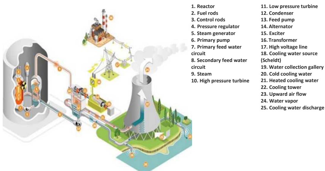
Rysunek 2: Eksploatacja elektrowni jądrowej z (od lewej) budynkiem reaktora, maszynownią i obiegiem chłodzenia (źródło: Electrabel SA).
