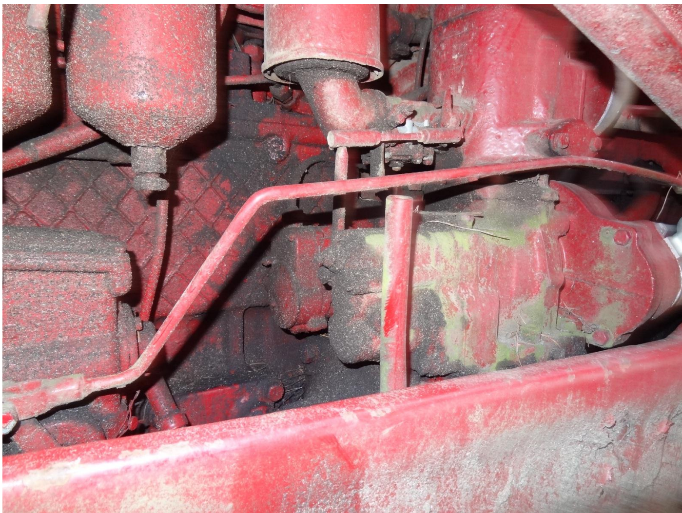
5.2. Podwozie z ramą wzdłużną – oś przednia, tylny most napędowy, elementy przeniesienia napędu, układ kierowniczy oraz hamulcowy – kompletne. Gąsienice – sprawne w stanie dobrym. Nie stwierdzono widocznych uszkodzeń ramy wzdłużnej. Widoczne liczne ubytki lakieru z ogniskami korozji zewnętrznej na elementach podwozia z ramą wzdłużną.
