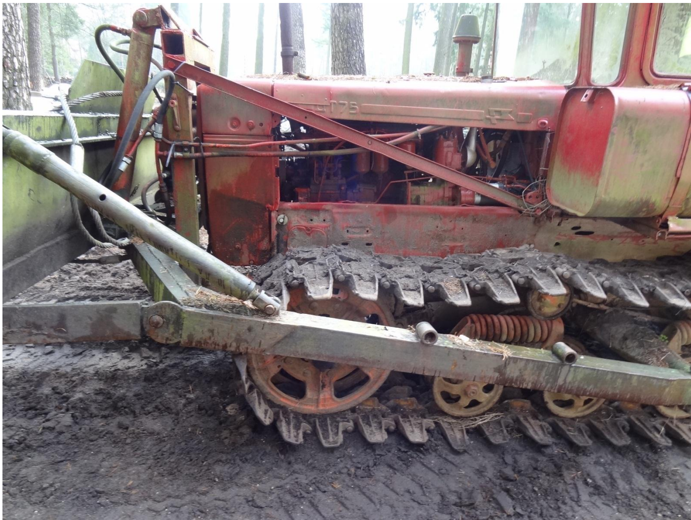
5.4. Osprzęt ciągnika – kompletny. Lemiesz - zużyty. Na przegubach elementów ruchomych, lemiesz czołowego, występują luzy związane z nadmiernym zużyciem. Na elementach zewnętrznych osprzętu ciągnika występują liczne przytarcia powierzchniowe z ubytkami lakieru i ogniskami korozji.
