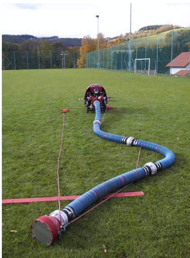
Rys. 11 Właściwie sprawiona linia ssawna
