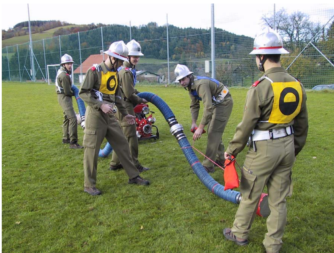
Rys. 9 Przewodnik roty drugiej mocuje linkę zabezpieczającą, zakładając całą pętlę na wężu ssawnym ze strony wodnej.
