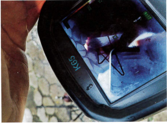
➌ Widoczny stopień pokrycia butli wodą (jasne partie to wciąż nagrzane fragmenty płaszcza, do których woda nie dociera). Termowizja pozwala dobrze oszacować skuteczność chłodzenia
