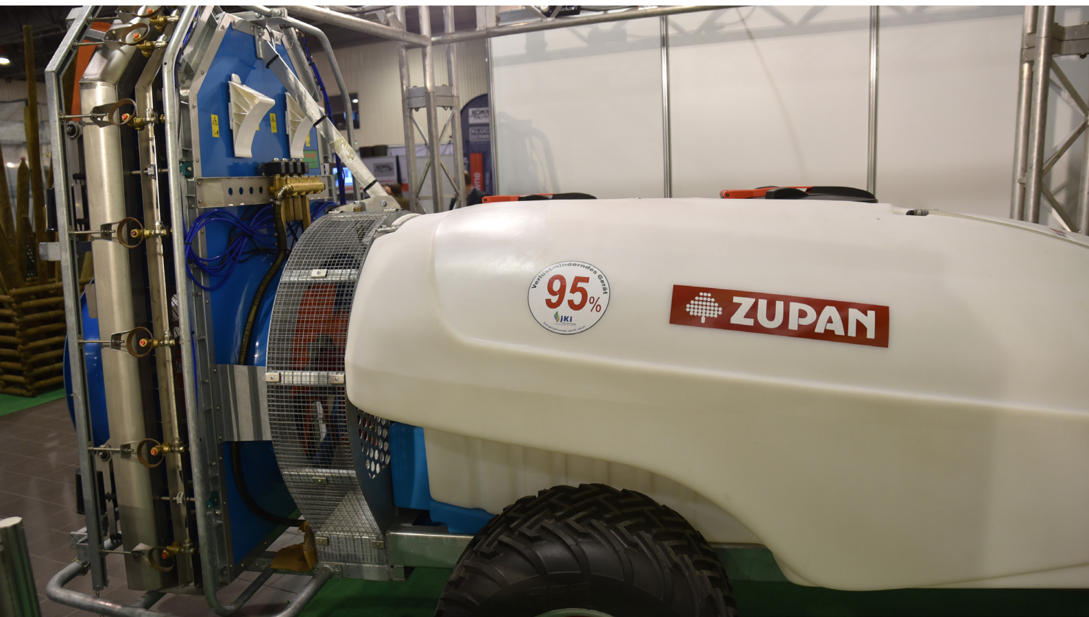
Fot.2 Opryskiwacz sadowniczy z elektrostatycznym ładowaniem kropli indeks redukcji znoszenia 95%
