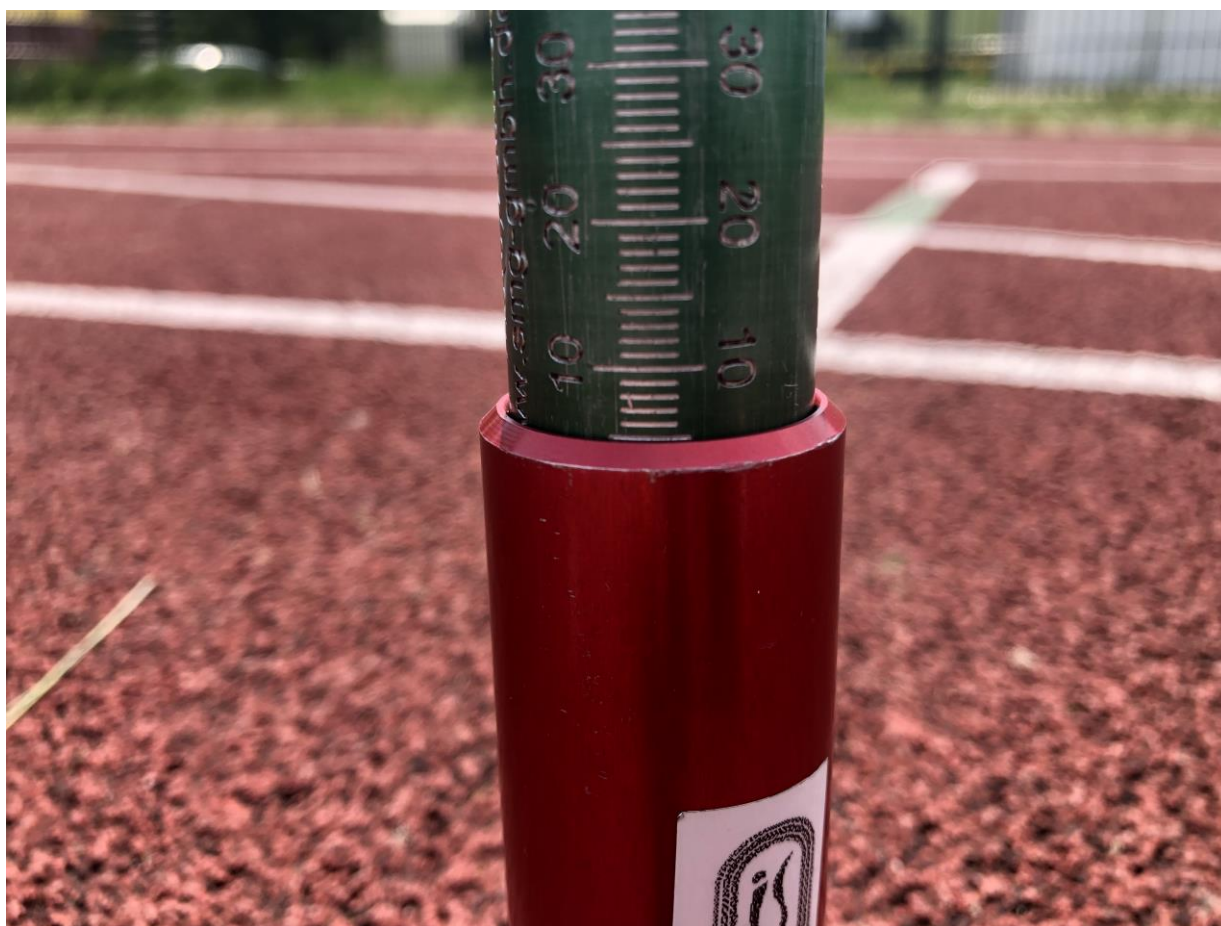
Fot. 3 Najcieńsza grubość nawierzchni na torze biegni.
