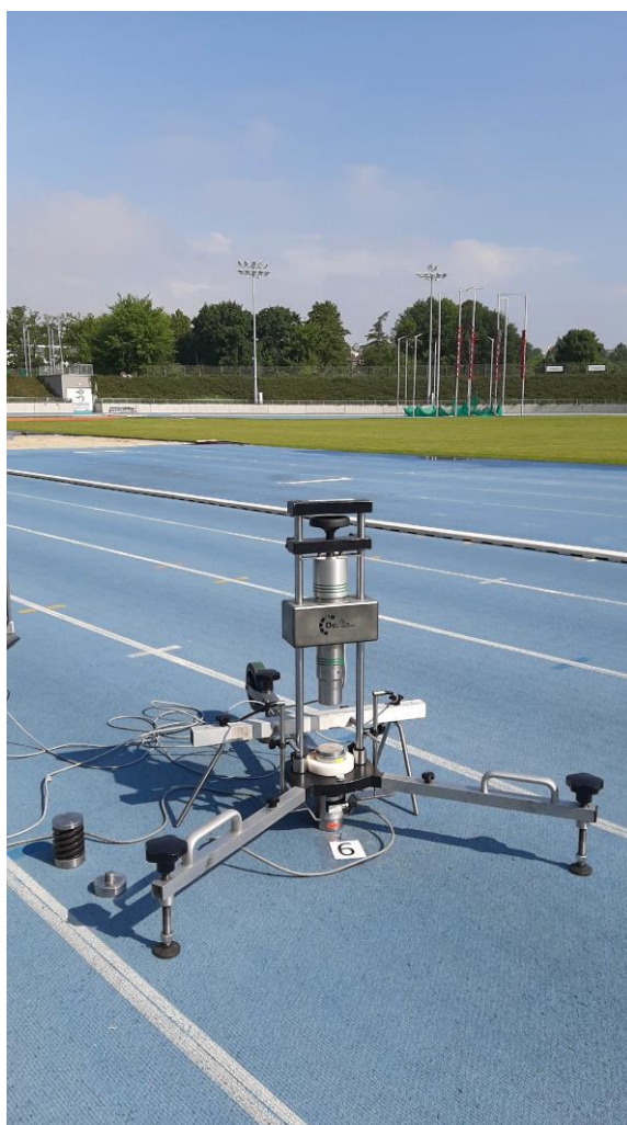
Fot. 5 Badanie amortyzacji uderzenia i odkształcenia pionowego
