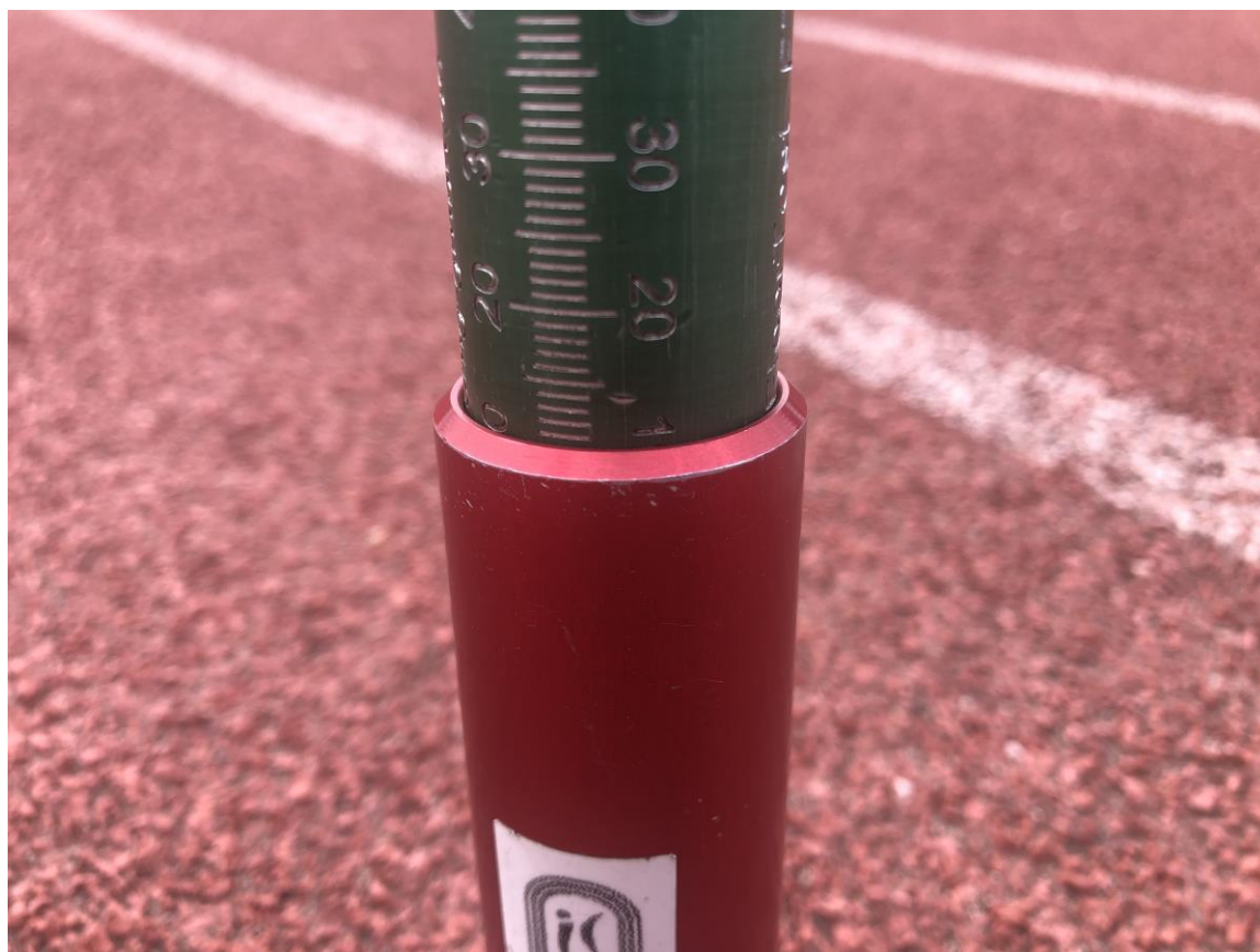
Fot. 3 Najcieńsza grubość nawierzchni na torze biegni.
