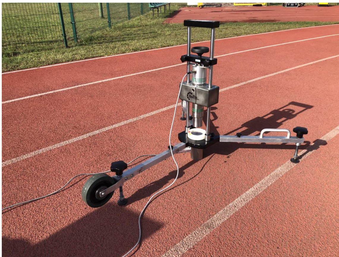
Fot. 2 Badanie amortyzacji uderzenia w punkcie 1
