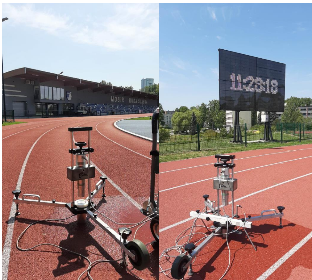
Fot. 2 Badanie amortyzacji uderzenia oraz odkształcenia pionowego
