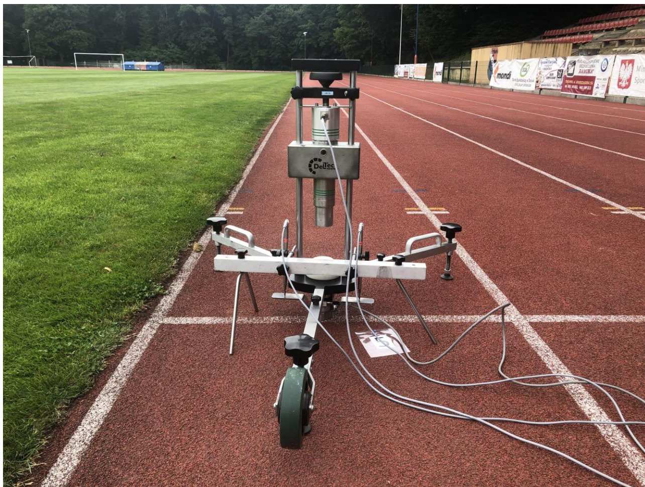
Fot. 9 Badanie odkształcenia pionowego na torze 1
