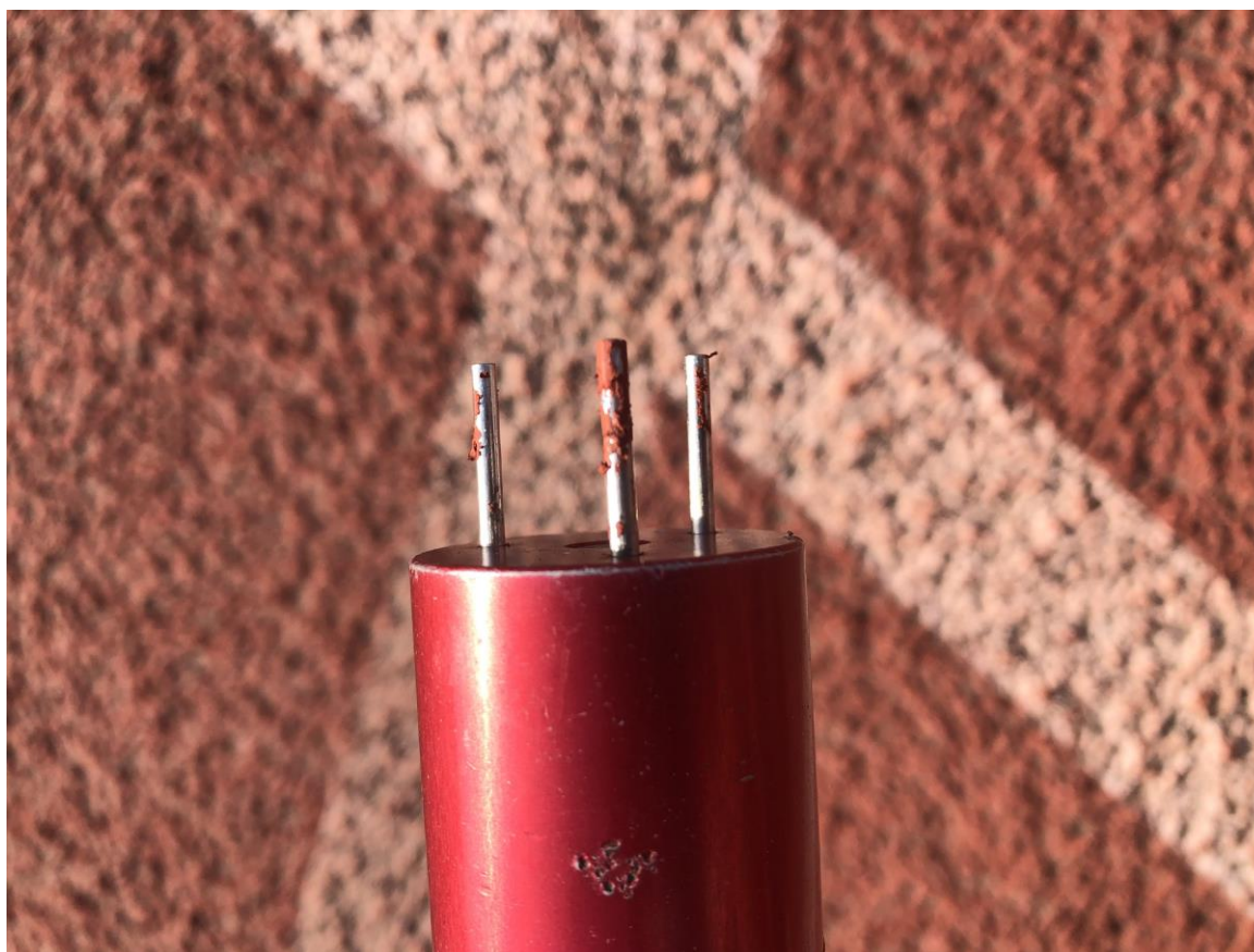
Fot. 6 Zabrudzenia igieł grubościomierza plastyczną masą z granulatu EPDM
