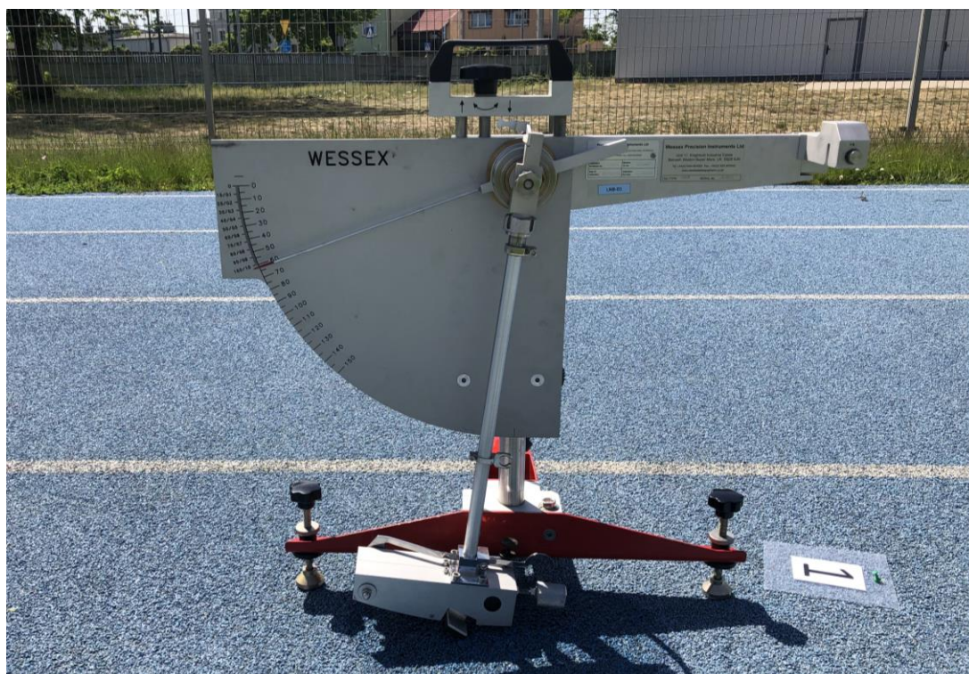
Fot. 5 Pomiar oporu poślizgu w punkcie 1
