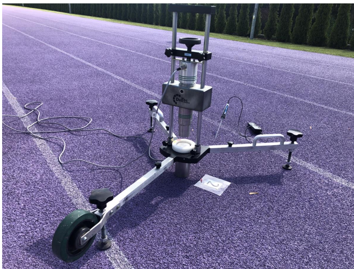
Fot. 5 Badanie amortyzacji w punkcie 2
