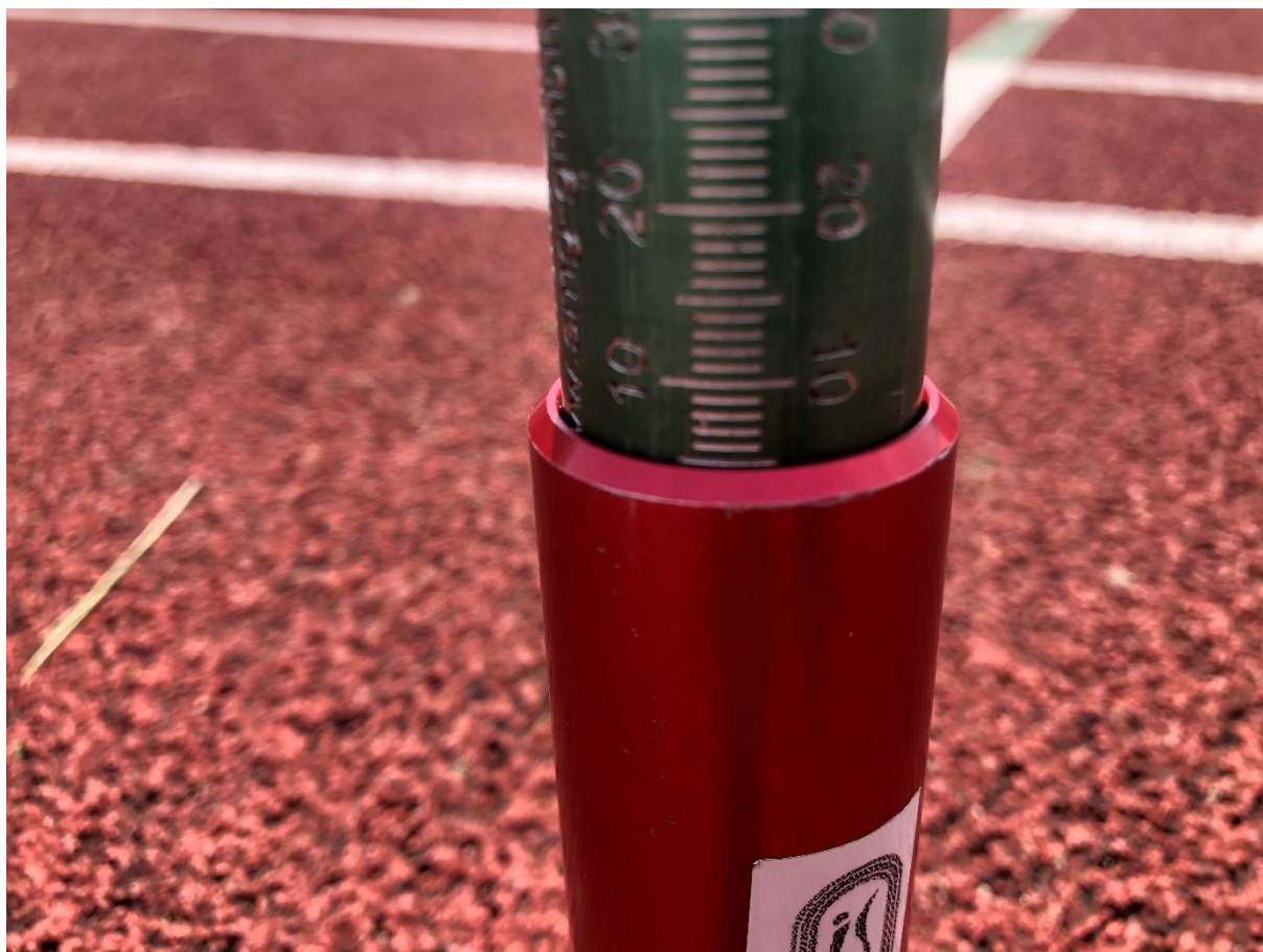
Fot. 17 Pomiar grubości nawierzchni na stadionie w Staszowie – 10m/tor 3
