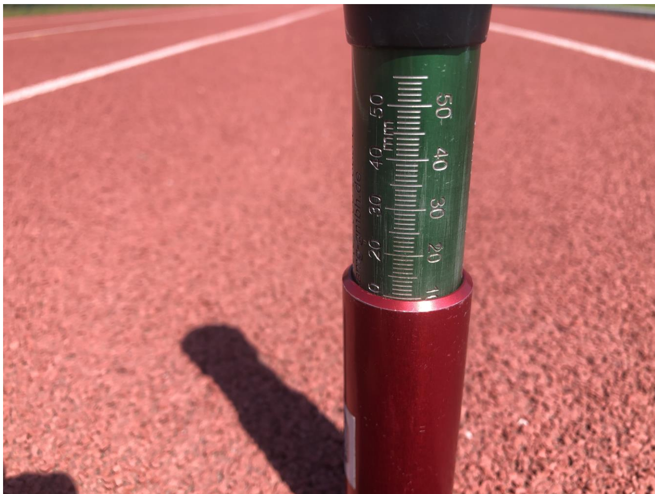
Fot. 3 Pomiar grubości bieżni – najcieńszy punkt
