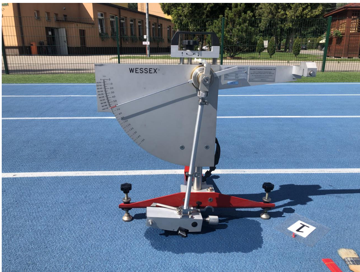
Fot. 4 Badanie oporu poślizgu na mokro
