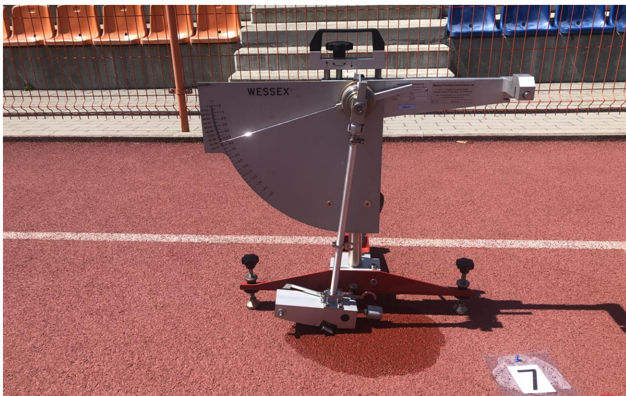
Fot. 6 Pomiar oporu poślizgu w punkcie 7
