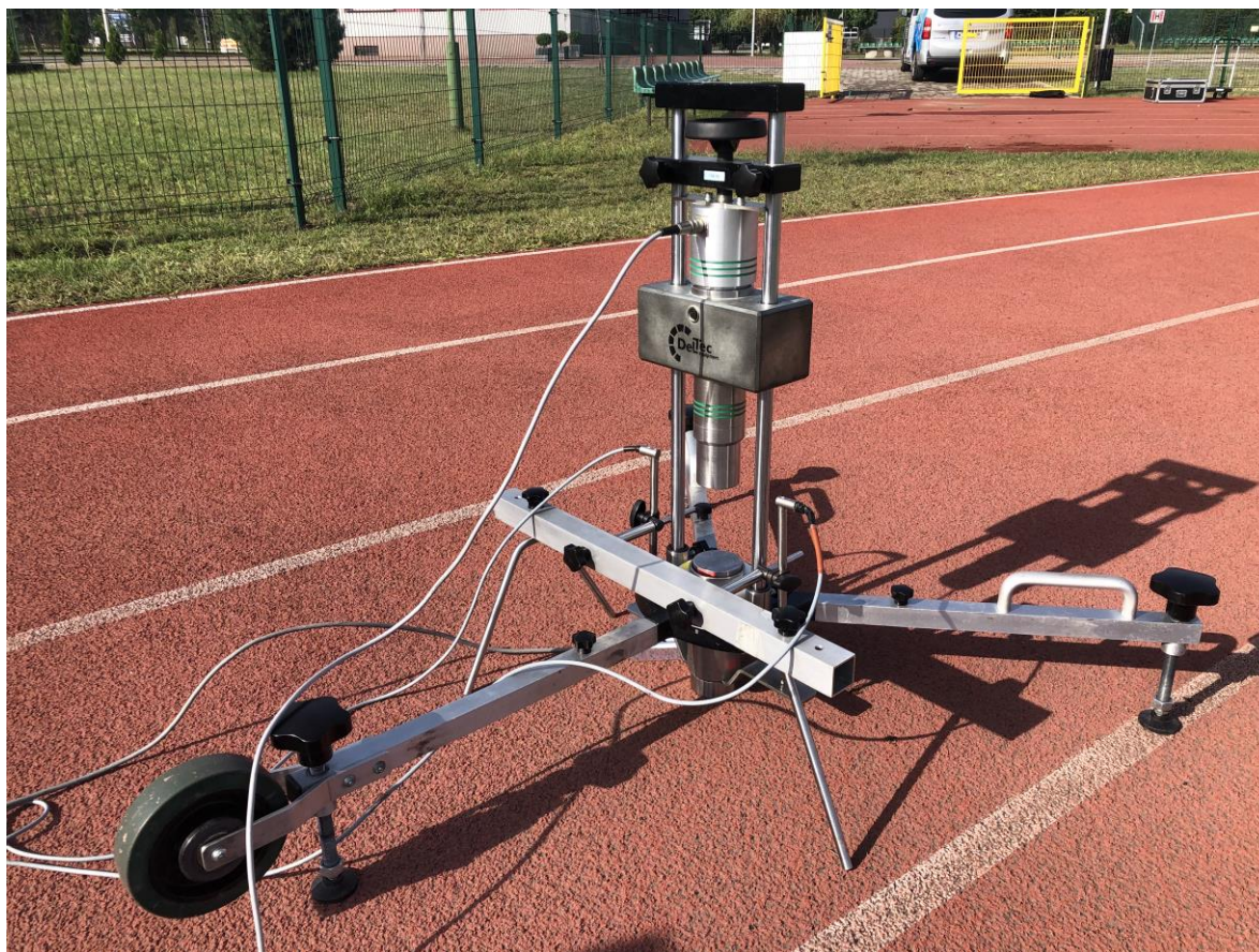
Fot. 3 Badanie odkształcenia pionowego w punkcie 1
