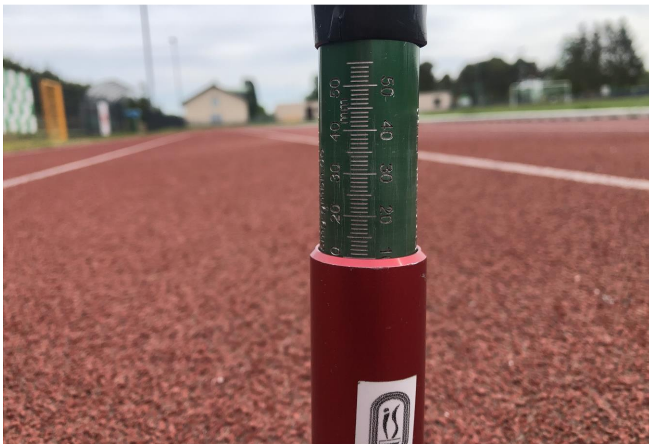
Fot. 3 Najcieńsza grubość nawierzchni na torze bieżni.
