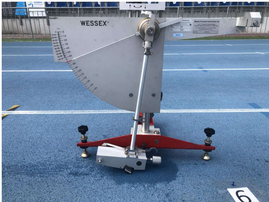
Fot. 3 Badanie oporu poślizgu na mokro
