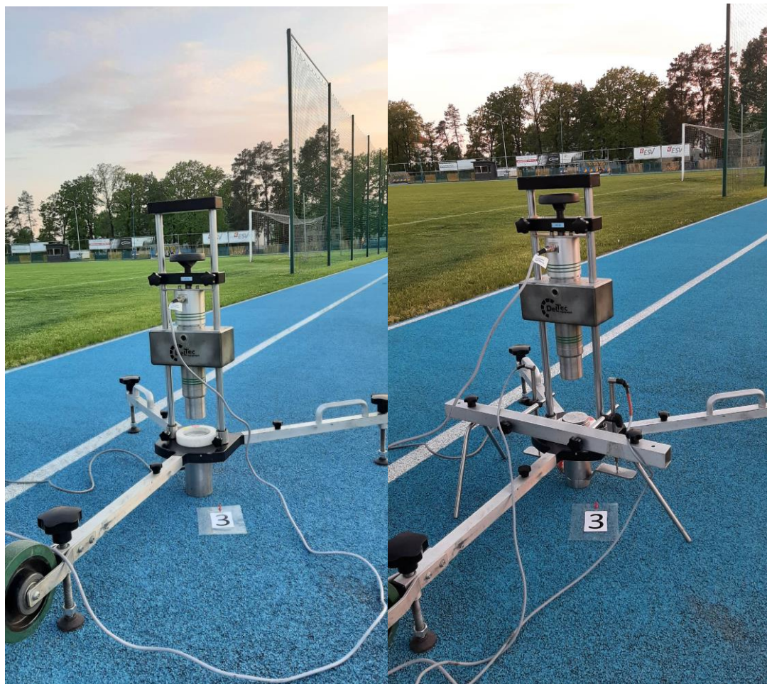
Fot. 2 Badanie amortyzacji uderzenia oraz odkształcenia pionowego.
