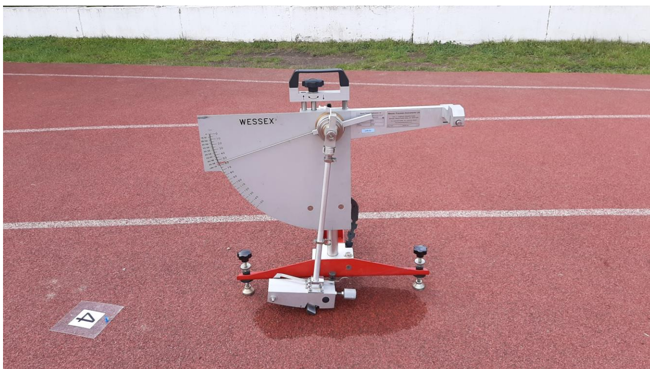
Fot. 5 Badanie oporu poślizgu na mokro
