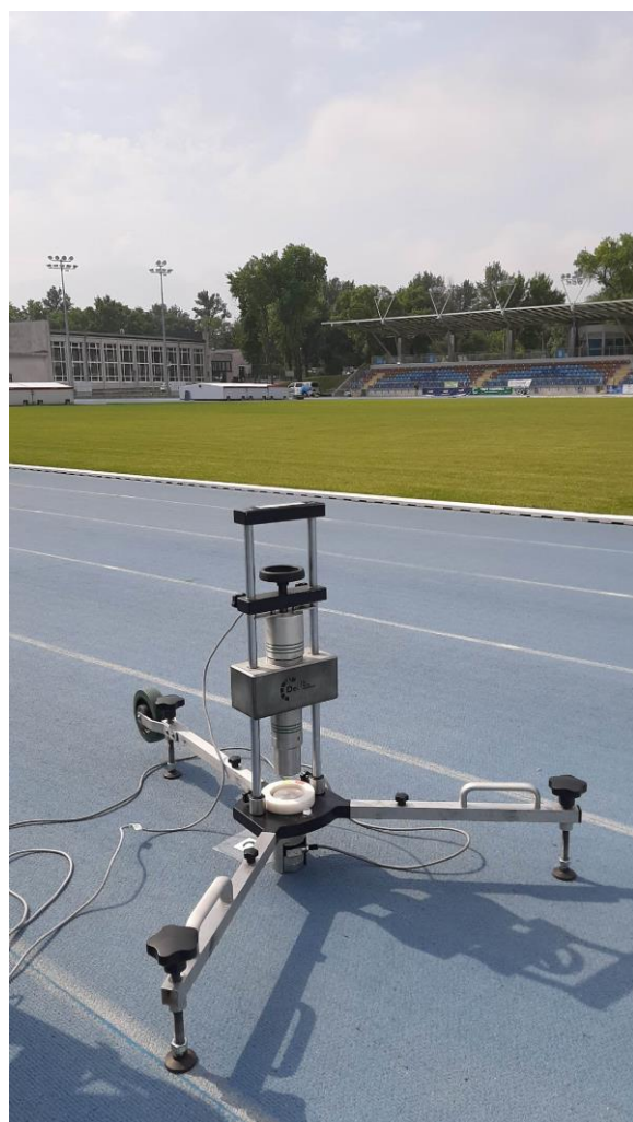
Fot. 5 Badanie amortyzacji uderzenia i odkształcenia pionowego
