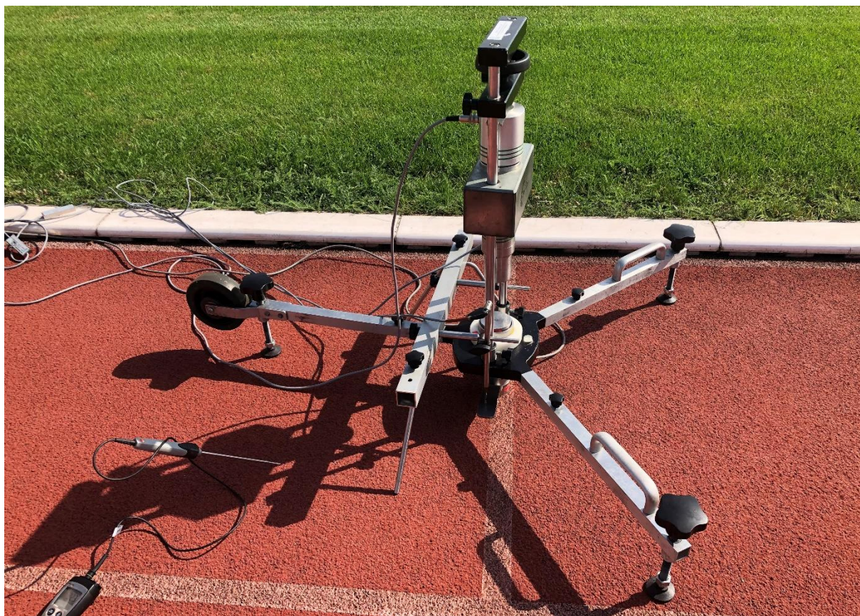
Fot. 15 Pomiar odkształcenia pionowego nawierzchni w Białobrzegach
