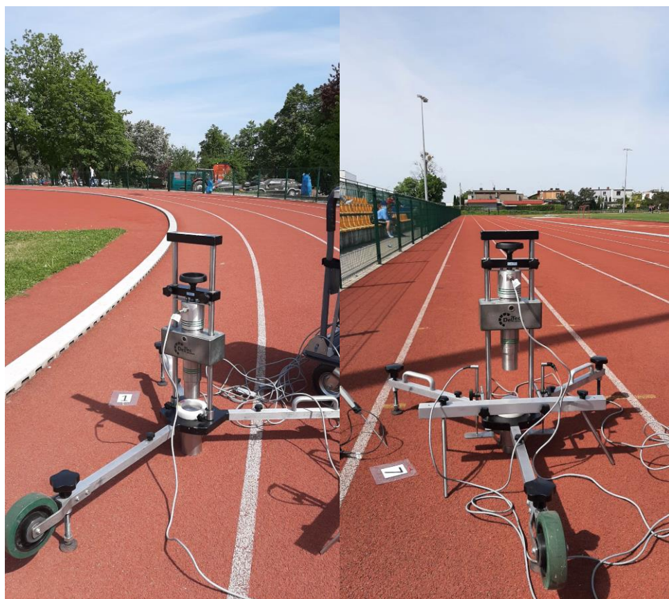
Fot. 2 Badanie amortyzacji uderzenia oraz odkształcenia pionowego.
