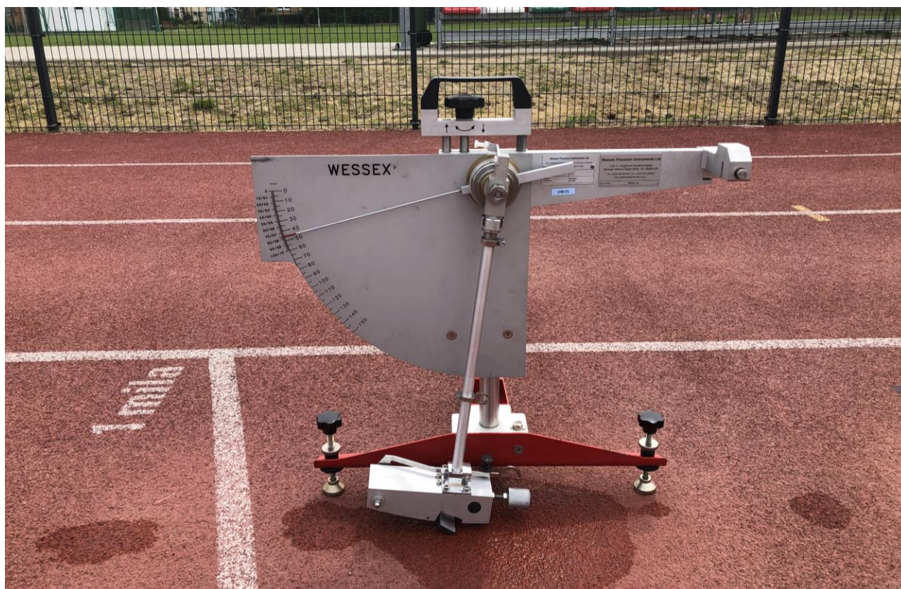
Fot. 7 Badanie oporu poślizgu w miejscu o gładkiej fakturze warstwy użytkowej
