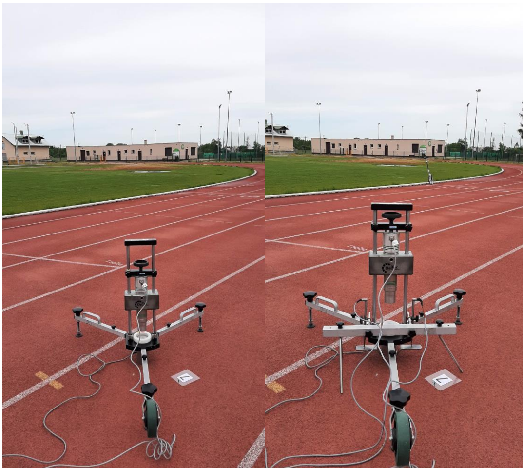
Fot. 6 Badanie amortyzacji uderzenia i odkształcenia pionowego w punkcie 7.
