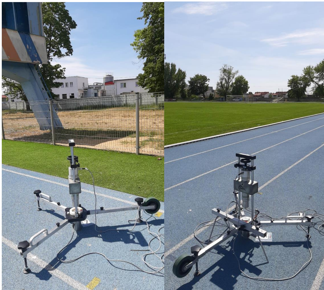
Fot. 4 Badanie amortyzacji uderzenia oraz odkształcenia pionowego
