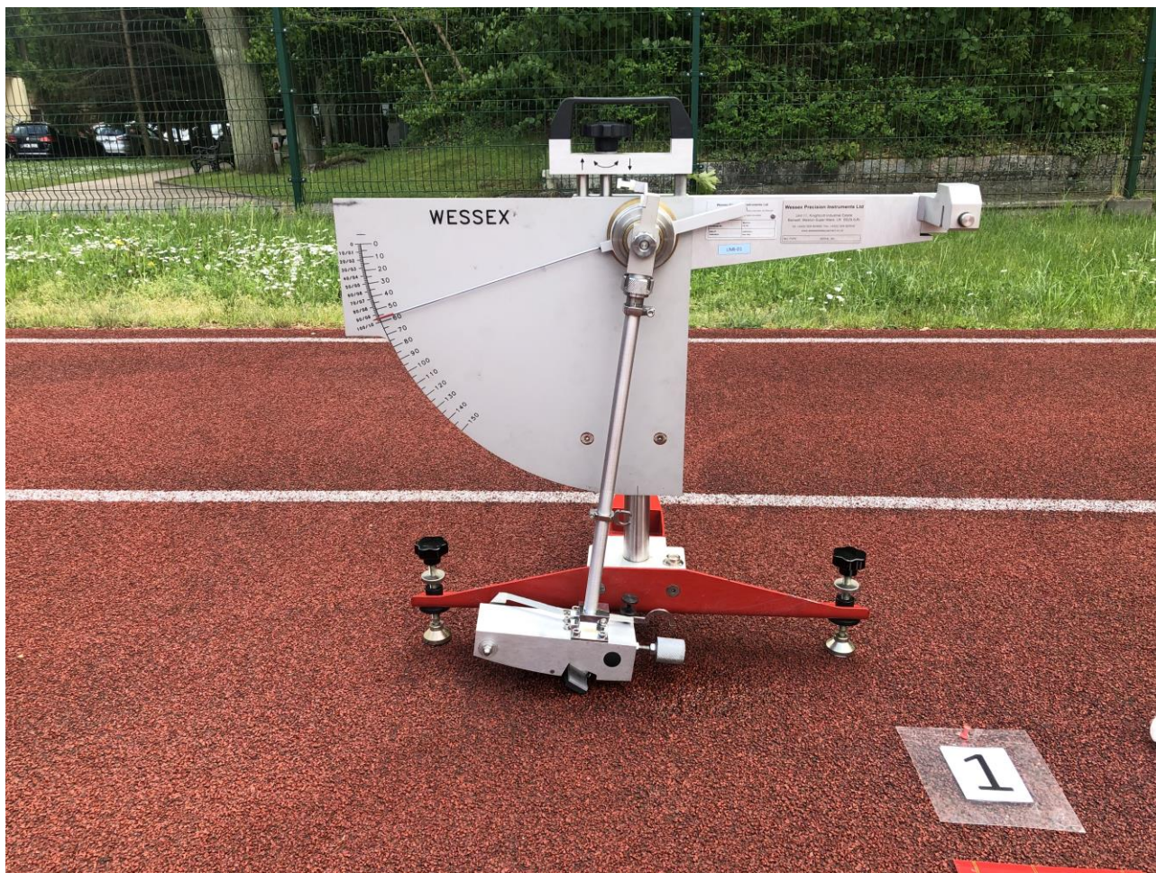
Fot. 6 Badanie oporu poślizgu w punkcie 1
