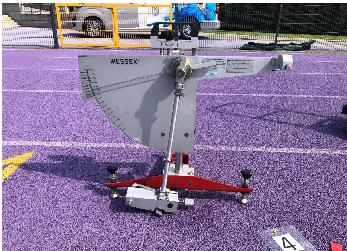
Fot. 16 Pomiar oporu poślizgu na nawierzchni w Gliwicach
