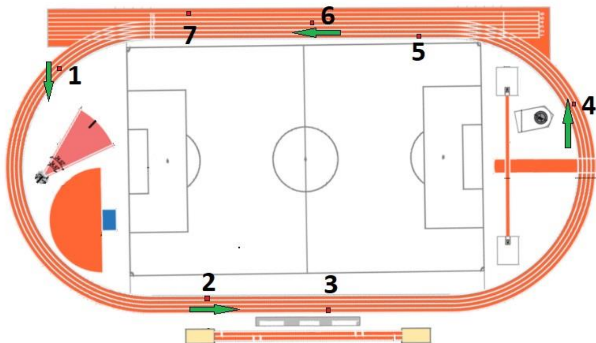
Rysunek 1 Plan obiektu z zaznaczonymi lokalizacjami punktów badawczych amortyzacji siły, odkształcenia pionowego oraz oporu poślizgu.
