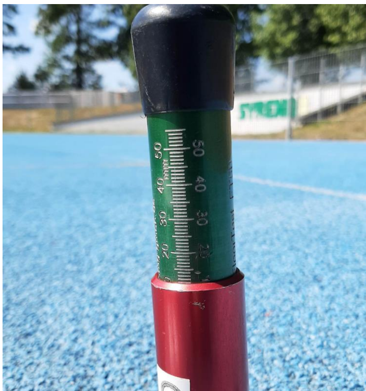
Fot. 3 Najcieńsza grubość nawierzchni na torze bieżni.
