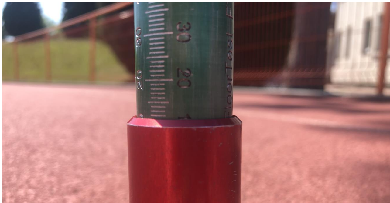
Fot. 4 Pomiar grubości nawierzchni na bieżni
