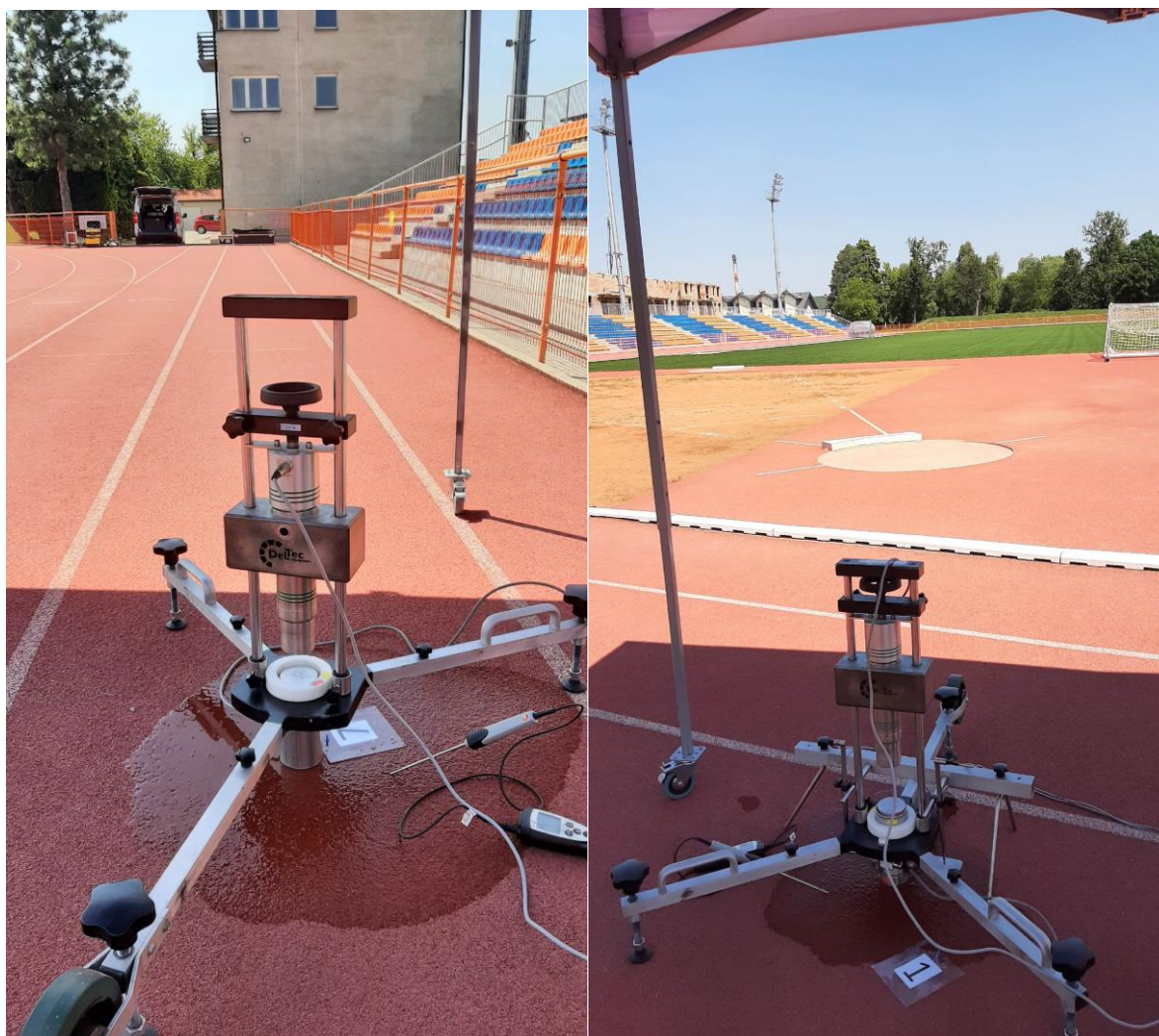
Fot. 5 Badanie amortyzacji uderzenia oraz odkształcenia pionowego
