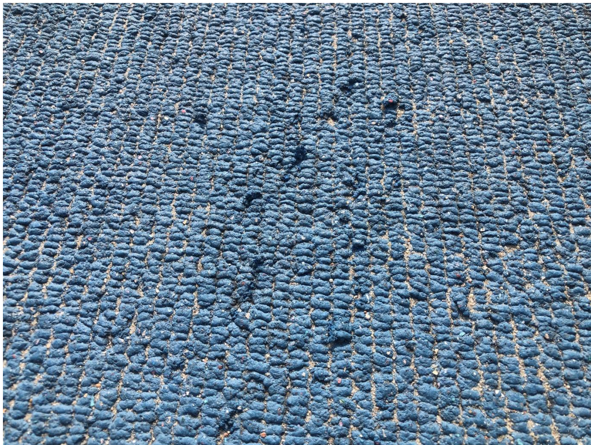
Fot. 21 Przykład zniszczenia nawierzchni przez kolce lekkoatletyczne
