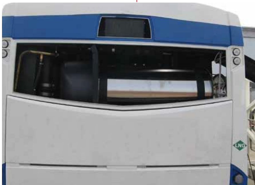
Rys. 6. Położenie zainstalowanego zbiornika paliwa nad komorą silnika pojazdu wraz z widocznym oznakownikiem zewnętrznym zasilania LNG (autobus bez wklejonej tylnej szyby)
