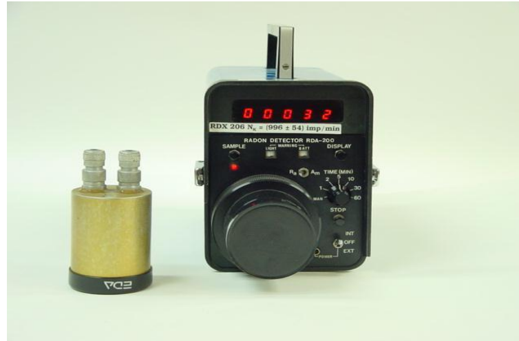
Miernik RDA-200 do pomiaru chwilowych stężeń radonu.
