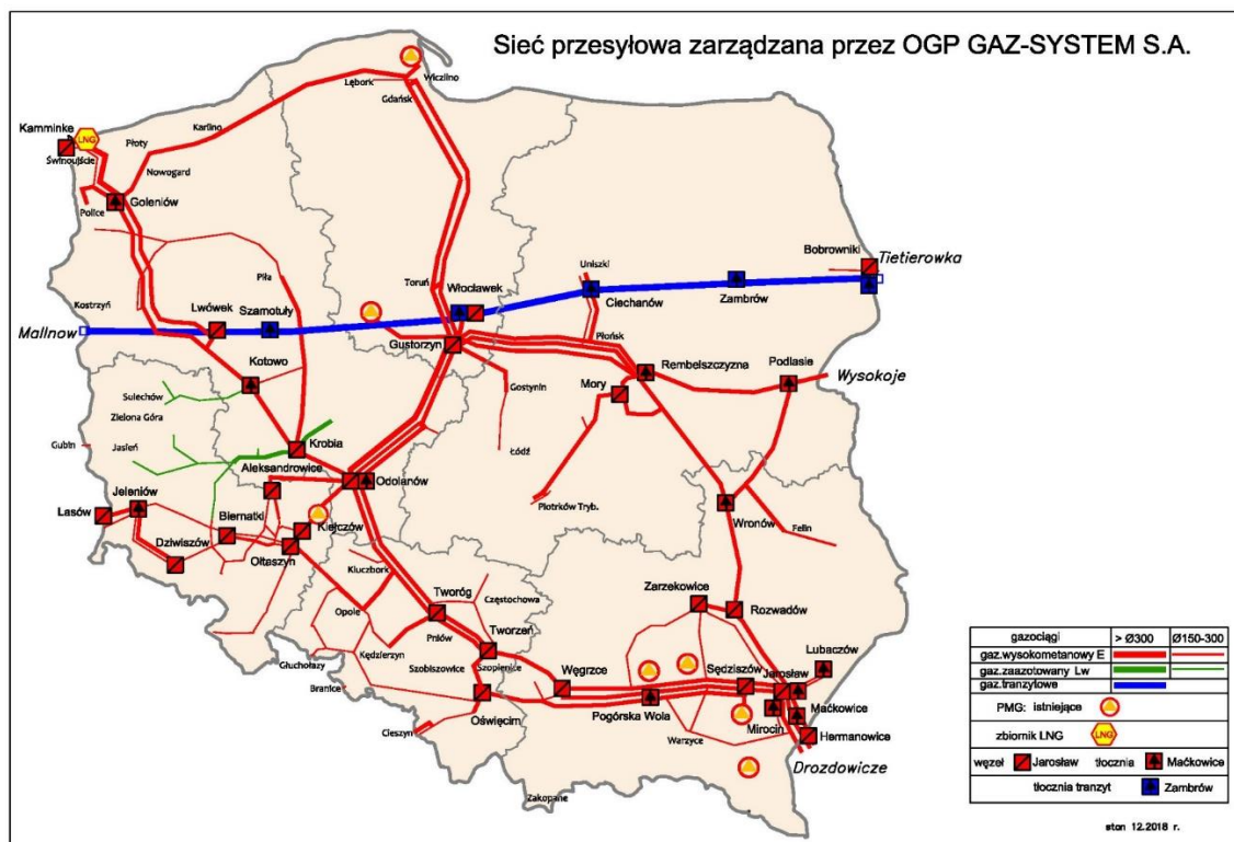
Rysunek 2. System przesyłowy gazu ziemnego
