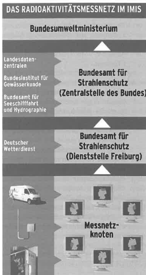
Schemat sieci pomiaru promieniotwórczości z przepływem danych
