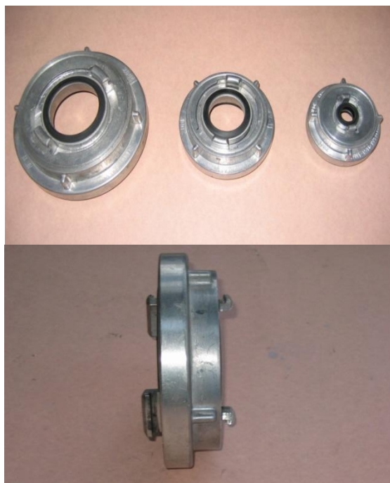
Fotografia nr 5.7. Przełączniki 52/25, 75/52, 110/75
