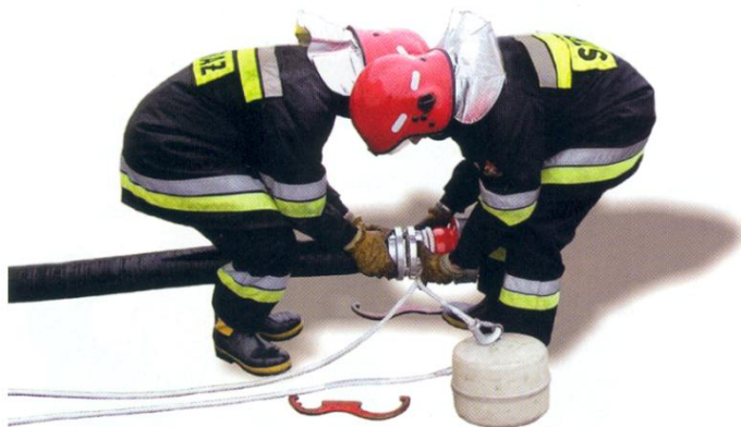
Fotografia nr 9.13. Łączenie smoka z węzem ssawnym 112
