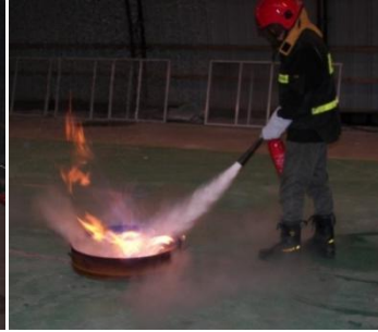
Fotografia nr 3.35. Gaszenie cieczy palnej gaśnicą śniegową
