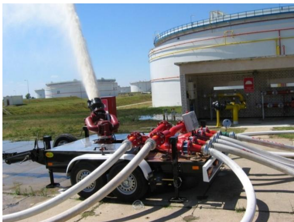
Fotografia nr 10.1. Działko wodno-pianowe przewoźne zamontowane na przyczepie
