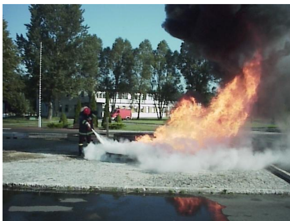
Fotografia nr 3.33. Gaszenie cieczy palnej gaśnicą proszkową
