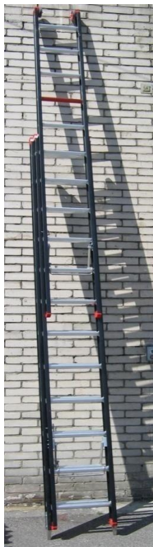
Fotografia nr 4.15 Drabina nasadkowa-wysuwana trzyprzęsłowa typ DNW 3080
