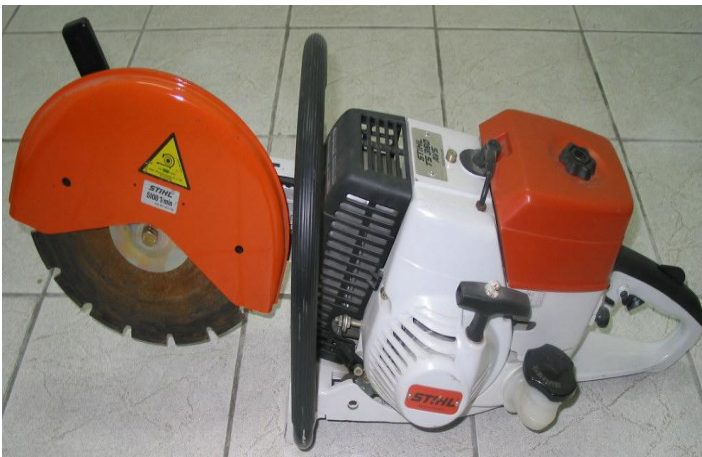
Fotografia nr 3.7. Pila tarczowa z tarczą z węglików spiekanych 38
