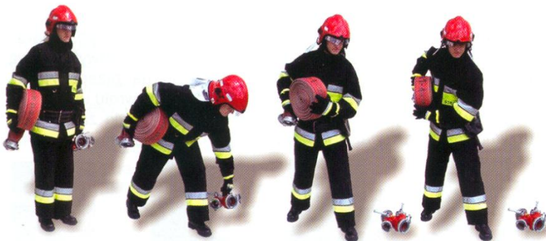
Fotografia nr 9.4. Początkowe fazy sprawiania rozdzielacza 100
