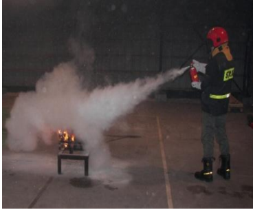
Fotografia nr 3.34. Gaszenie drewna gaśnicą proszkową
