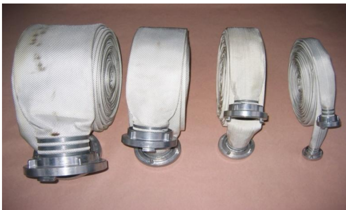
Fotografia nr 5.1. Wężę tłoczne: 110, 75, 52, 25
