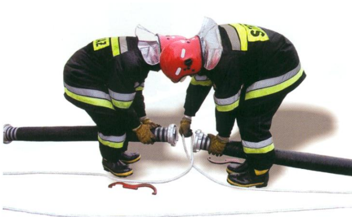
Fotografia nr 9.14. Zabezpieczenie węża pętlą z liny 113
