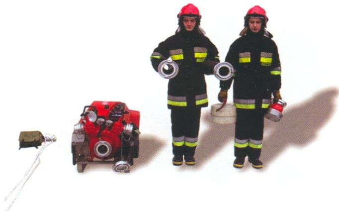
Fotografia nr 9.11. Przenoszenie armatury wodnej do sprawiania linii ssawnej 110
