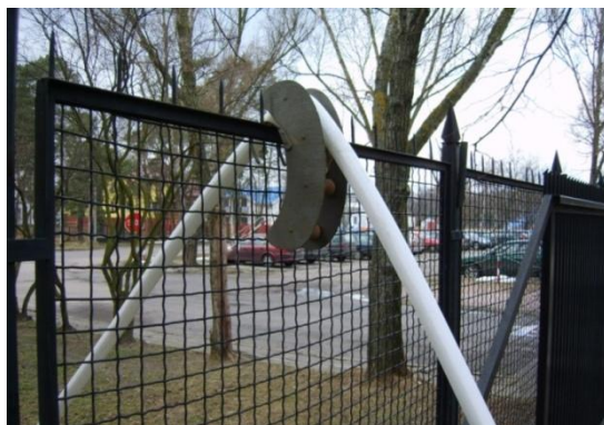
Fotografia nr 9.2. Linia węzowa prowadzona przez przeszkody (parkan)
