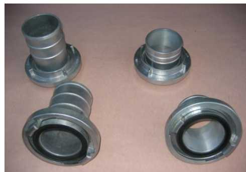
Fotografia nr 5.6. Łączniki: po lewej - ssawny 110, po prawej - tłoczny 110
