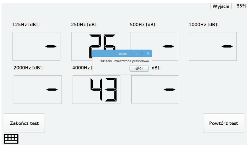
Rys. 13. Okno testera z wynikiem sprawdzenia w przypadku prawidłowo umieszczonej wkładki
