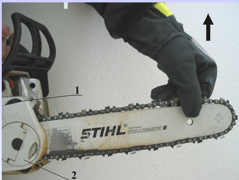
Prawidłowe napięcie łańcucha.
