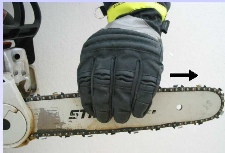
Sprawdzanie płynności ruchu łańcucha tnącego.
