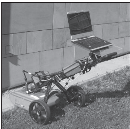
Fig. 4.2. Przykład georadaru (Rajchel, 2011)
