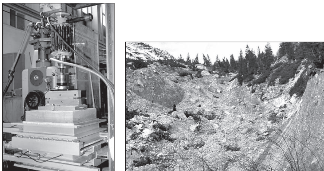
Fig. 5.6. Wielkoskalowy aparat bezpośredniego ścinania podczas badania oraz osuwisko Stože (Lenart, Bizjak, 2010)
