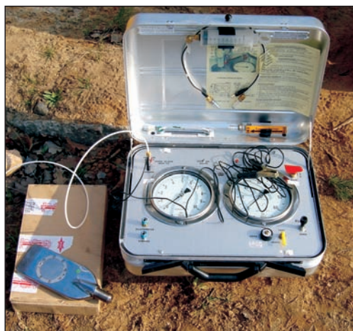
Fig. 4.13. Łopatką dylatometryczną wraz z urządzeniem pomiarowym do badań dylatometrem płaskim (Marchettięgo)
