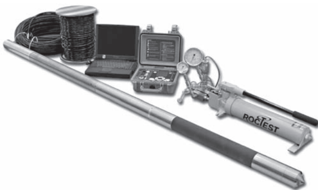
Fig. 4.16. Cylindryczny dylatometr sprężysty FDT ( www.roctest-group.com )
