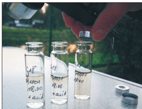
Fig. 7.10. Buteleczki typu headspace przed zamknięciem teflonowym kapturkiem i włożeniem do sondy systemu Westbay MP® mogą być częściowo napełnione odczynnikami konserwującym. Potem już bez otwierania trafią wprost do analizatora w laboratorium
