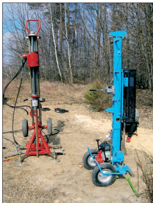
Fig. 4.8. Sondy dynamiczne DPH i DPSH
