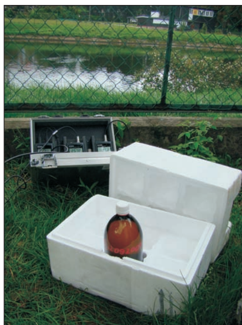
Fig. 7.16. Specjalne pojemniki na butelki laboratoryjne gwarantują dobre zabezpieczenie antywstrząsowe i termiczne próbek w czasie transportu
