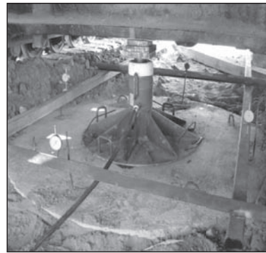
Fig. 4.19. Próbne obciążenie płytą PLT (PN-B-04452:2002; Godlewski, 2009)
