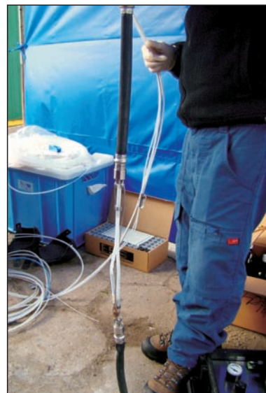
Fig. 7.6. Podwójny paker gumowy napełniany sprężonym gazem wraz z minipompą MPP, dostosowaną do 1-calowego otworu badawczego
