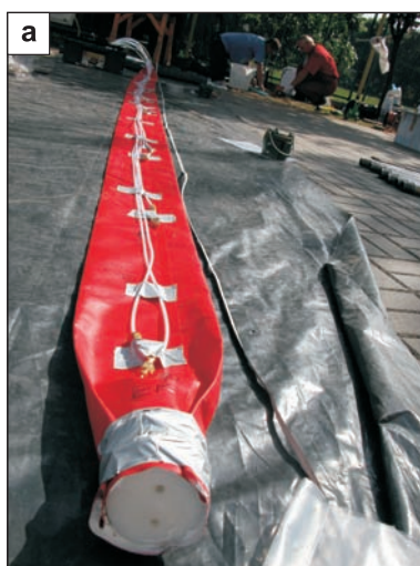
Fig. 7.11. a – Paker liniowy wraz minipompami przygotowywany do montażu w otworze badawczym; b – Faza montażu pakera liniowego z zamocowanymi minipompami oraz próbnikami pasywnymi w otworze badawczym 5 cali nad Brdą. Projekt PROMOTE Bydgoszcz (Irmiński, Wróblewska, 2008)
