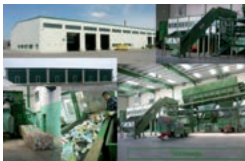
Nowoczesna sortownia z trzema liniami: odpadów zmieszanych, tworzyw sztucznych i stłuczki szklanej o wydajności 40 tys. Mg/rok, uruchomiona w 2002 r. (zdj. z archiwum MZGOK październik 2002 r.)
