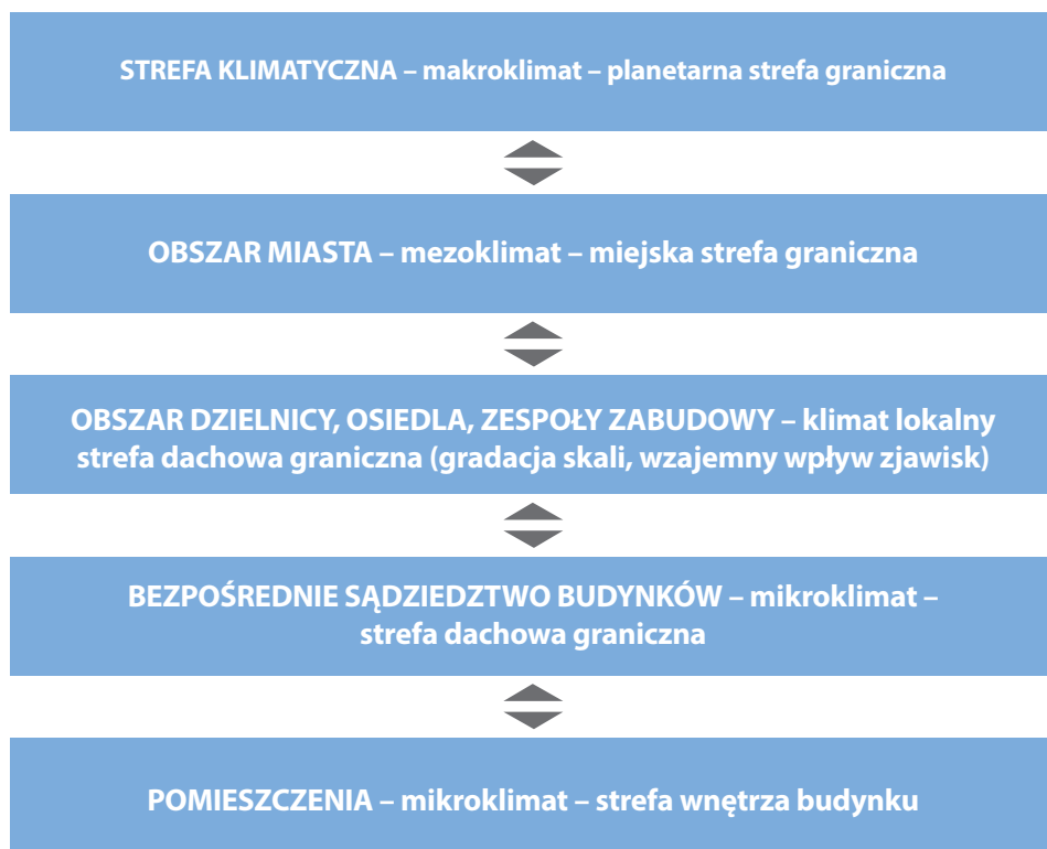
Rysunek 26. Skale urbanistyczne oraz ich wzajemne oddziaływanie Źródło: opracowanie własne KAPE S.A. na podstawie Zielonko-Jung 2013
