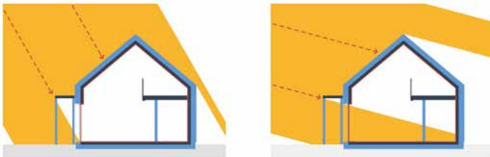
Rysunek 33. Podstawowe zasady projektowania budynków energooszczędnych – otoczenie bryły budynku od zewnątrz nieprzerwanie warstwą izolacji termicznej, wykonanie szczelnej warstwy powietrznej od wewnątrz oraz wykorzystanie energii promieniowania słonecznego. Po lewej budynek w lecie – zewnętrzne zadaszenie przeciwdziała przegrzewaniu budynku, po prawej – kształt zadaszenia umożliwia przedostawanie się promieni słonecznych zimą Autor: M. Pierzchalski
