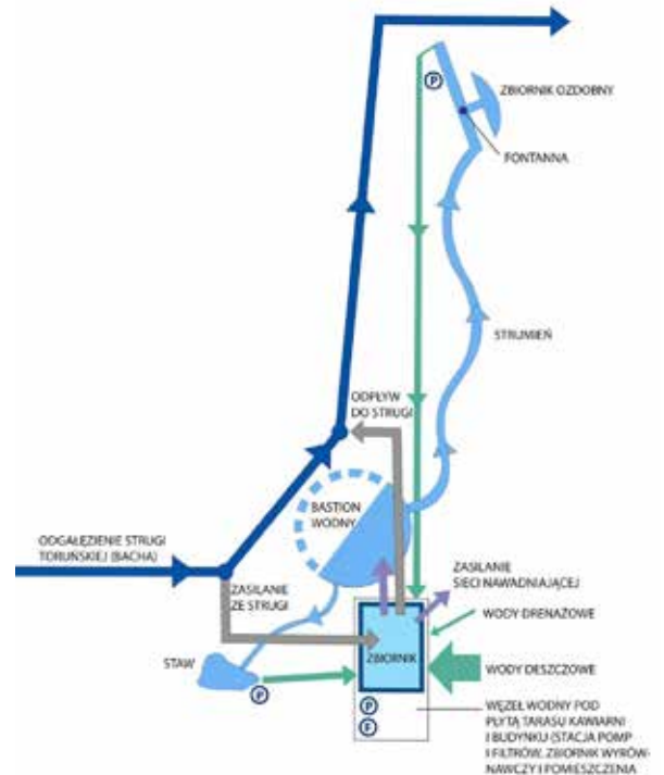
Rysunek 24. Projekt systemu wodnego w projekcie konkursowym parku Jordanki, Toruń. Autor: SOL-AR Pracownia Architektury i Urbanistyki
