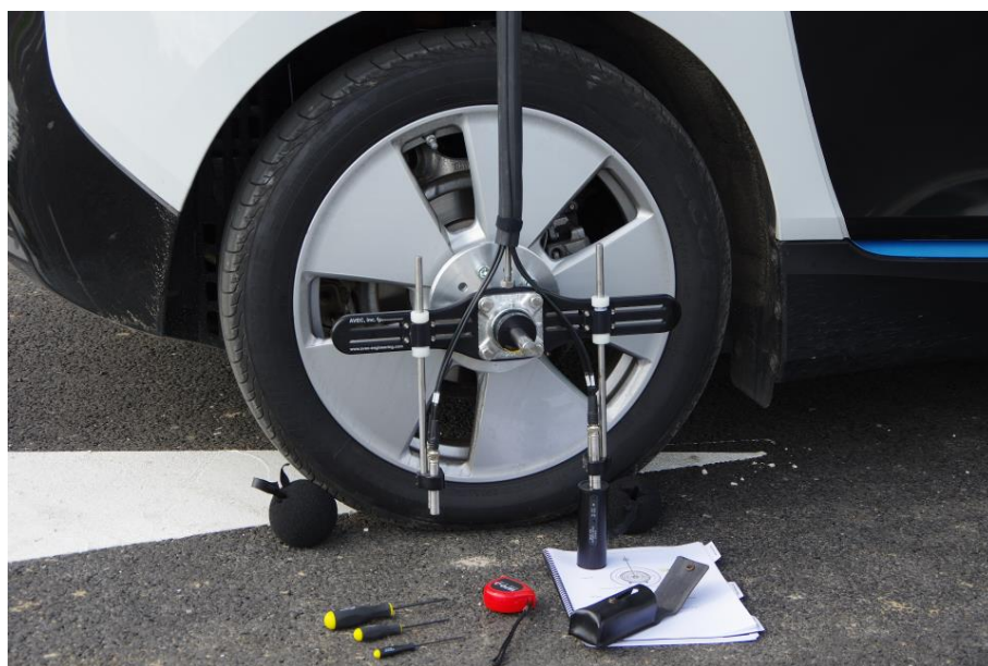
Rys A4.2 Sondy bez osłony przeciwwietrznej podczas procesu kalibracji (opona inna niż SRTT)
