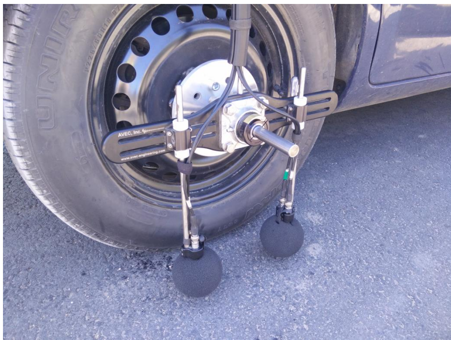
Rys A4.3 System OBSI zamontowany na piaście koła z dwoma miernikami natężenia i osłonami przeciw-wietrznymi (opona SRTT).
