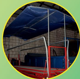
Zamontowanie osłony przeciwsłonecznej i przeciwdeszczowej w platformie do zbierania owoców.
