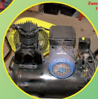
Zabezpieczenie ruchomych elementów maszyn w osłony.
