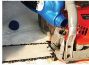
Właściwe smarowanie łańcucha łańcuchowego oraz smarowanie odpowiedniego oleju i paliwa zwiększają bezpieczeństwo pracy piłarką.
