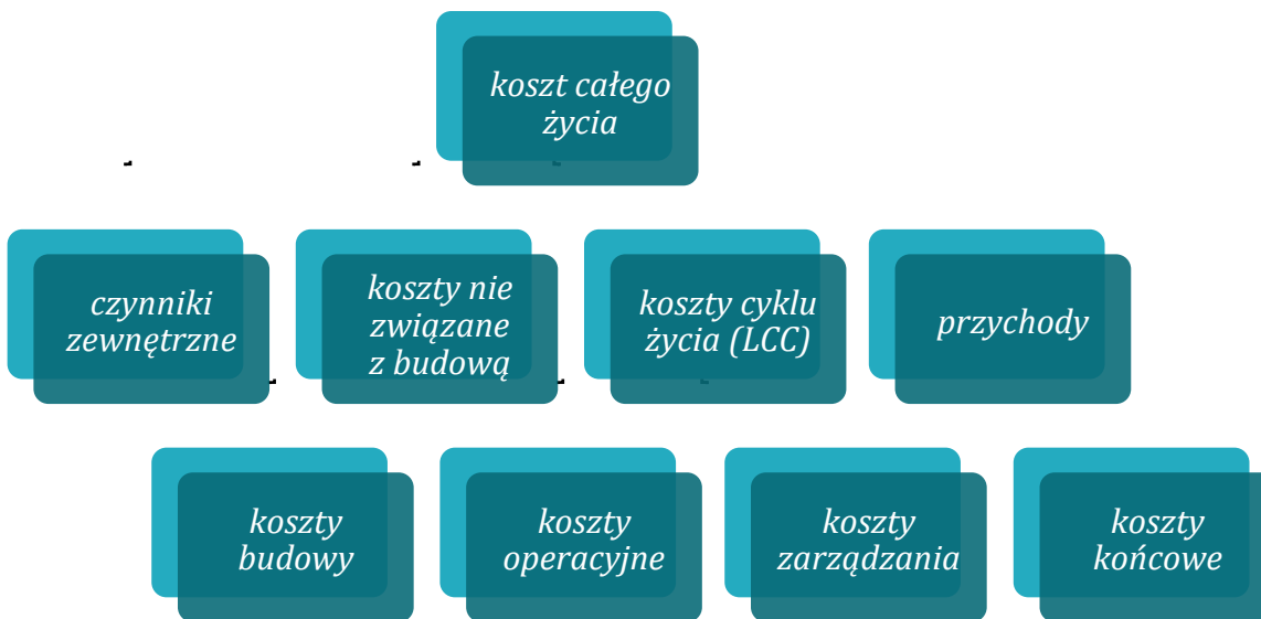
Grafika 5 Elementy WLC i LCC wg. ISO 15686-5:2017 (ISO 15686-5:2017, rys. 2, s. 7) - tłumaczenie
