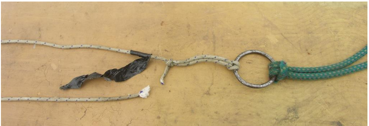
Fot. 2 Zerwana linka uzdy. Widok po częściowym zdjęciu czarnej taśmy.
