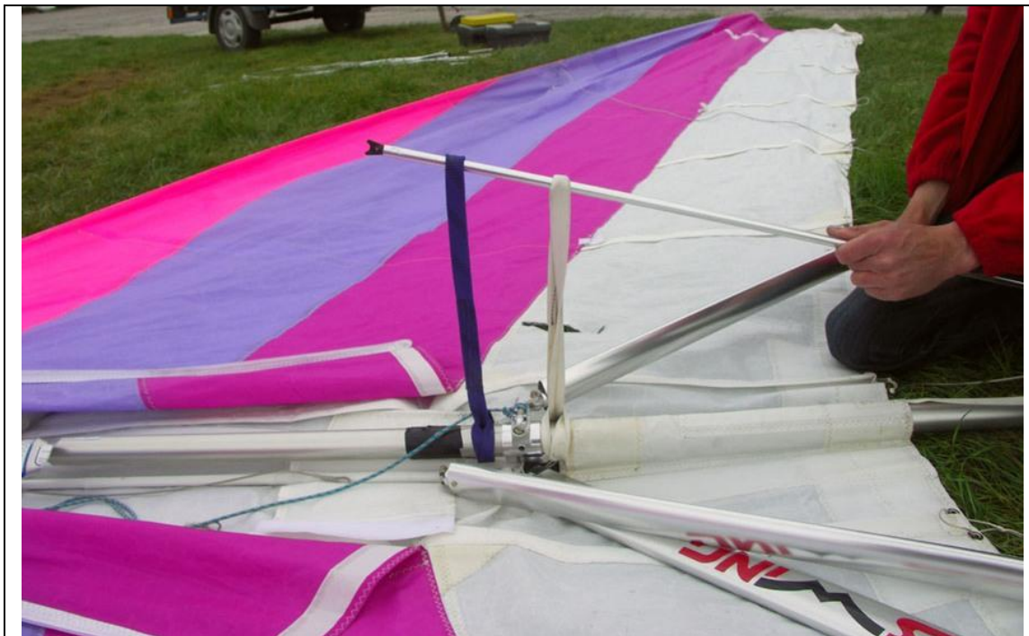
Fot.1 Widok węzła podwieszenia pilota do skrzydła lotni. (Taśma podwieszenia - ciemna)
