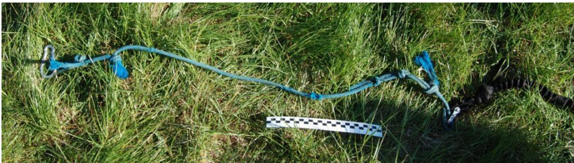
Fot.4 Widok linki stanowiącej część holu, pomiędzy linką stalową, a spadochronikiem hamującym.
