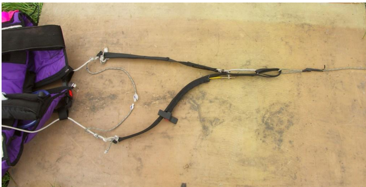
Fot. 3 Widok wycze pu przywiązanego do linek asekuracyjnych
