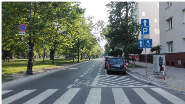
Fot.6.7. Pas ruchu dla rowerów na jezdni jednokierunkowej
