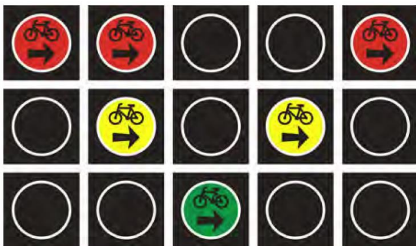
Rys. 3.16. Sygnalizatory kierunkowe S-3a dla kierujących rowerami do jazdy w prawo
