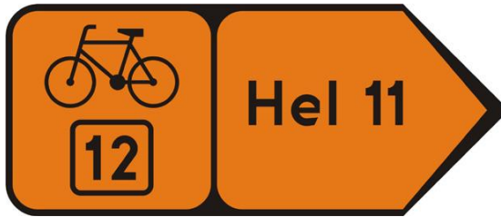
Rys. 3.31. Znak R-4d „drogowskaz szlaku rowerowego w kształcie strzały podający odległość”
