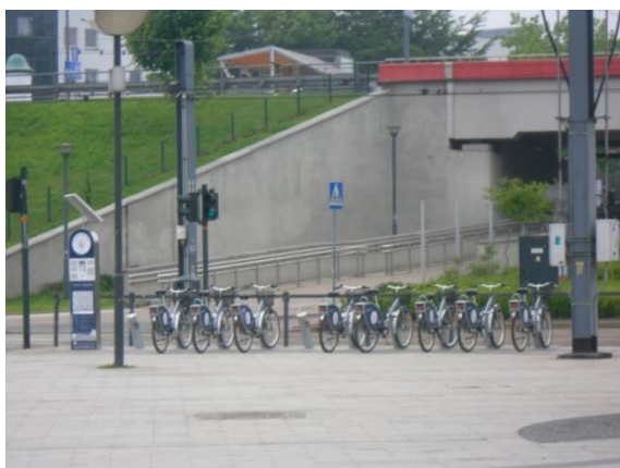
Fot. 6.47. Zalecane formy stojaków dla rowerów – strzemiona zapewniające możliwość ochrony ramy i koła roweru – parkowanie krótkookresowe
