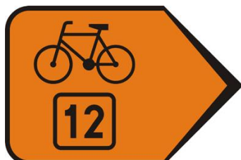
Rys. 3.29. Znak R-4b z informacją o zmianie kierunku szlaku rowerowego i jego numerze
