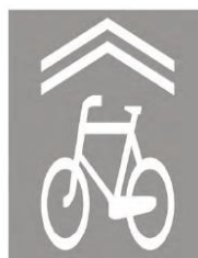
Rys. 6.17 Znak P-27 „kierunek i tor ruchu roweru”
