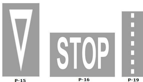
Rys. 3.11. Wzory znaków poziomych
