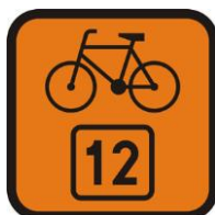
Rys. 3.25a. Przykład znaku R-4 z numerem szlaku rowerowego
