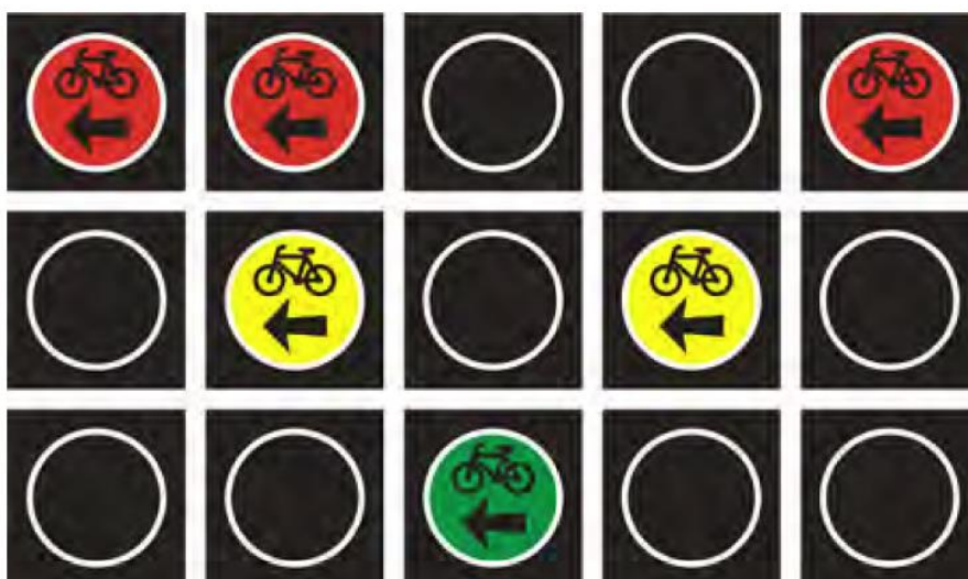
Rys. 3.15. Sygnalizatory kierunkowe S-3a dla kierujących rowerami skręcających w lewo
