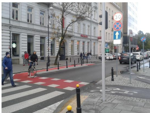
Fot. 6.11. Dwukierunkowy ruch rowerów na drodze jednokierunkowej, bez wyznaczonych na jezdni pasów (kontraruch) – wyjazd
