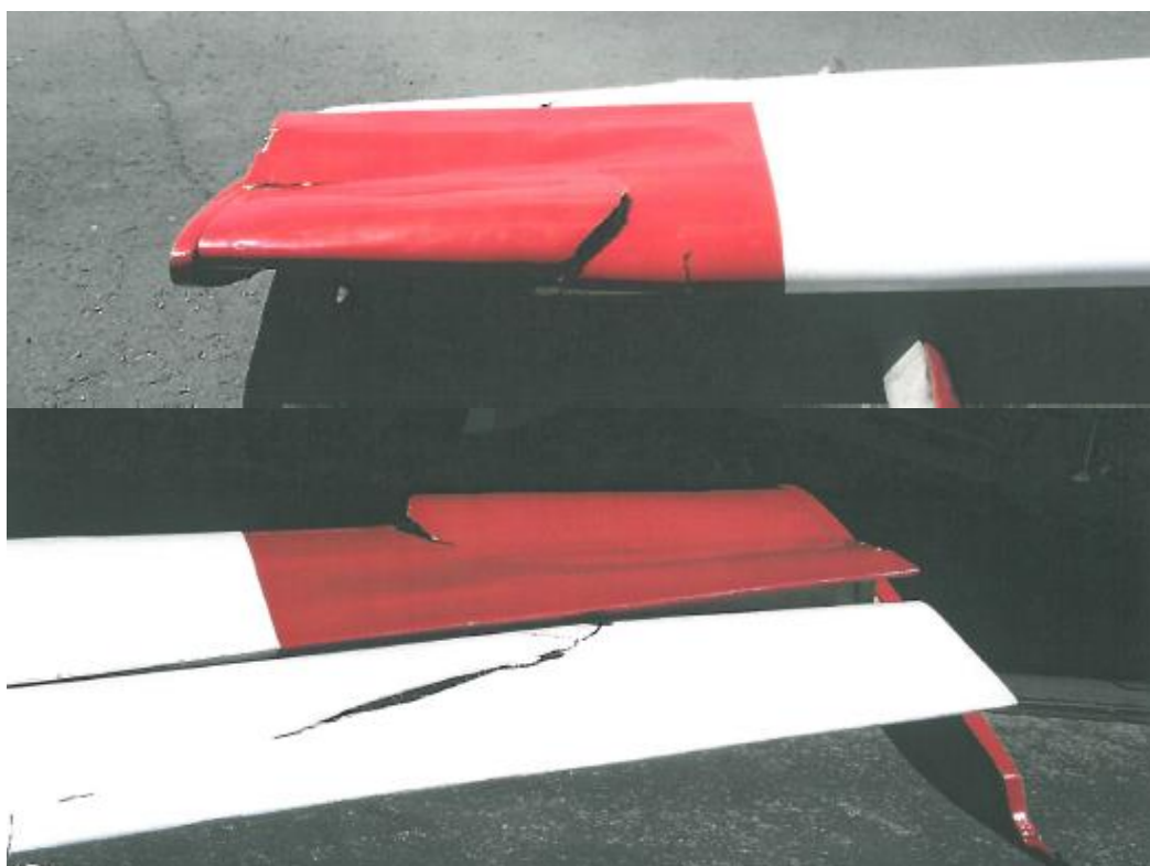
Fot. 1 Uszkodzenia końcówki skrzydła
