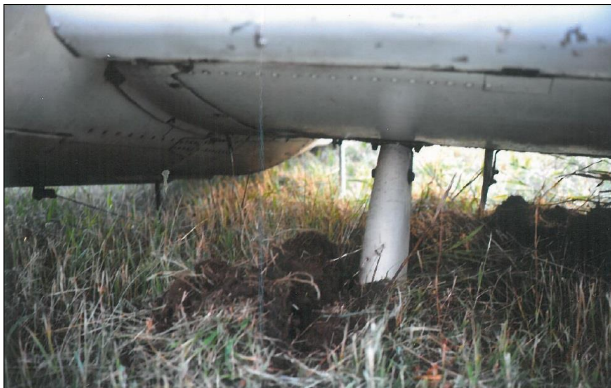
2 – Widok na lewe główne podwozie samolotu po wypadku.
