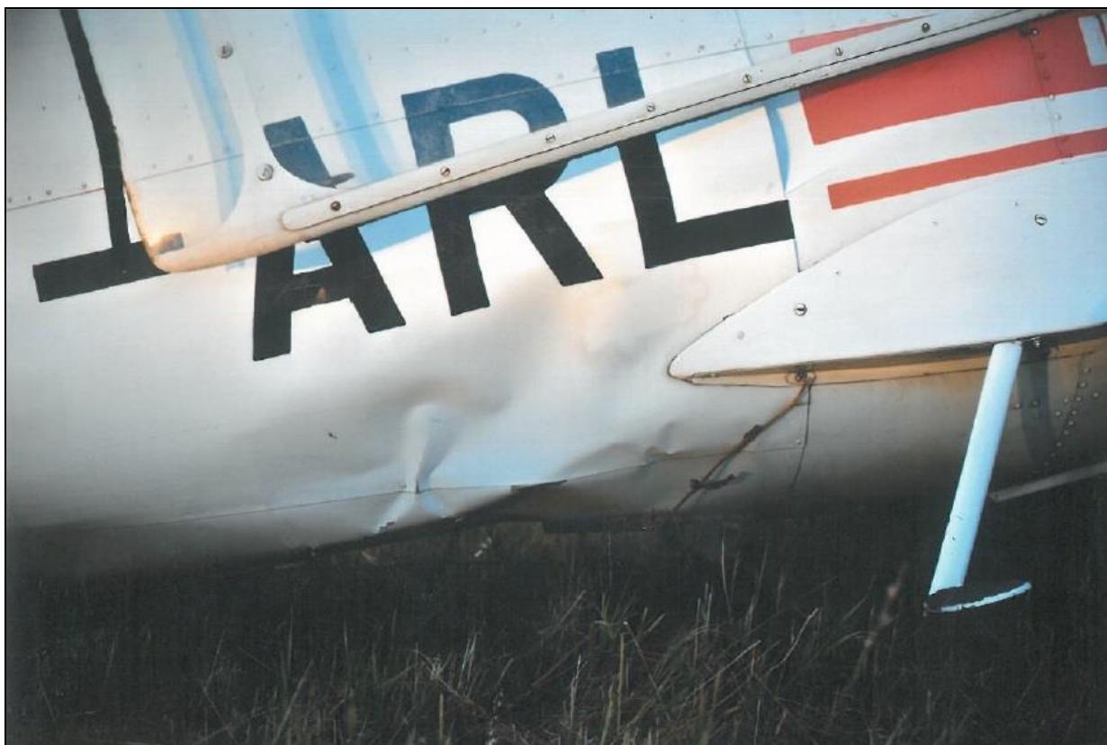
3 – Widok na uszkodzenia prawej strony i spodu kadłuba.
