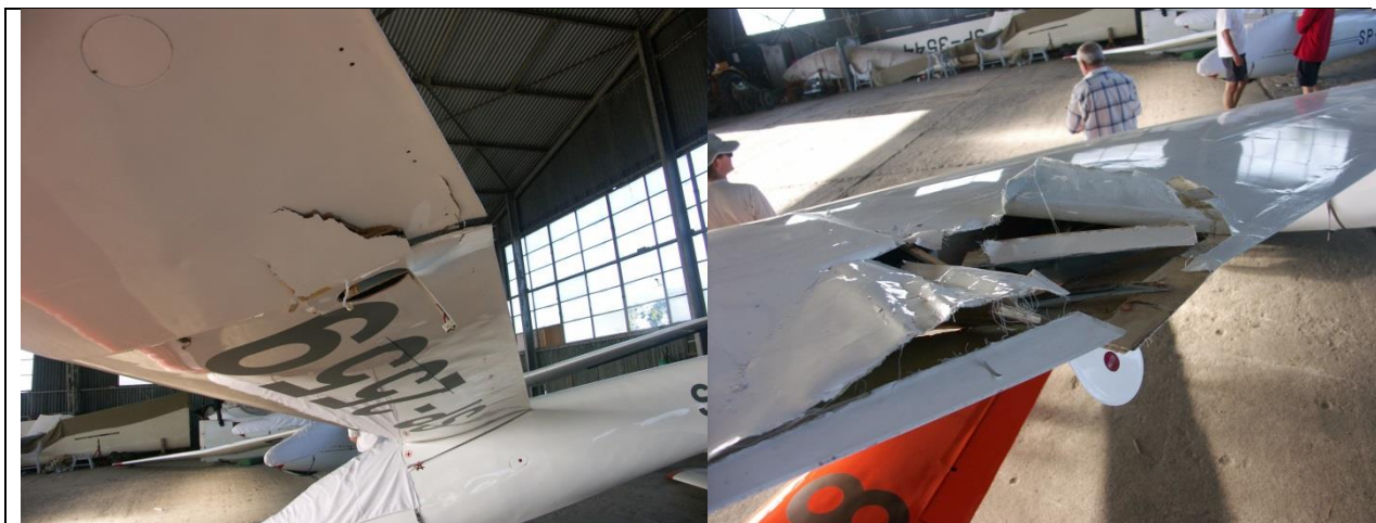
fot. 5 i 6 Uszkodzenia struktury końcówki oraz centroplata szybowca SP-2559
