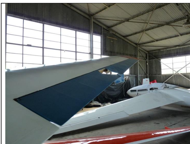
fot.1 Uszkodzenie lotki SP-2732
