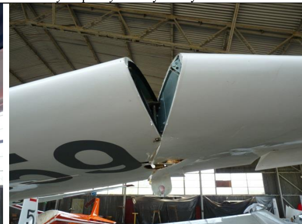
fot.4 Szybowiec SP-2559 uszkodzenie węzła mocowania końcówki prawego skrzydła
