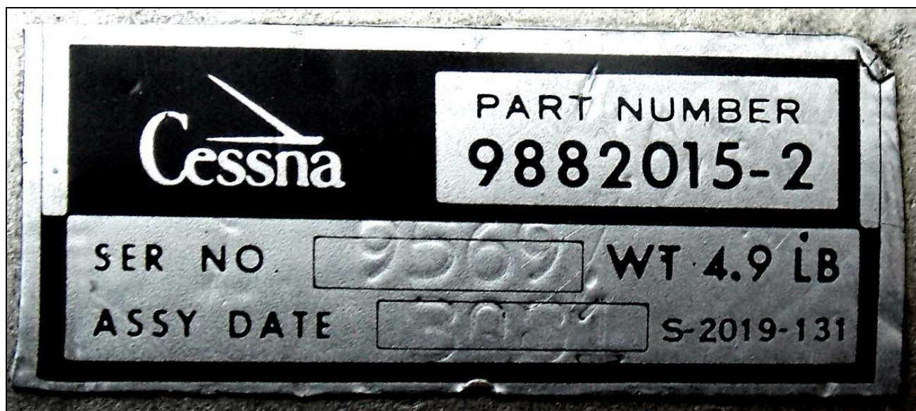
7 – Tabliczka identyfikacyjna siłownika hydraulicznego P/N 9882015-2, zdemontowanego po incydencie z samolotu Cessna 172RG SP-OMD.
