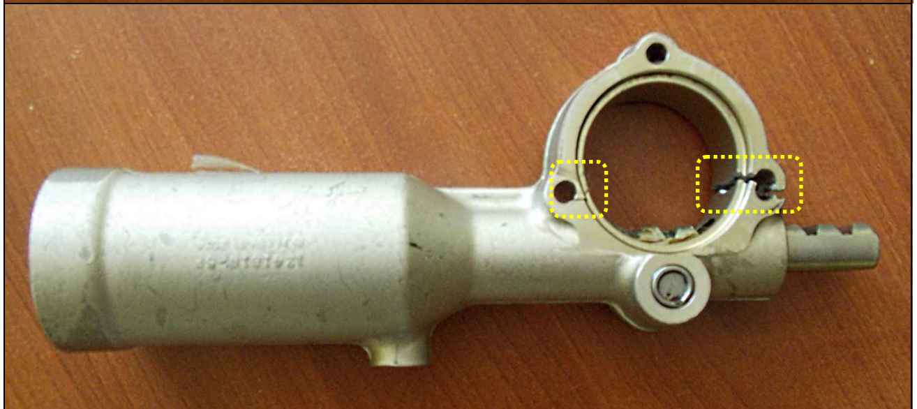
2, 3, 4 – Hydrauliczny siłownik chowania i wypuszczania podwozia głównego P/N 9882015-2 samolotu Cessna 172RG. Na pierwszym zdjęciu siłownik nieuszkodzony, na dwóch kolejnych zdemontowany z samolotu SP-OMD. Zaznaczone główne uszkodzenia.
