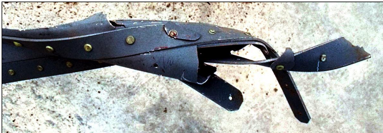
57 – Urwana i ukrzywiona końcówka dźwigara prawego skrzydła.
