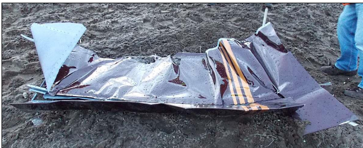
29 – Fragment pokrycia kesonu prawego skrzydła ze zbiornikami paliwa i klapą [C], widoczny od tyłu i od spodu.
