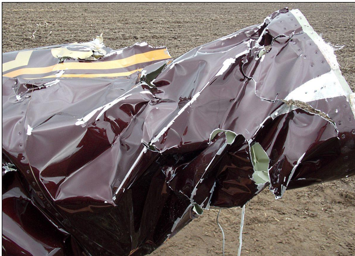
23 – Zbliżenie fragmentu tylnej części kadłuba z wyraźnymi objawami zniszczenia przez skręcanie „w prawo”.
