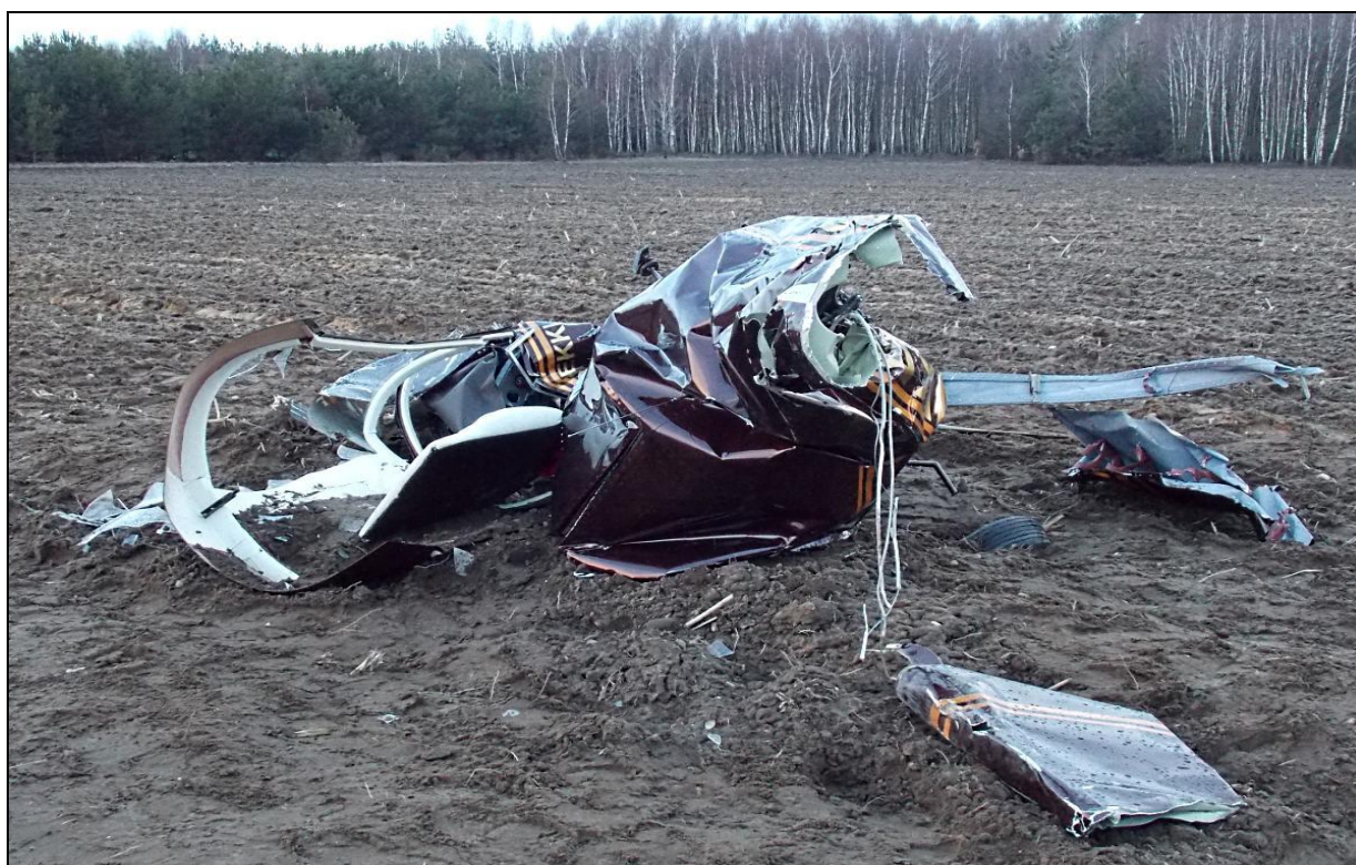
18 – Przednia część kadłuba z kabiną i zespołem napędowym [B] po upadku na lewy bok, widoczna od tyłu. Z prawej strony kadru widoczny dźwigar prawego skrzydła, całkowicie odarty z konstrukcji kesonu płata, zgięty przy kadłubie do dołu i ukręcony na końcu; przed nim fragment dolnego pokrycia kadłuba. Na pierwszym planie widoczna dolna część złamanego steru kierunku, nadal połączona z kadłubem linkami sterowania. Po lewej stronie kadru szkielet osłony kabiny ze zniszczonym oszkleniem.
