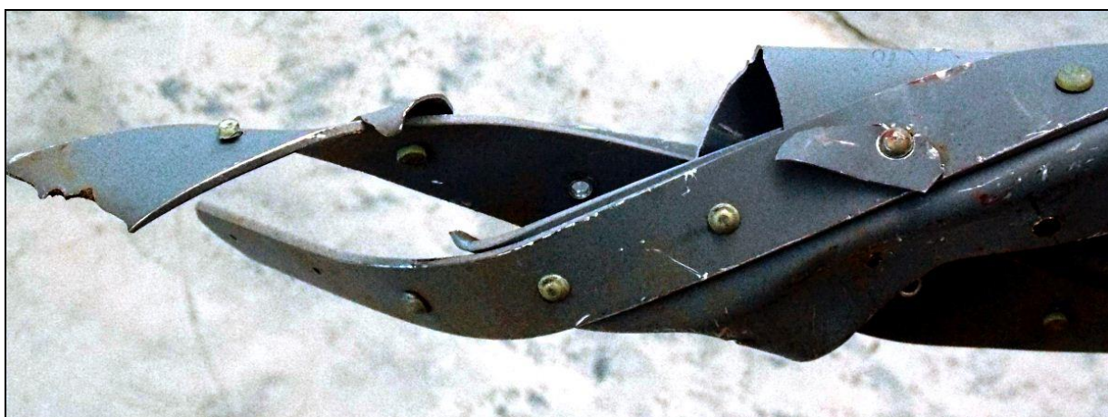
58 – Urwana i ukrzywiona końcówka dźwigara prawego skrzydła.
