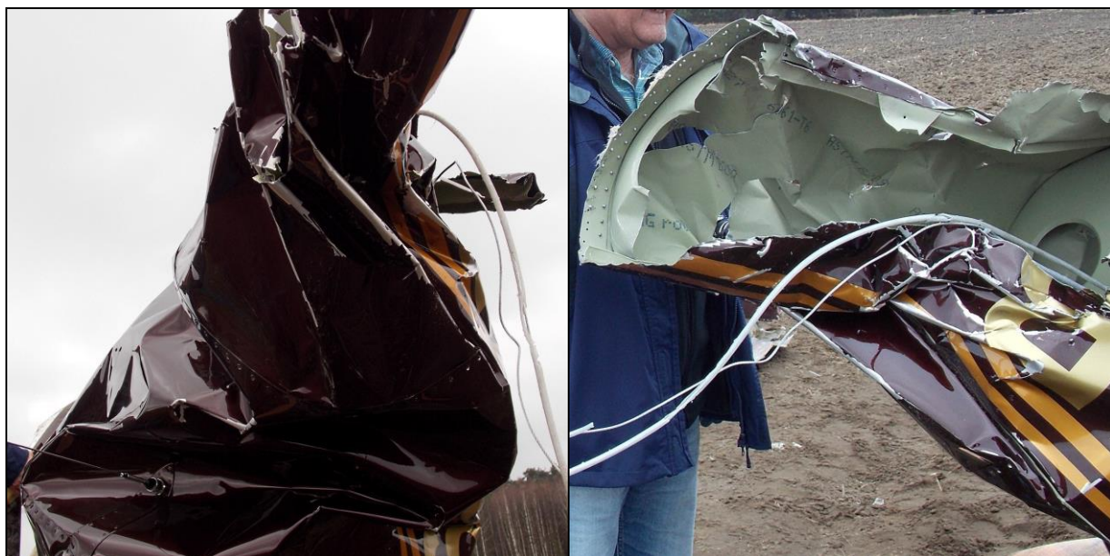
24, 25 – Zbliżenie fragmentu tylnej części kadłuba z wyraźnymi objawami zniszczenia przez skręcanie „w prawo” i jej widok od spodu.
