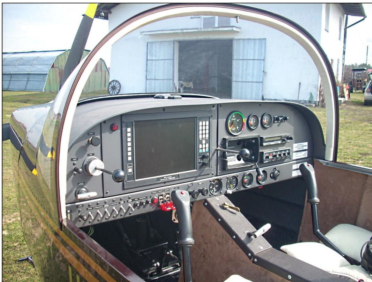
4 – Wnętrze kabiny samolotu SP-SWKB z tablicą przyrządów i sterownicami [foto: Krystyna Marszałek].
