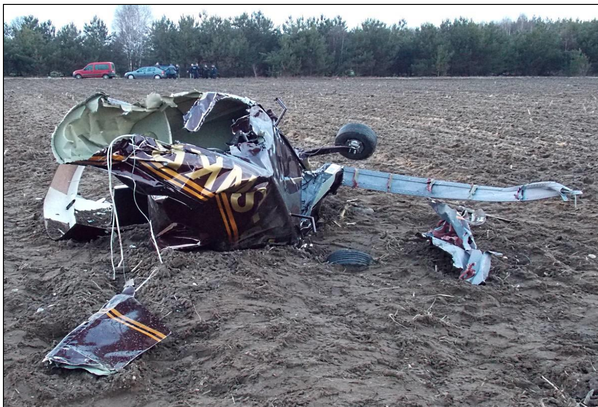
17 – Przednia część kadłuba z kabiną i zespołem napędowym [B] po upadku na lewy bok, widoczna od tyłu. Z prawej strony kadru widoczny dźwigar prawego skrzydła, całkowicie odarty z konstrukcji kesonu płata, zgięty przy kadłubie do dołu i ukręcony na końcu; przed nim fragment dolnego pokrycia kadłuba. Na pierwszym planie widoczna dolna część złamanego steru kierunku, nadal połączona z kadłubem linkami sterowania.
