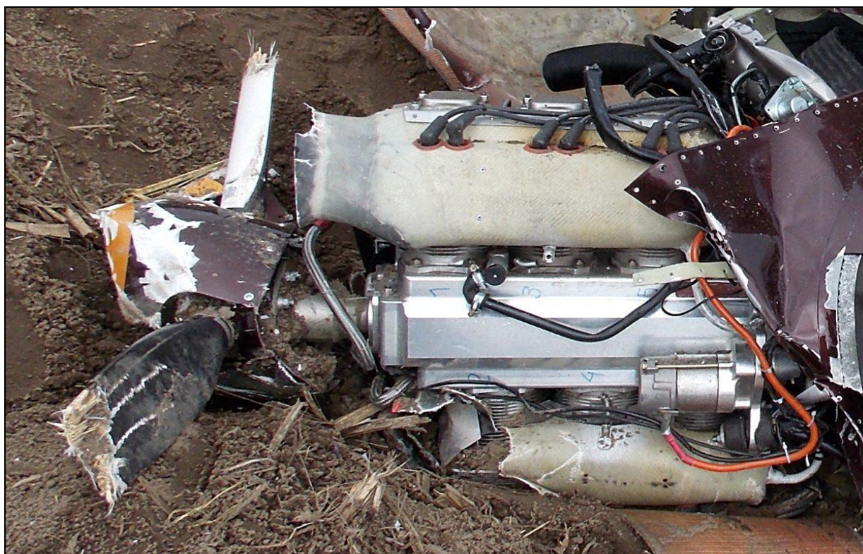
92 – Zespół napędowy ze zniszczonym śmigłem, widok od góry (zdjęcie na miejscu wypadku).
