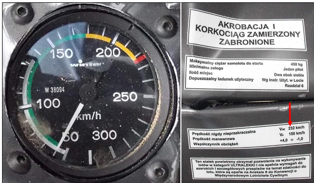
87, 88 – Skala prędkościomierza z prawidłowymi oznaczeniami zakresów prędkości lotu i tabliczki informacyjne w kabinie z błędem drukarskim wartości prędkości V NE .
