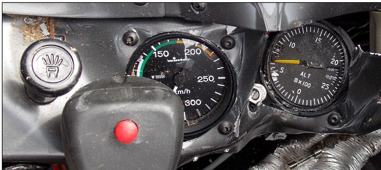
83 – Prędkościomierz i wysokościomierz, na pierwszym planie rękojeść prawego drążka sterowego.
