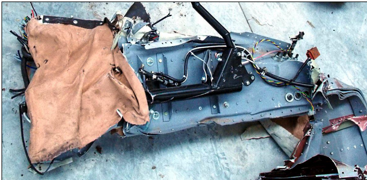
52 – Połączenie dźwigara prawego skrzydła z dźwigarem centroplata i miejsce zgięcia dźwigara prawego skrzydła. Dobrze widoczna konstrukcja pasa dźwigara z wielu nakładek. Przy dźwigarze centroplata widoczna łącząca drążki sterowe rura skrętna układu sterowania sterem wysokości z prawym drążkiem sterowym.
