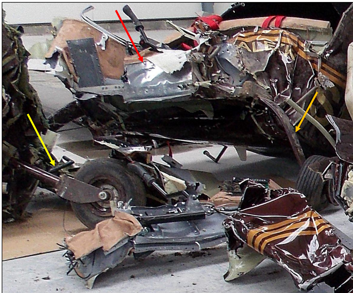
93 – Podwozie przednie (żółta strzałka) i lewe podwozie główne (pomarańczowa strzałka) w szczątkach samolotu. Strzałką czerwoną wskazany fragment dźwigara centroplata, który pozostał przy wrzędze kadłuba (zdjęcie na miejscu badania wraku).
