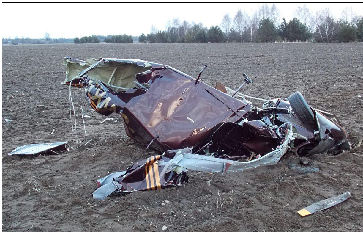
15 – Przednia część kadłuba z kabiną i zespołem napędowym [B] po upadku na lewy bok, widoczna od spodu. Na pierwszym planie jedna z łopat połamanego śmigła. Dobrze widoczny dźwigar prawego skrzydła, całkowicie odarty z konstrukcji kesonu płata, zgięty przy kadłubie do dołu i ukłębony na końcu, za nim fragment dolnego pokrycia kadłuba. Z lewej strony kadru widoczna dolna część złamanego steru kierunku, nadal połączona z kadłubem linkami sterowania.
