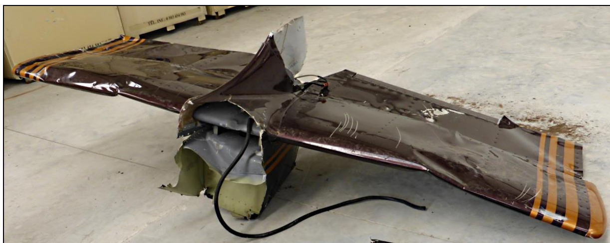
39 – Zniszczone usterzenie poziome (odnalezione pod koniec września 2013) – widok ogólny z góry od przodu.
