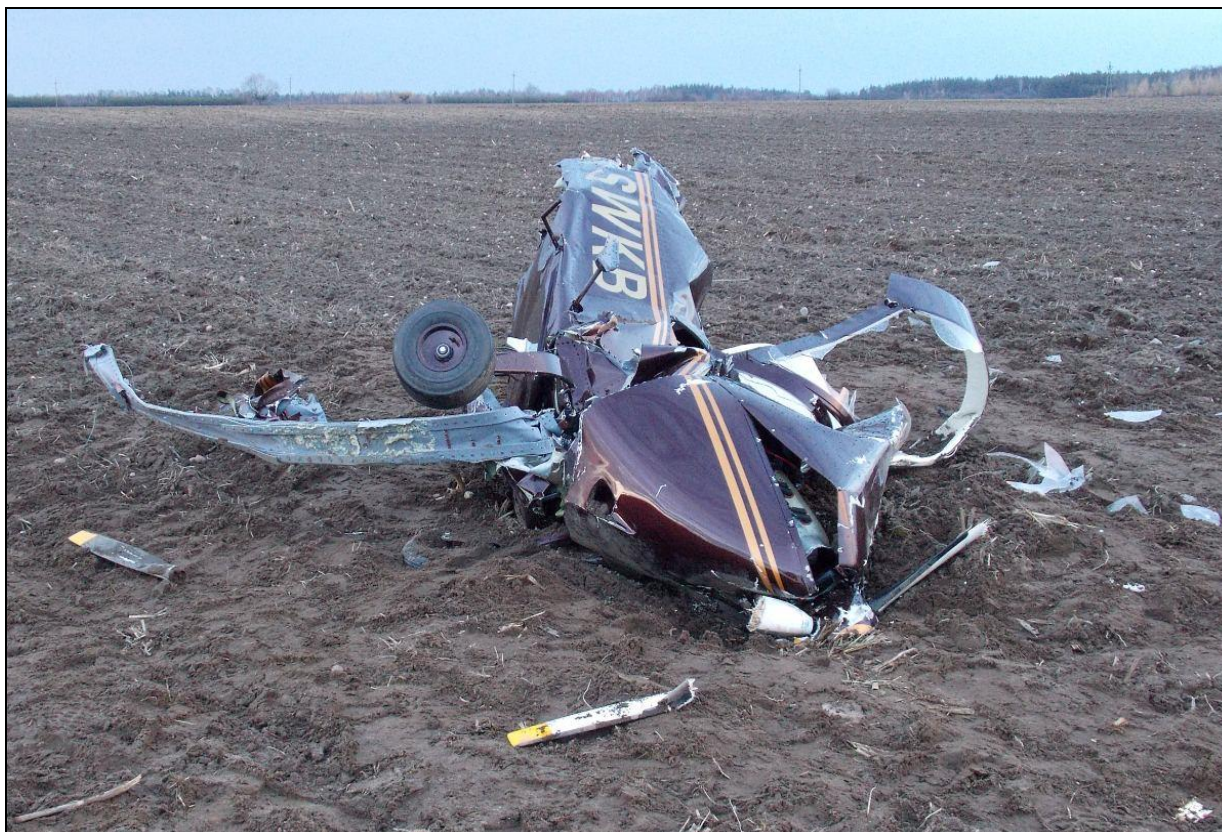
13 – Przednia część kadłuba z kabiną i zespołem napędowym [B] po upadku na lewy bok, widoczna od przodu. Na pierwszym planie połamane łopaty śmigła. Dobrze widoczny dźwigar prawego skrzydła, całkowicie odarty z konstrukcji kesonu płata, zgięty przy kadłubie do dołu i ukręcony na końcu.
