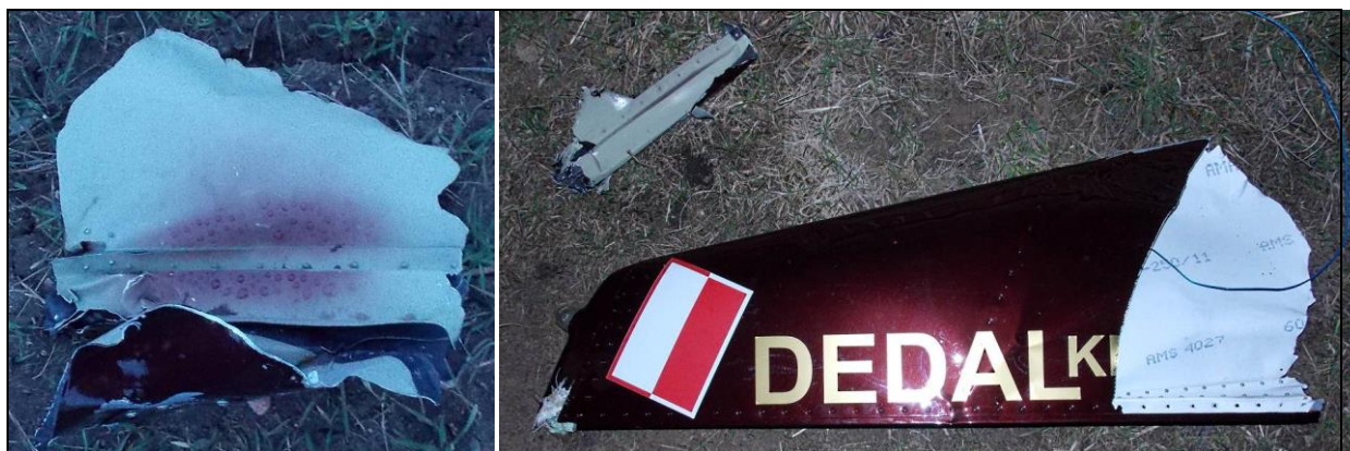
31 - Część kesonu prawego skrzydła z fragmentem tylnego dźwigarka [I]. 32 – Statecznik pionowy [J] – oderwany górny duży fragment.
