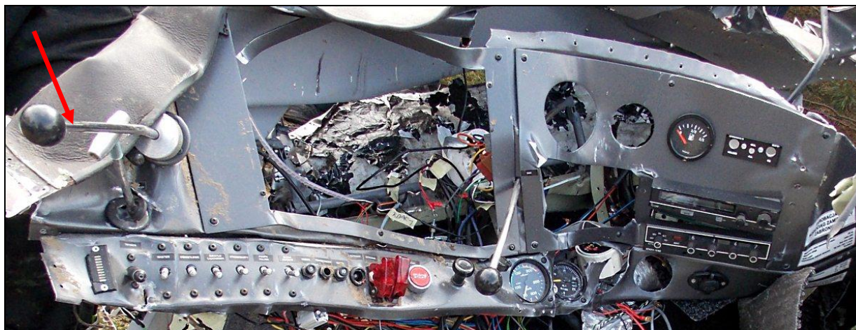
79 – Ogólny widok tablicy przyrządów. EFIS MGL Stratomaster Odyssey, obrotomierz i wskaźnik lewego paliwomierza - wymontowane. Strzałką wskazana zgięta lewa manetka obrotów silnika.
