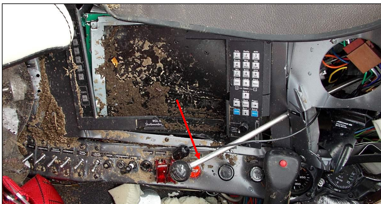
80 – Lewa strona tablicy przyrządów z EFIS MGL Stratomaster Odyssey. Strzałką wskazana prawa manetka obrotów silnika. Widoczna górna część rękojeści prawego drążka sterowego z czerwonym przyciskiem.
