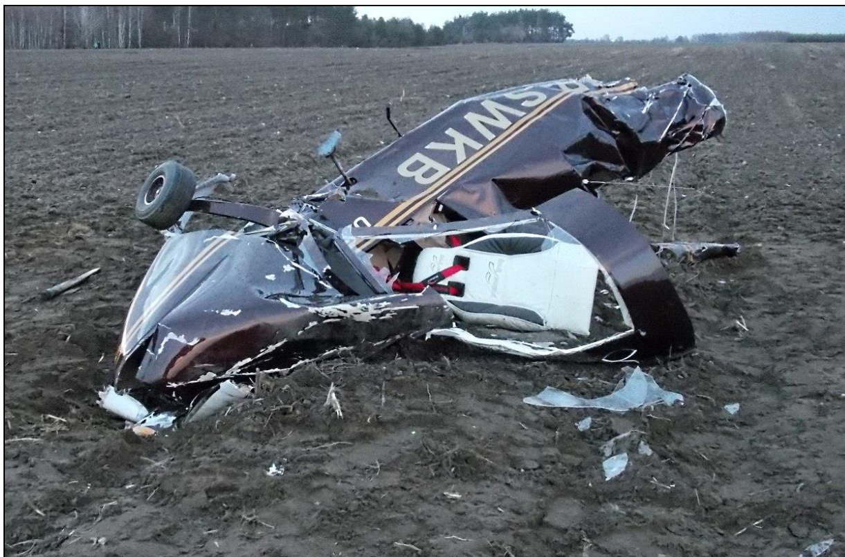
21 – Przednia część kadłuba z kabiną i zespołem napędowym [B] po upadku na lewy bok, widoczna strony grzbietu i od przodu. Widoczne odłamki prawej szyby oszklelenia i zniszczona rama osłony kabiny oraz zniszczone osłony silnika.
