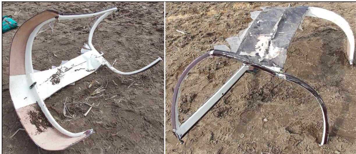
77, 78 – Rama osłony kabiny, pozbawiona oszkleńcia – z lewej strony od tyłu, z prawej od przodu.
