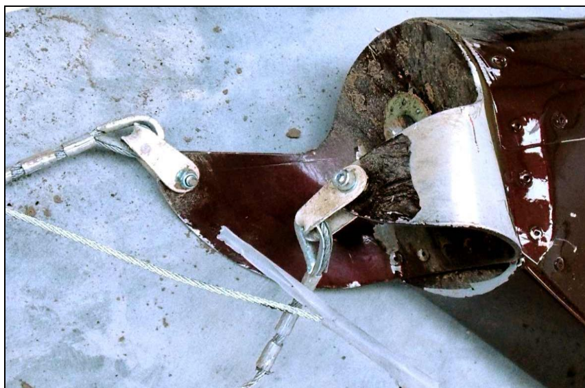
35 – Dolne zawieszenie steru kierunku z dźwignią napędu sterowania i linkami sterowymi.
