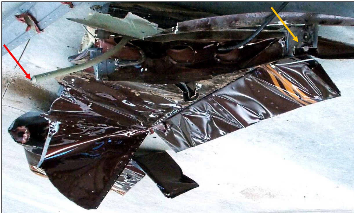
60 – Żebro nasadowe prawego skrzydła – w tle widoczna klapa. Strzałką pomarańczową wskazana wystająca poza żebro nasadowe ścianka tylnego dźwigarka z widocznymi otworami po śrubach mocujących tylny dźwigarek skrzydła do kadłuba, strzałką czerwoną – urwana końcówka popychacza sterowania lotką.
