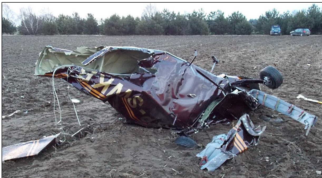
16 – Przednia część kadłuba z kabiną i zespołem napędowym [B] po upadku na lewy bok, widoczna od spodu i od tyłu. Z prawej strony kadru widoczny dźwigar prawego skrzydła, całkowicie odarty z konstrukcji kesonu płata, zgięty przy kadłubie do dołu i ukłębony na końcu; przed nim fragment dolnego pokrycia kadłuba. Z lewej strony kadru widoczna dolna część złamanego steru kierunku, nadal połączona z kadłubem linkami sterowania.
