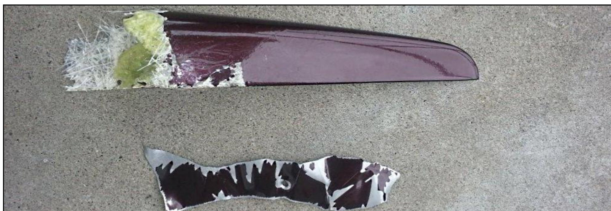
37 – Fragment końcówki i fragment pokrycia jednego z segmentów steru wysokości (odnalezione po 15.05.2013).
