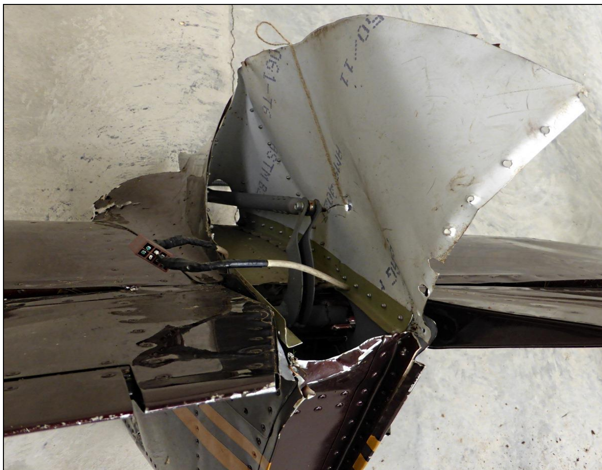
45 – Zniszczone usterzenie poziome, widok z góry od tyłu.
