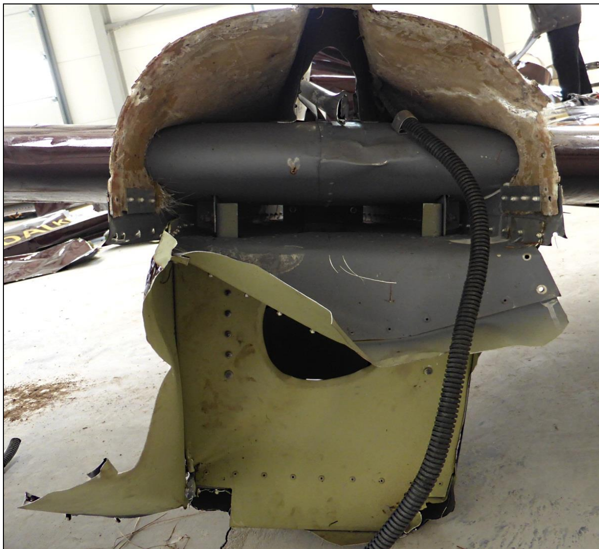
47 – Zniszczone usterzenie poziome (odnalezione pod koniec września 2013), wręga tylnej części kadłuba.
