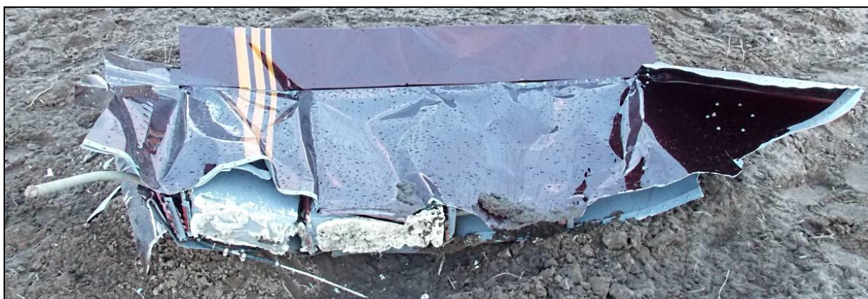
28 – Fragment pokrycia kesonu prawego skrzydła ze zbiornikami paliwa i klapą [C], widoczny od przodu i od spodu.
