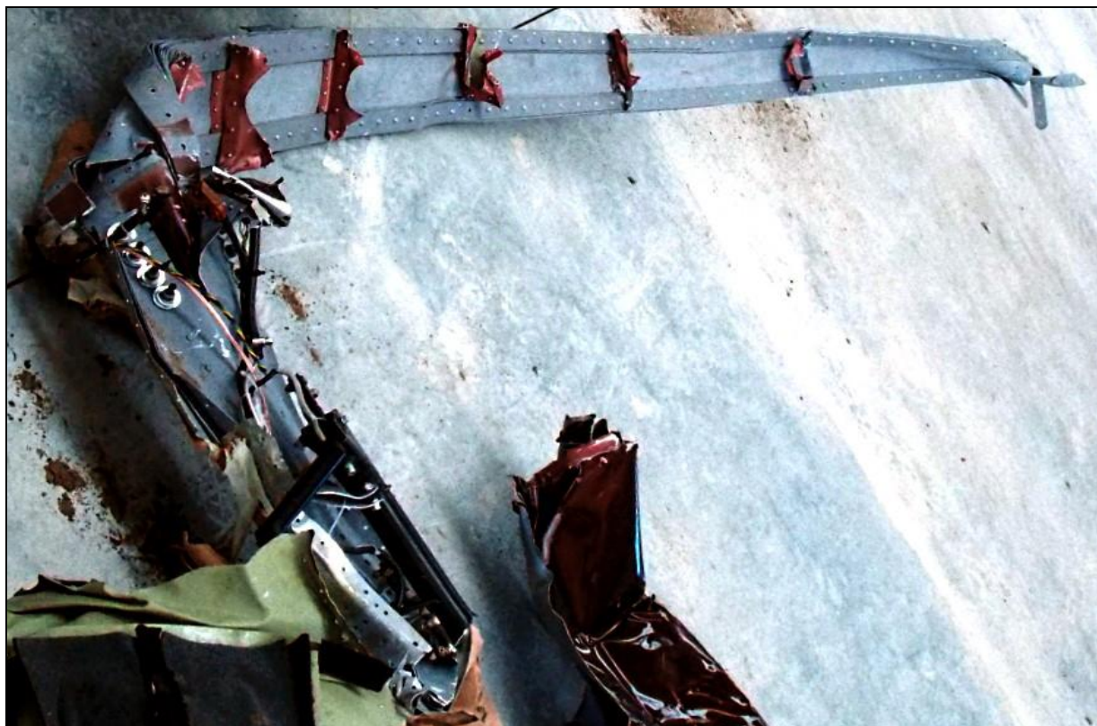
55 – Zgięty ku tyłowi dźwigar prawego skrzydła z resztkami żeber, połączone z fragmentem dźwigara centroplata.
