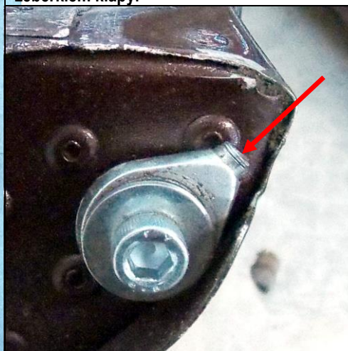
70 – Powyżej: wprowadzenie napędu sterowania prawą lotką na jej żeberku nasadowym, z widoczną urwaną końcówką popychacza sterowania (przełom końcówki wskazany strzałką).
