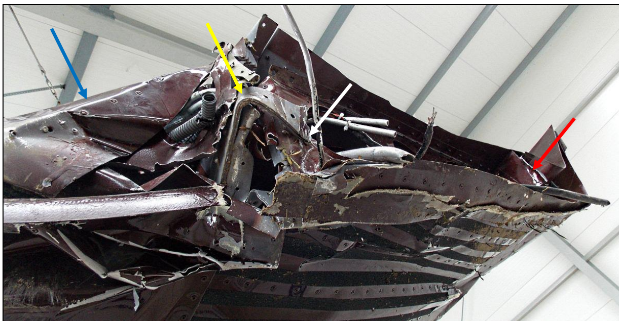
73 – Lewe skrzydło pokazane od spodu od strony żebra nasadowego. Niebieska strzałka pokazuje miejsce zderzenia skrzydła z ziemią, czerwona – miejsce urwania zewnętrznej części tylnego dźwigarka, strzałką żółtą i białą wskazane zgięte urwane fragmenty górnego pasa dźwigara lewego skrzydła, których sposób wygięcia i niszczenia świadczy o wyboczeniu górnego pasa dźwigara przy kadłubie siłą ściskającą.
