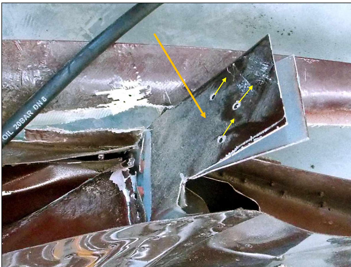
61 – Zbliżenie na ściankę tylnego dźwigarka prawego skrzydła przy żebrowie nasadowym. Żółtymi strzałkami zaznaczono kierunek działania sił, które ścięły śruby mocujące, określony na podstawie sposobu owalizacji otworów po nich.
