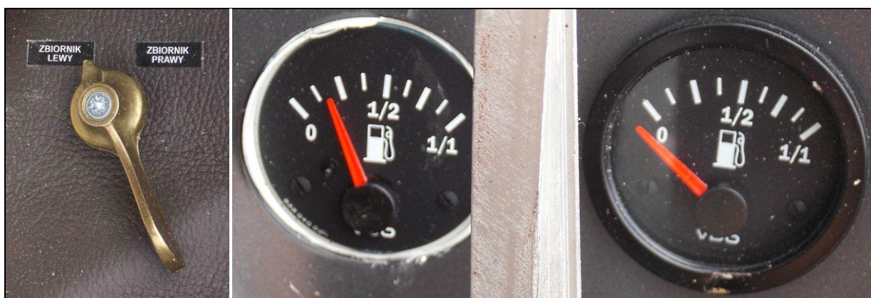
84 – Położenie zaworu głównego instalacji paliwowej.
