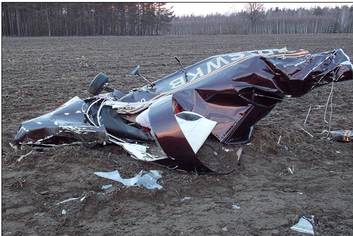
20 – Przednia część kadłuba z kabiną i zespołem napędowym [B] po upadku na lewy bok, widoczna strony grzbietu. Z prawej strony kadru widoczna dolna część złamanego steru kierunku, nadal połączona z kadłubem linkami sterowania. Widoczne odłamki prawej szyby oszklenia i zniszczona rama osłony kabiny.
