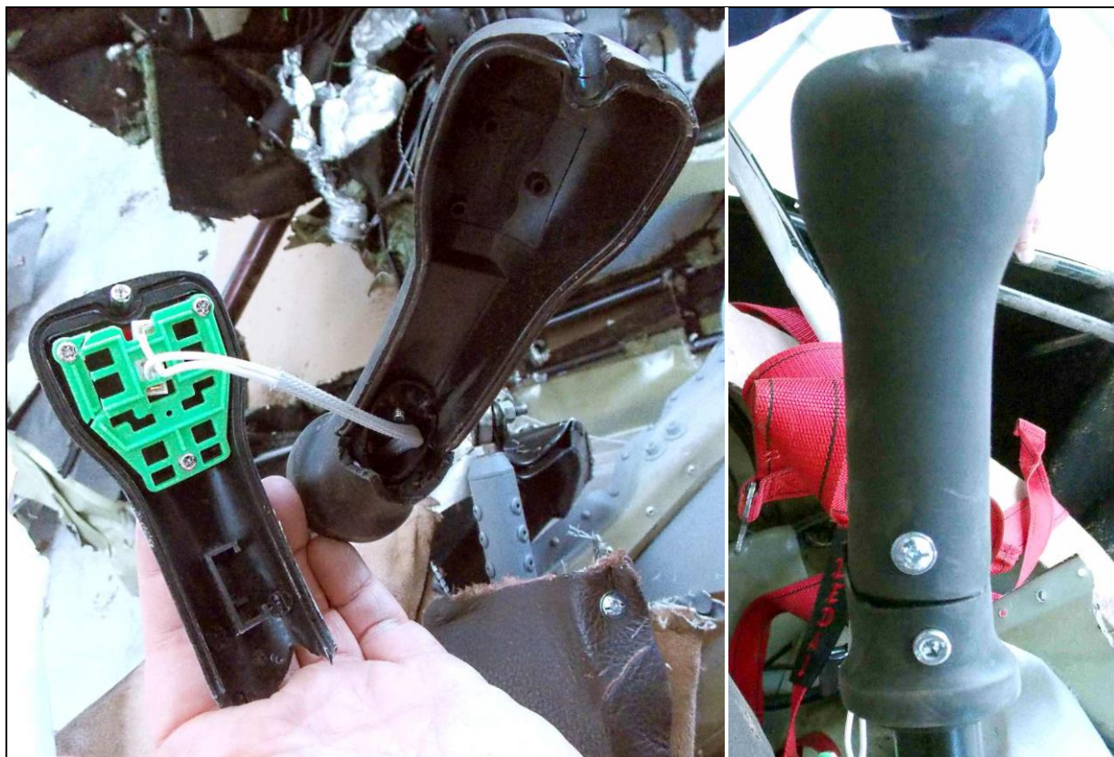
89, 90 – Zniszczone rękojeści lewego (z lewej, używanego przez pilota) i prawego (z prawej) drążków sterowych.
