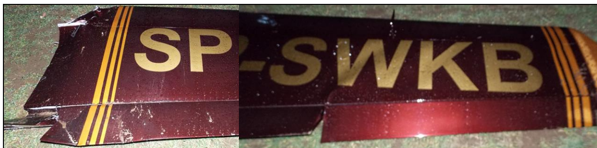
71, 72 – Odłamane lewe skrzydło [K], widoczne od spodu. Zwraca uwagę obraz uszkodzeń diametralnie różniący się od skrzydła prawego – lewe skrzydło pozostało praktycznie w całości. Zdjęcia wykonane na miejscu odnalezienia skrzydła.
