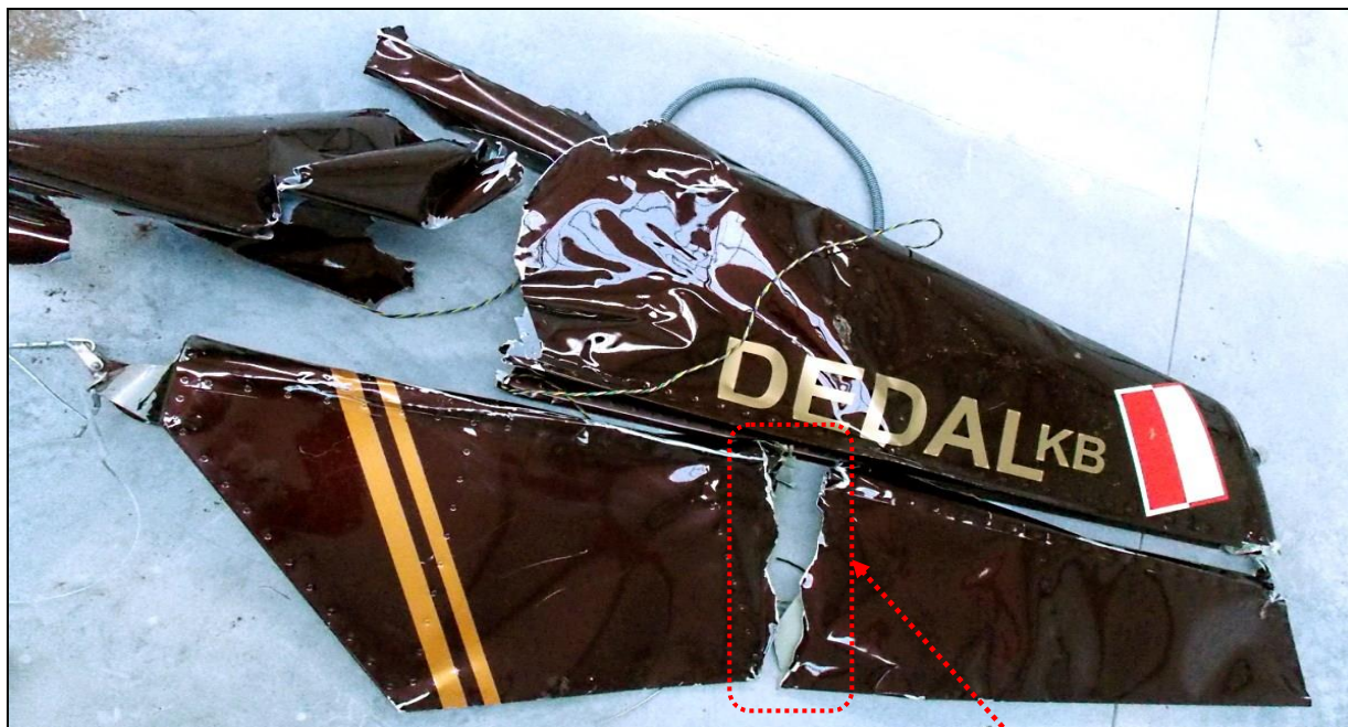
34 – Zniszczone usterzenie pionowe. Ster kierunku rozerwany na dwa fragmenty.
