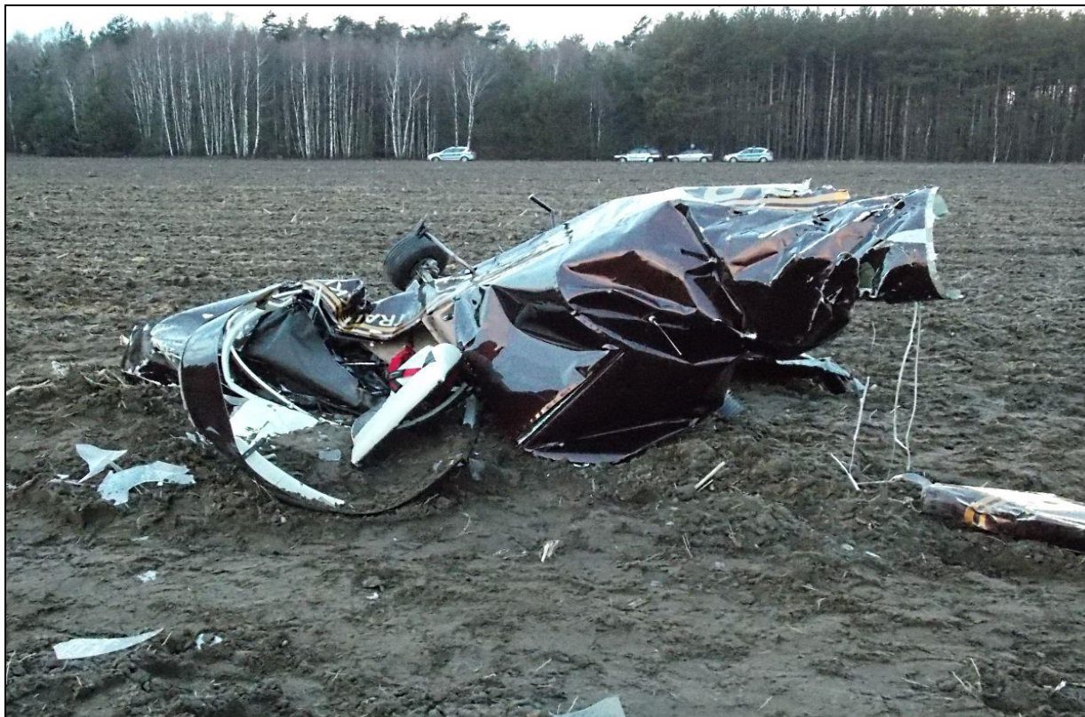
19 – Przednia część kadłuba z kabiną i zespołem napędowym [B] po upadku na lewy bok, widoczna strony grzbietu. Z prawej strony kadru widoczna dolna część złamanego steru kierunku, nadal połączona z kadłubem linkami sterowania. Widoczne odłamki prawej szyby oszklenia osłony kabiny. Zwraca uwagę skrajne zniszczenie tylnej części kadłuba – raz skręcaniem „w prawo” i drugi raz skręcaniem „w lewo”.
