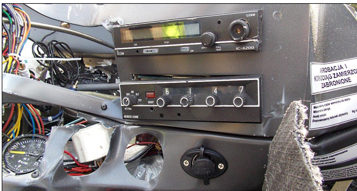
86 – Prawa część tablicy przyrządów – radiostacja IC A-200 i transponder Bendix/King KT76A (kod transpondera uległ przestawieniu w wyniku uszkodzenia).
