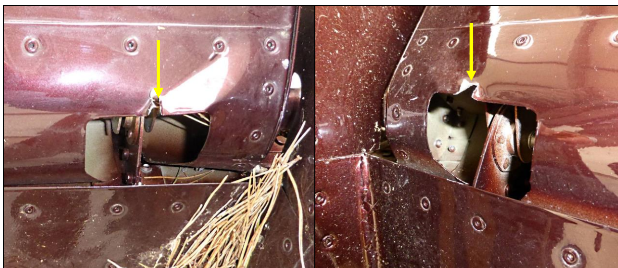
43, 44 – „Zacięcia” pokrycia steru wysokości i statecznika, spowodowane swobodnymi wychyleniami steru [dół].
