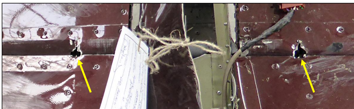
42 – „Zacięcia” pokrycia steru wysokości i statecznika, spowodowane swobodnymi wychyleniami steru [górną].
