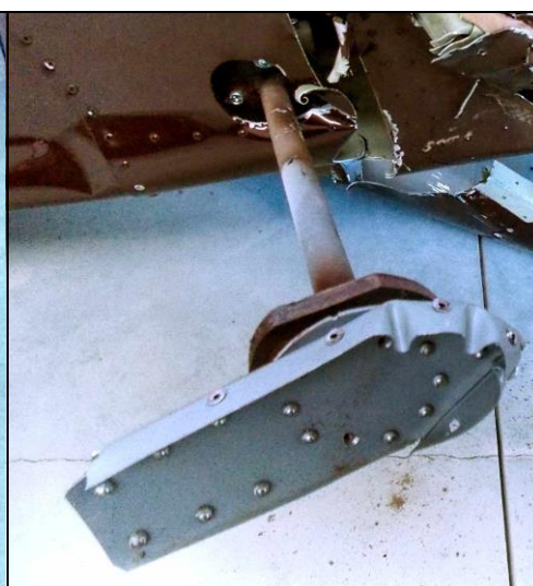
69 – Powyżej: wystająca z kadłuba rura skrętna napędu prawej kłapy z noskowym żeberkiem kłapy.
