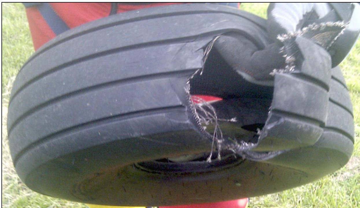
Fot. 6 – Opona lewego koła po kontakcie z łopatkami śmigła [zdjęcia: Użytkownik samolotu].
