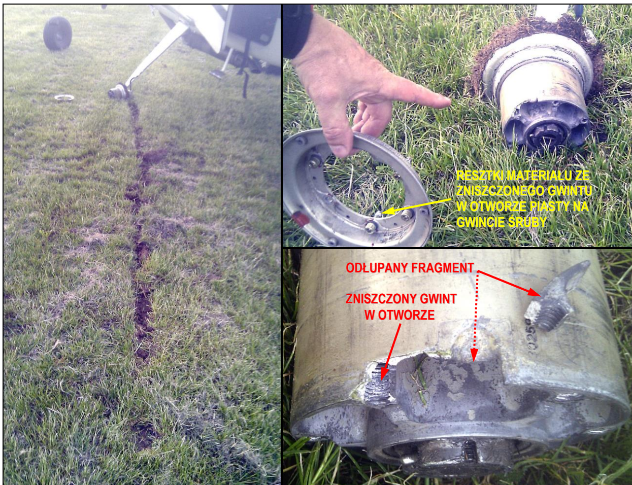
Fot. 3, 4, 5 – Ślad uszkodzonego podwozia na ziemi, oderwana obejma ze śrubami mocującymi i piasta koła na osi oraz piasta koła i odłupany od niej fragment materiału w zbliżeniu [zdjęcia: Użytkownik samolotu].
