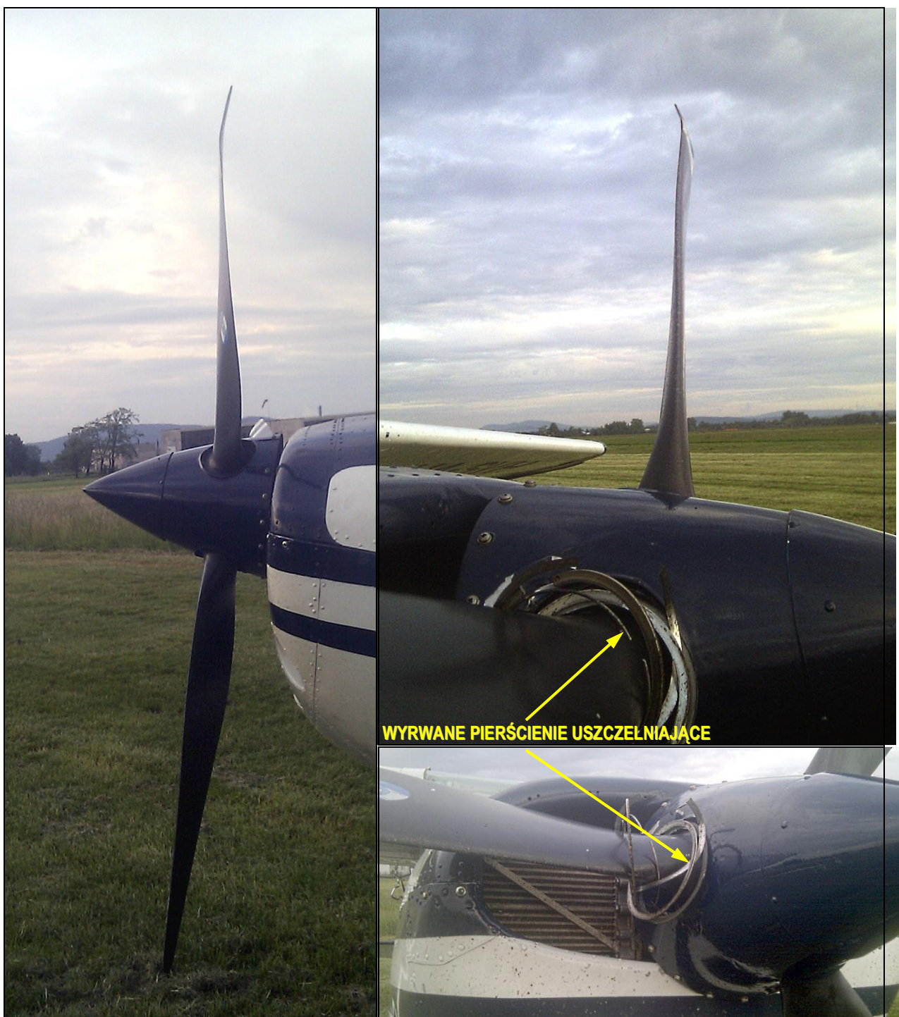
Fot. 7, 8, 9 – Uszkodzenia śmigła - widoczna zgięta końcówka jednej z łopaty i pierścienie uszczelniające, które wypadły z nasady drugiej łopaty w piaście śmigła [zdjęcia: Użytkownik samolotu].
