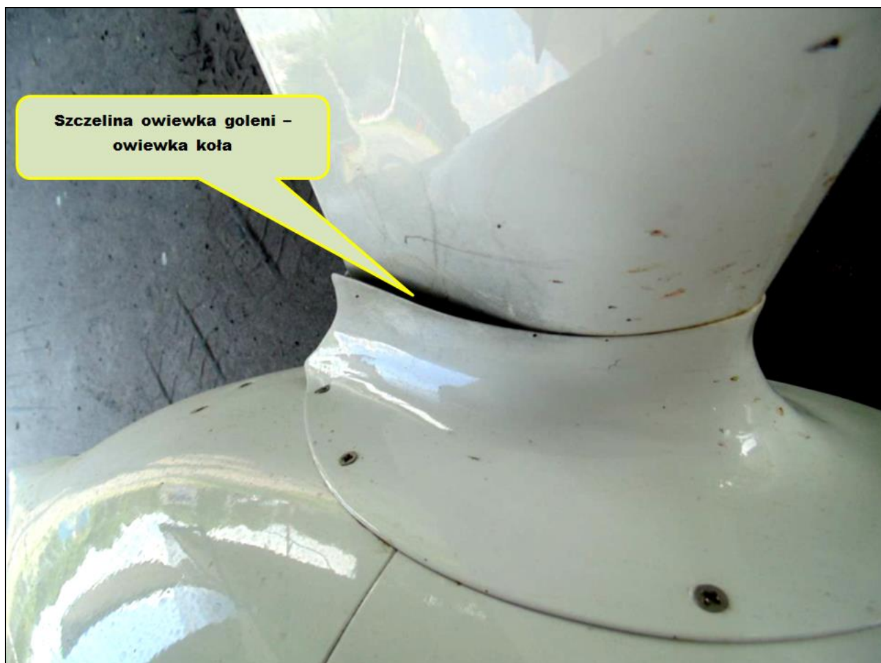
Ilustracja 7. Szczelina owiewka goleni – owiewka koła.
