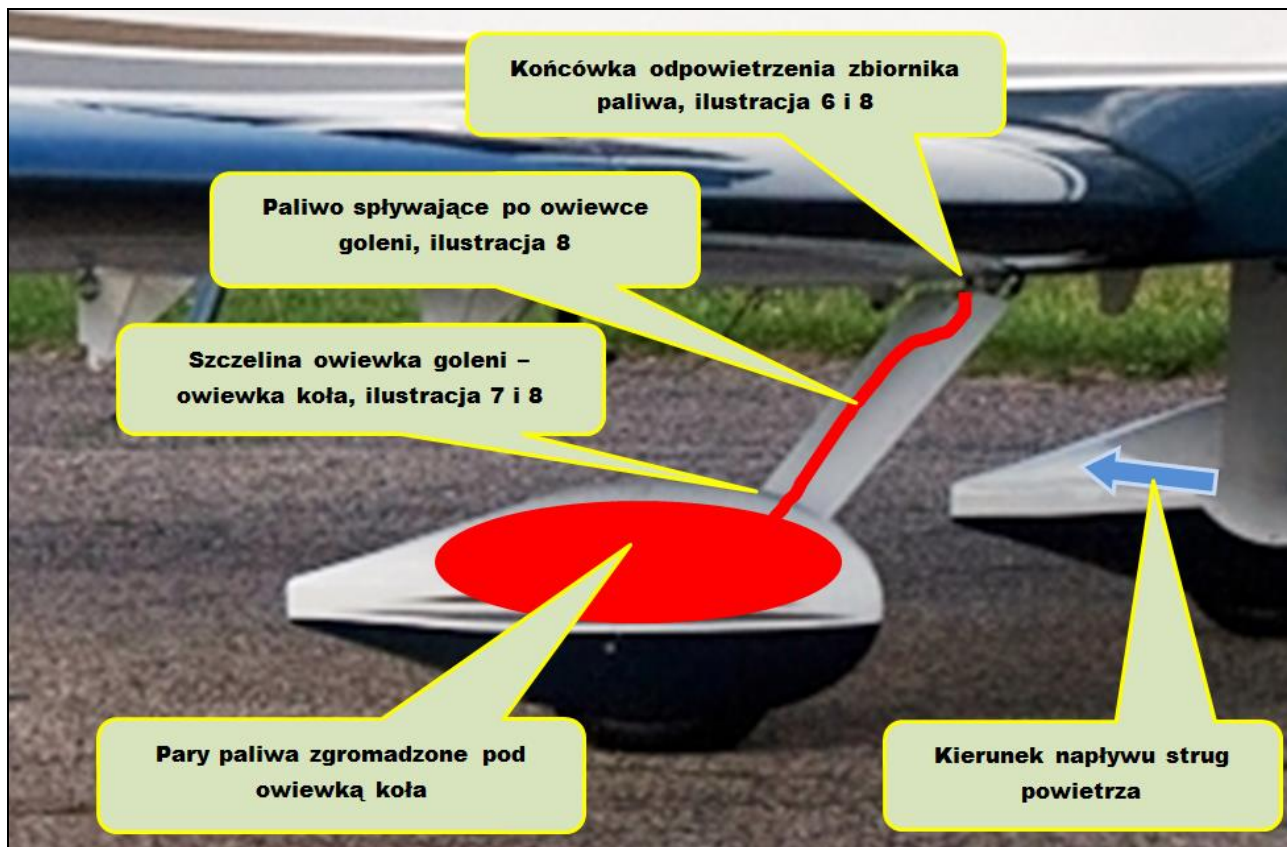
Ilustracja 5. Droga paliwa z końcówki odpowietrzenia pod owiewkę koła.
