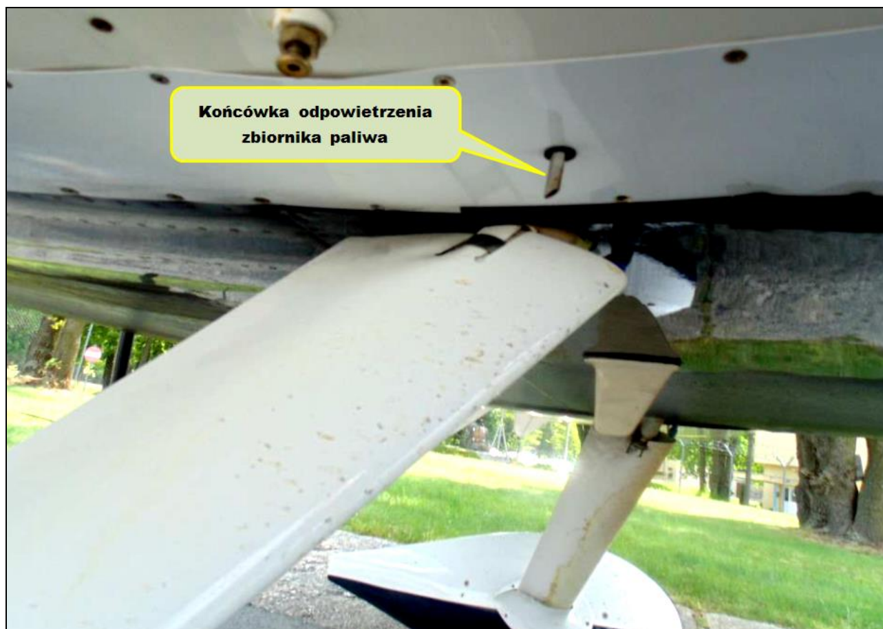
Ilustracja 6. Umieszczenie końcówki odpowietrzenia zbiornika paliwa.
