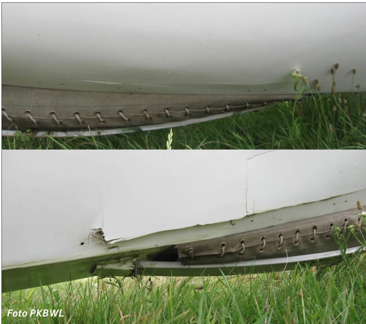
Ilustracje nr 1. Uszkodzenia kadłuba szybowca.
