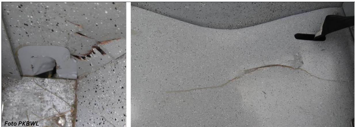
Ilustracja nr 3. Uszkodzona płyta hamulca aerodynamicznego i podwozie szybowca.
