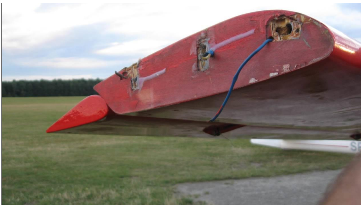
Ilustracja nr 2. Uszkodzona końcówka skrzydła.
