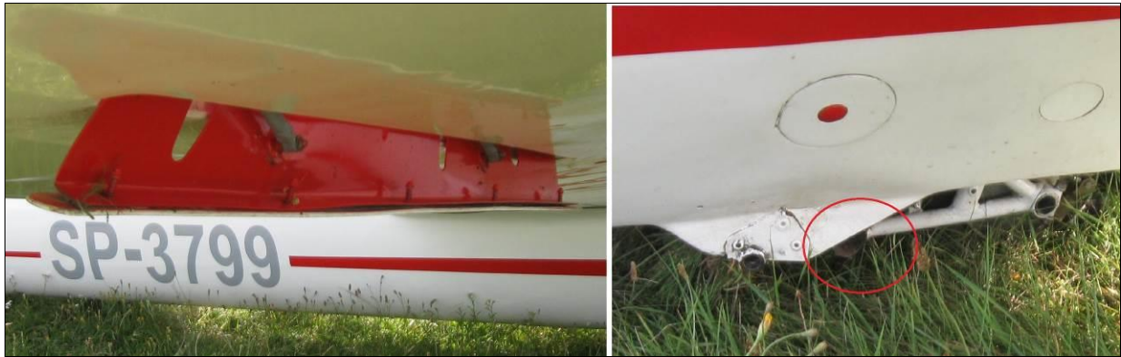
Ilustracja nr 3. Uszkodzona płyta hamulca aerodynamicznego i podwozie szybowca.
