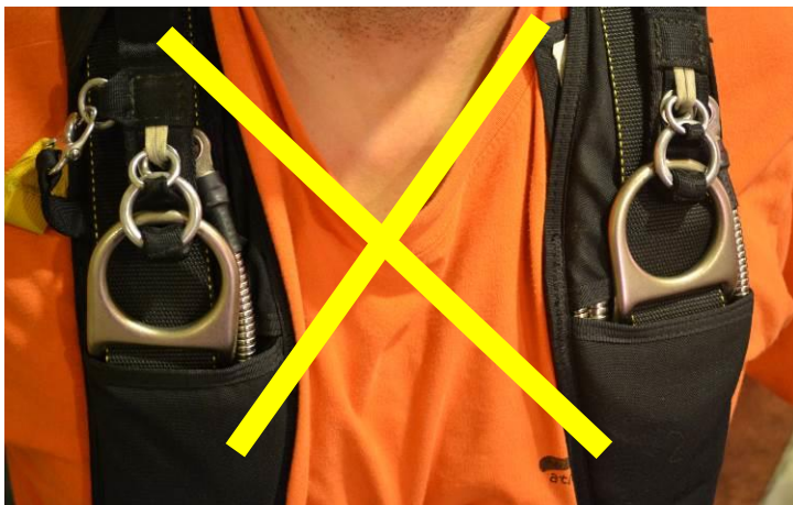
Fot.1. Zamki złożone z nieprawidłowej kompletacji tzw. dużej i małej wersji systemu trzykółkowego. Uwagę zwraca położenie pierścienia i przebieg taśmy systemu RSL na zewnątrz prawej taśmy nośnej, które nie jest dostosowane do danego systemu pokrowca / uprzęży. (fot. PKBWL)
