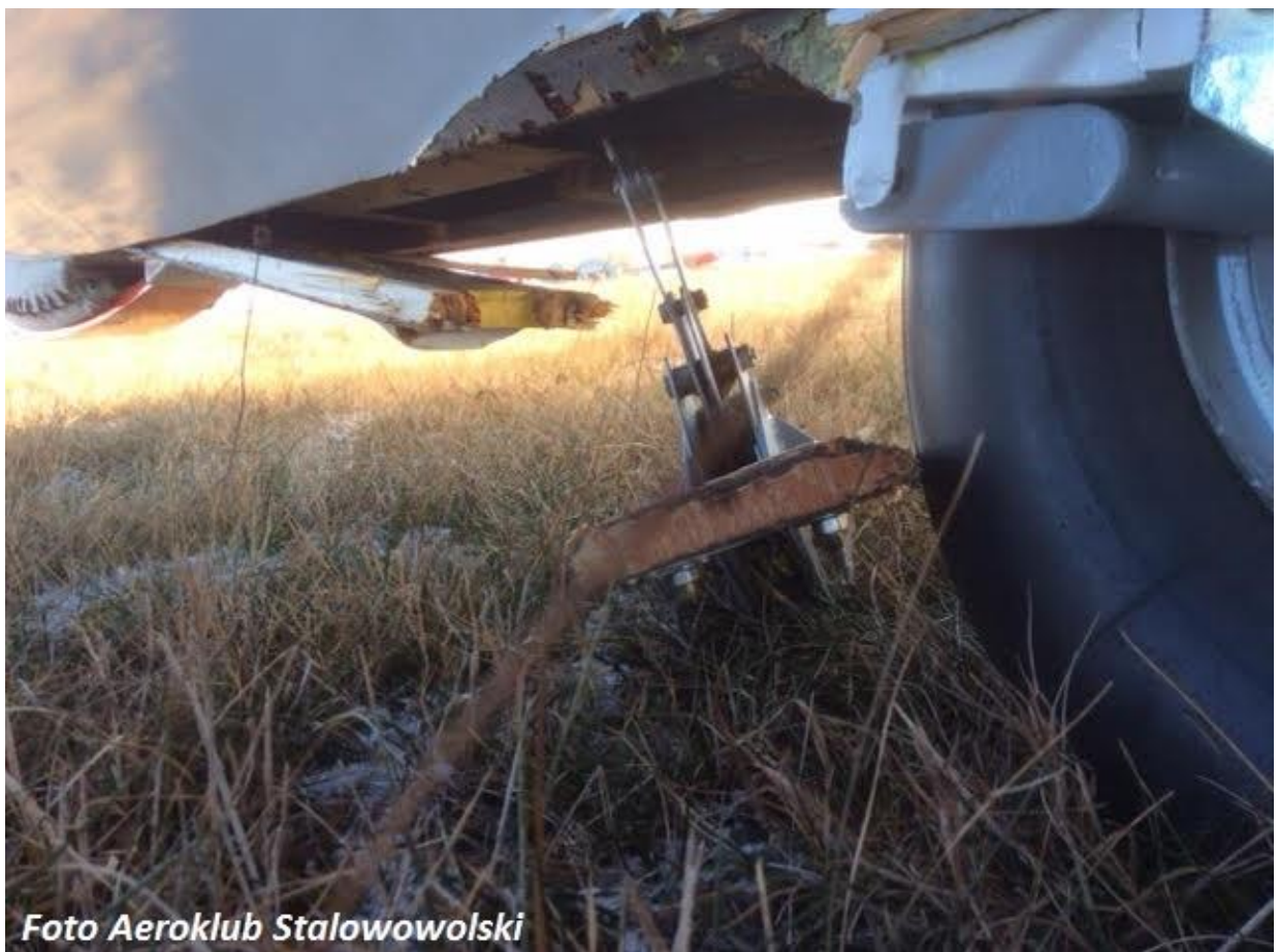
Ilustracja nr 2. Uszkodzona listwa kilowa i wyrwany zaczep.
