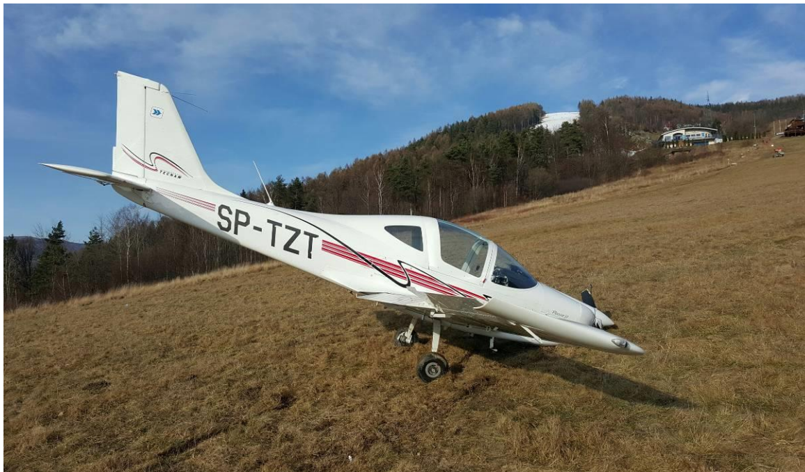
Rys. 3. Samolot na miejscu zdarzenia bezpośrednio po lądowaniu. Widoczny stan wychylenia klap – klapy w położeniu startowym.[foto GSS AP Żar]
