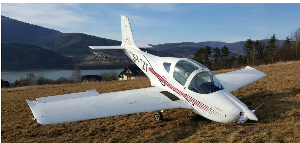
Rys. 4. Samolot na miejscu zdarzenia. Widoczny brak przedniego podwozia i uszkodzone obie łopaty śmigła oraz odkształcona boczna osłona silnika.[foto GSS AP Żar]
