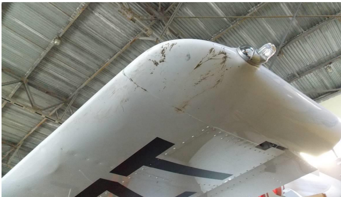
Rys. 6. Niewielkie uszkodzenia końcówki lewego skrzydła.
