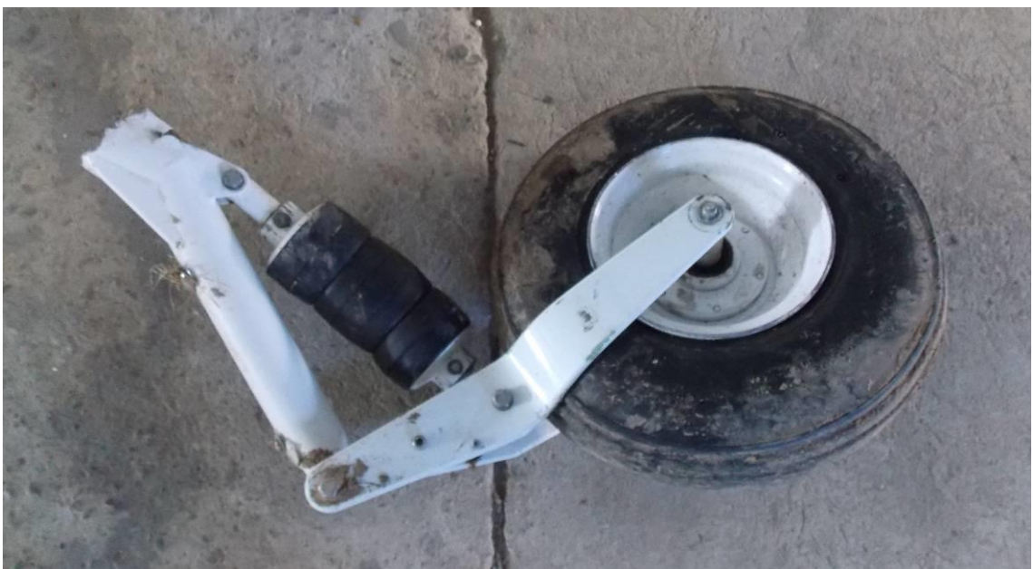
Rys. 5. Złamana goleń wraz widelcem, amortyzatorem i kołem.
