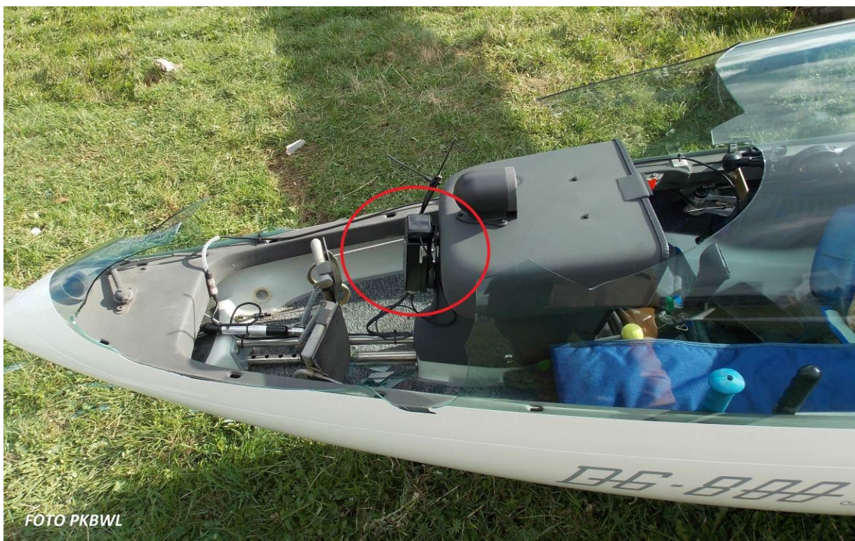
Ilustracja nr 4. Uszkodzenia owiewki kabiny. W czerwonym kółku widoczny uszkodzony rejestrator lotu.
