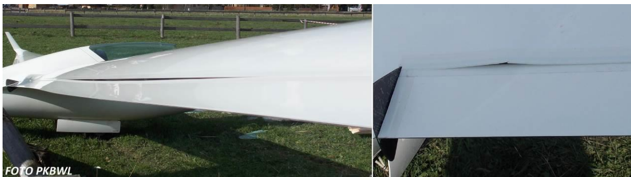
Ilustracja nr 3. Uszkodzone (zafalowane) poszycie skrzydła szybowca.
