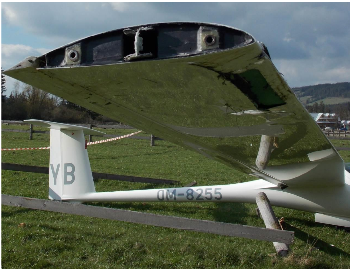
Ilustracja nr 1. Uszkodzenia końcówki prawego skrzydła, widoczne uszkodzone ogrodzenie.
