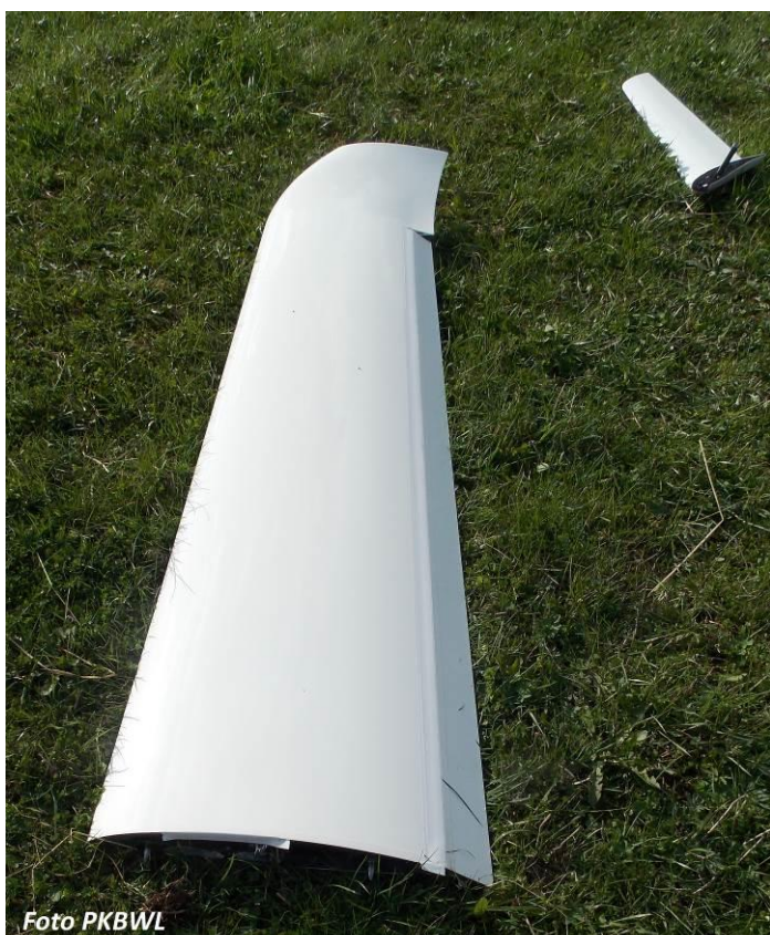
Ilustracja nr 1. Uszkodzenia końcówki prawego skrzydła, widoczne uszkodzone ogrodzenie.
