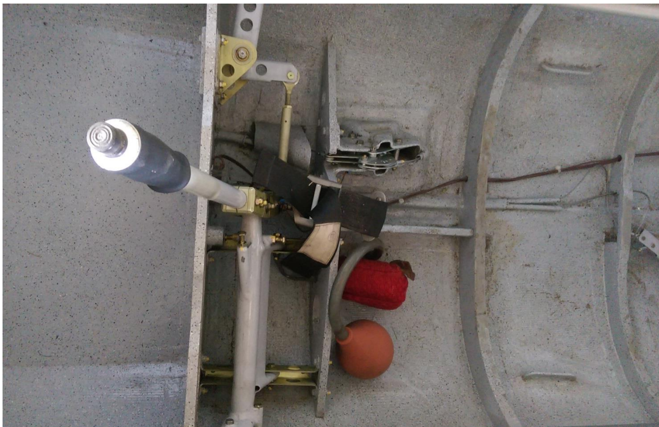
Fot. 3 Położenie 5. pasa po zdjęciu miski siedzenia
