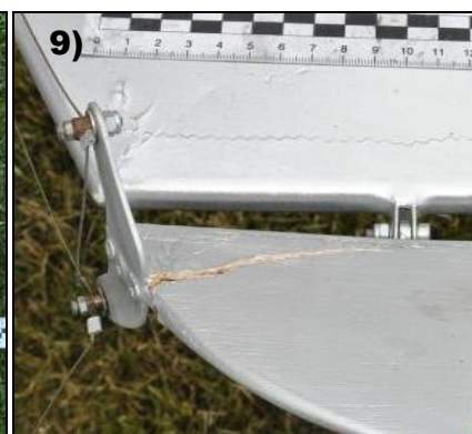
Rys.7÷9 Zdjęcia uszkodzeń samolotu Tulak (fot. Policja)
