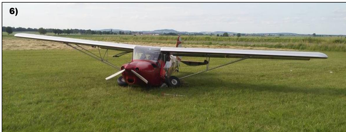
Rys.5÷6 Zdjęcia uszkodzonego samolotu Tulak (fot. Użytkownik SP)
