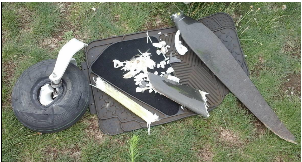
Rys.1÷3 Uszkodzenia samolotu Pipistrel Virus SW (fot. użytkownik SP)
