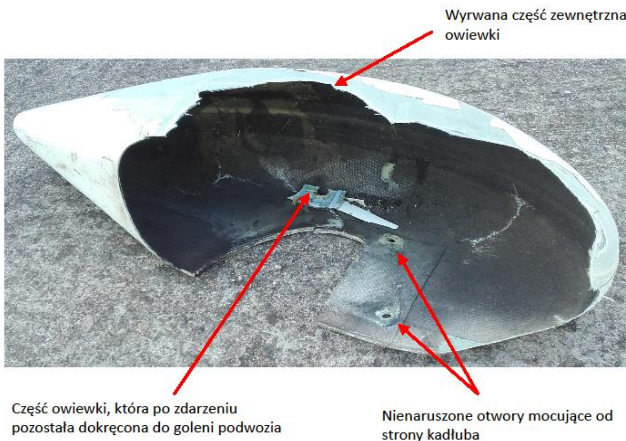
Rys. Uszkodzona owiewka prawego koła podwozia głównego samolotu DA20-A1 (fot. i opis - użytkownik SP)
