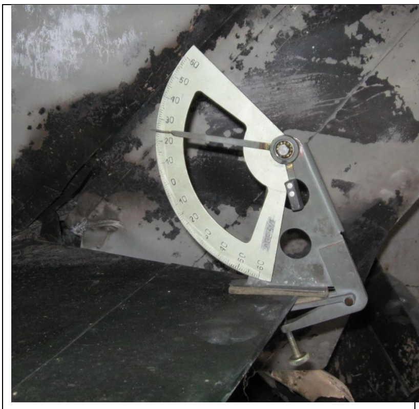
Rys.10. Wykonany na wraku zabezpieczonym do badań pomiar zakresu wychylenia steru wysokości w górę - 25°, co odpowiada wartości podanej w Instrukcji.
