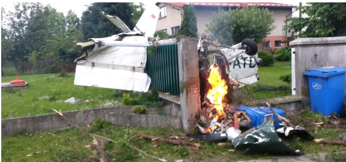
Rys.2. Lokalny pożar instalacji paliwa. Pozostała część samolotu nie nosi jeszcze śladów oddziaływania ognia – zdjęcie wykonane przez świadka wypadku [foto Krzysztof Zimny].
