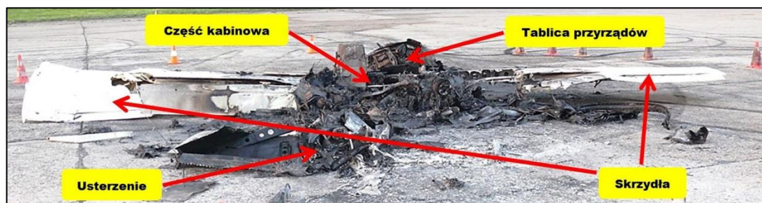
Ilustracja 6. Zniszczenia samolotu wskutek uderzenia i pożaru.
