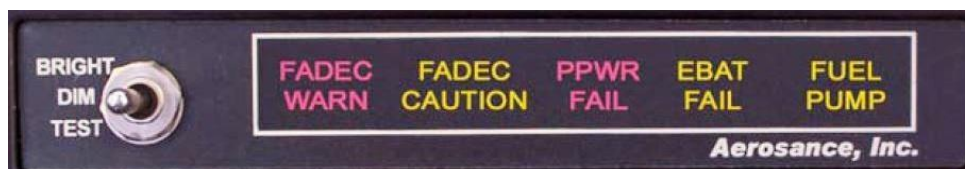
Ilustracja 13. Panel ostrzeżeń i przestróg systemu FADEC.
