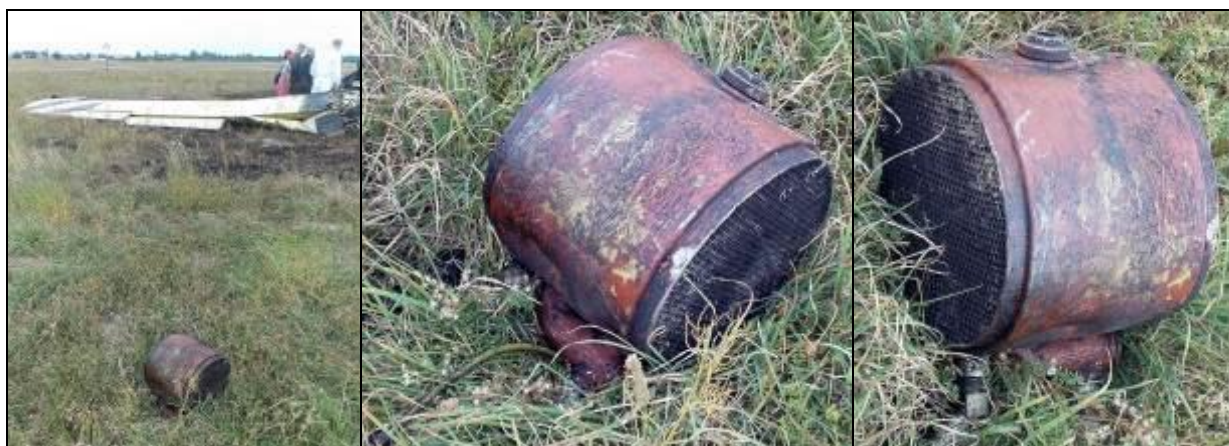
83, 84, 85 – Oderwana chłodnica oleju.
