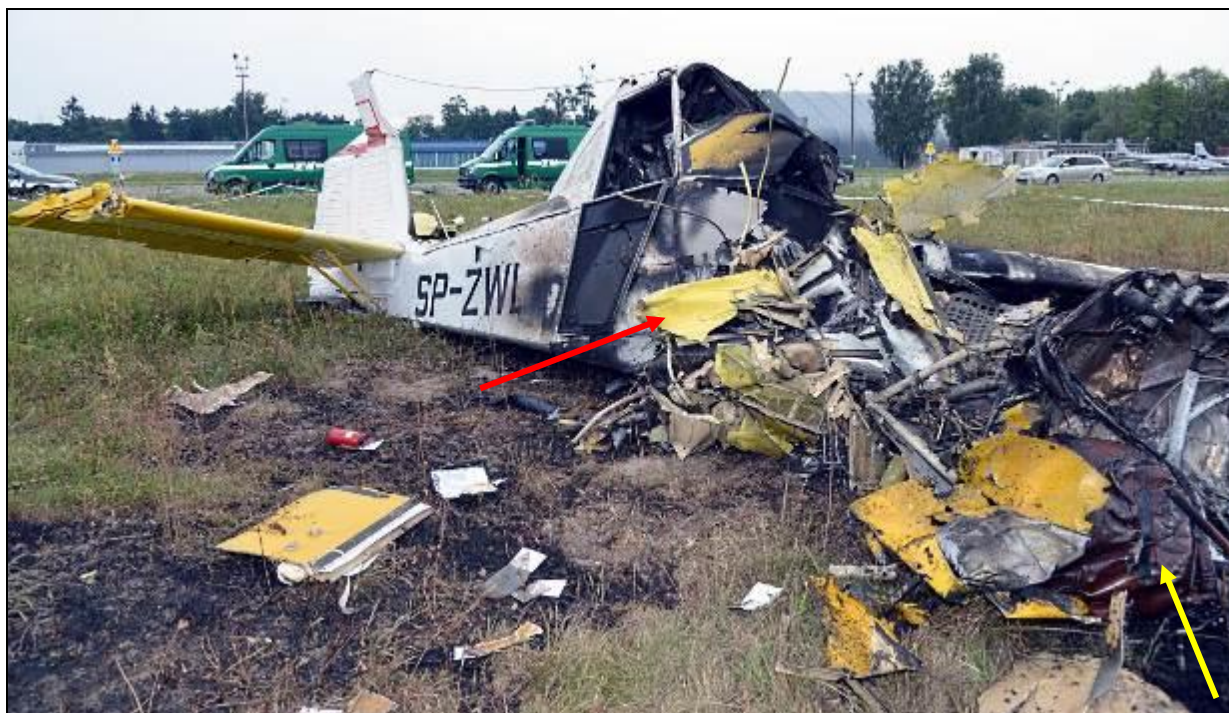
46 – Widok ogólny wraku \frac{3}{4} od przodu i z prawej strony kadłuba – zbliżenie. Czerwoną strzałką wskazane pokrycia prawej części centroplata, żółta - zniszczony zbiornik oleju. [foto: Żandarmeria Wojskowa].
