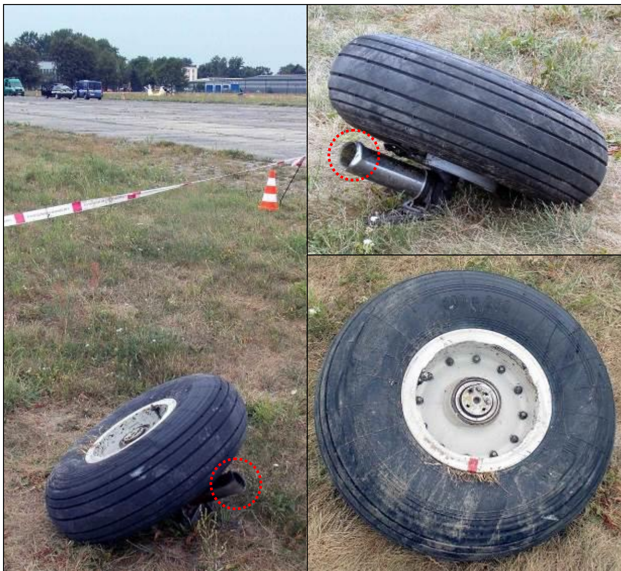
76, 77, 78 – Koło prawego podwozia głównego z fragmentem tulei amortyzatora. Kierunek łamania tulei – w stronę przeciwną do kierunku lotu. Trawa wbita między oponę a obręcz świadczy o przesuwaniu się koła na boku z dużą energią.
