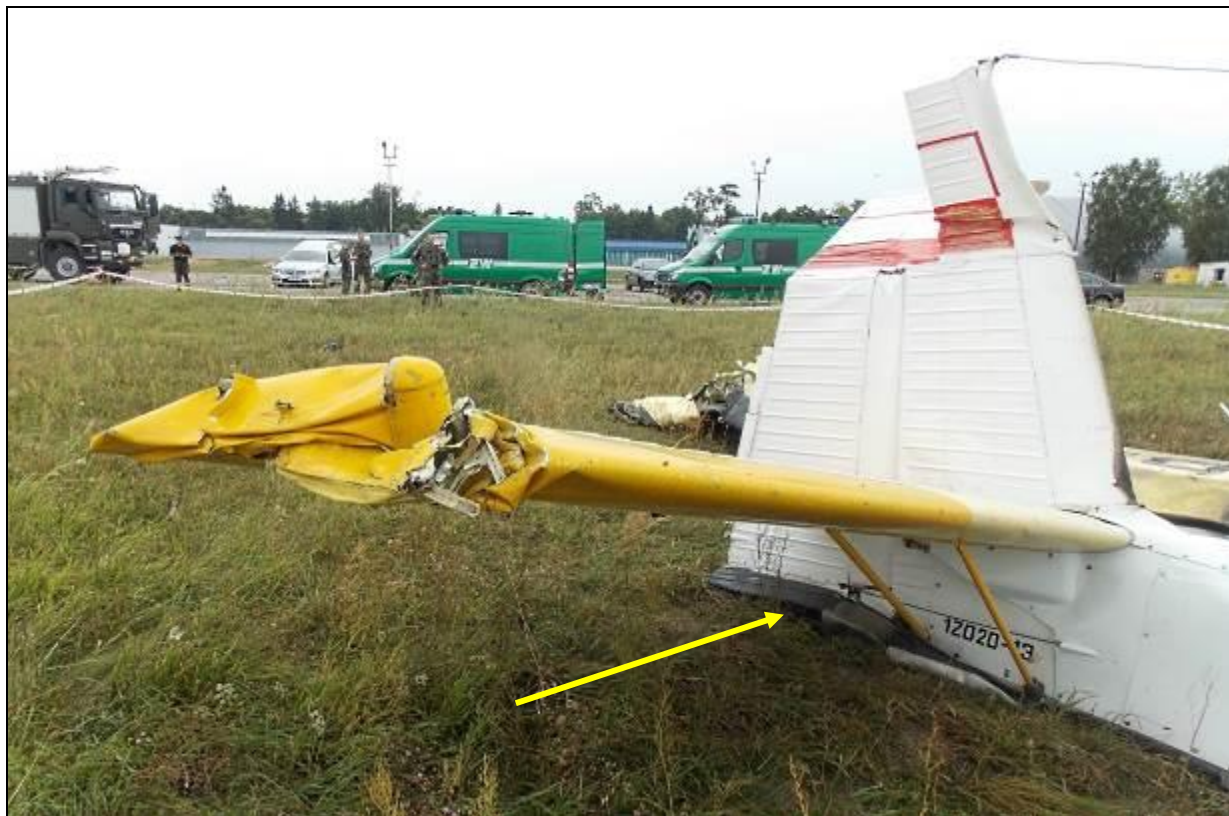
50 - Zbliżenie na usterzenie \frac{3}{4} z lewej strony od przodu. Strzałką wskazane charakterystyczne odgięcie dolnej części usterzenia pionowego, spowodowane obrotem kadłuba podczas jego przemieszczania po ziemi.
