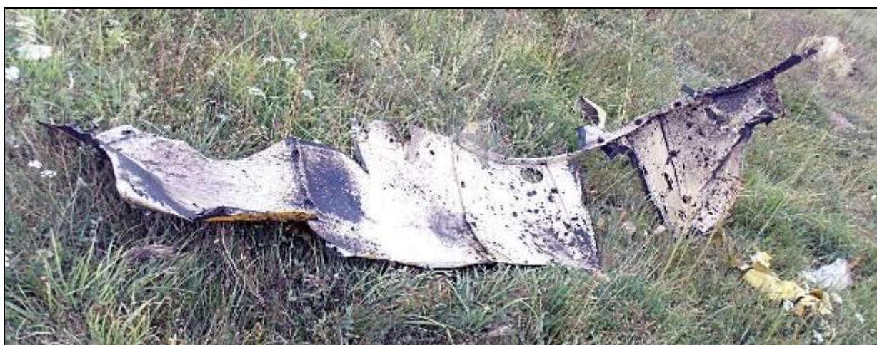
31 – Zniszczona osłona łoża silnika (widoczna wewnętrzna powierzchnia części).
