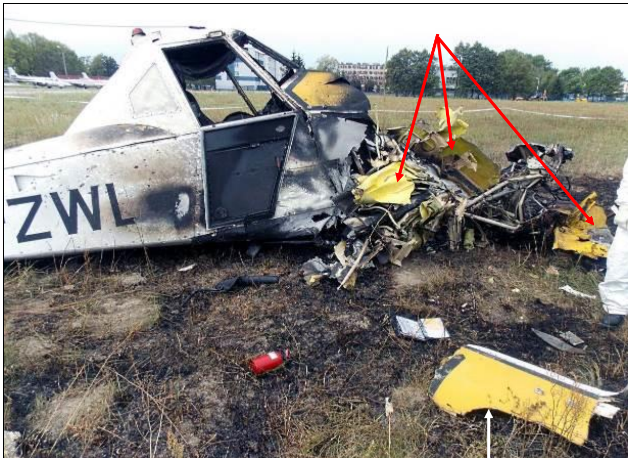
51 – Przednia część kadłuba z prawej strony. Czerwonymi strzałkami wskazane pokrycia zniszczonej prawej części centroplata. Na pierwszym planie fragment pokrycia zbiornika chemikaliów (strzałka biała), gaśnica i notatnik pilota.
