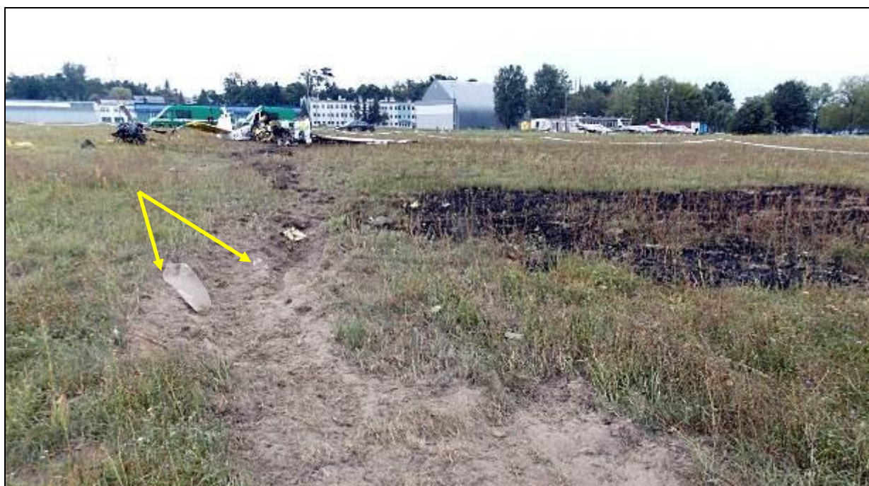
17 – Ogólny widok miejsca wypadku od miejsca zmiany kierunku śladów. Dobrze widoczne odłamane łopaty śmigła (strzałki żółte) oraz plama spalonej trawy po znacznym i gwałtownym wycieku paliwa.
