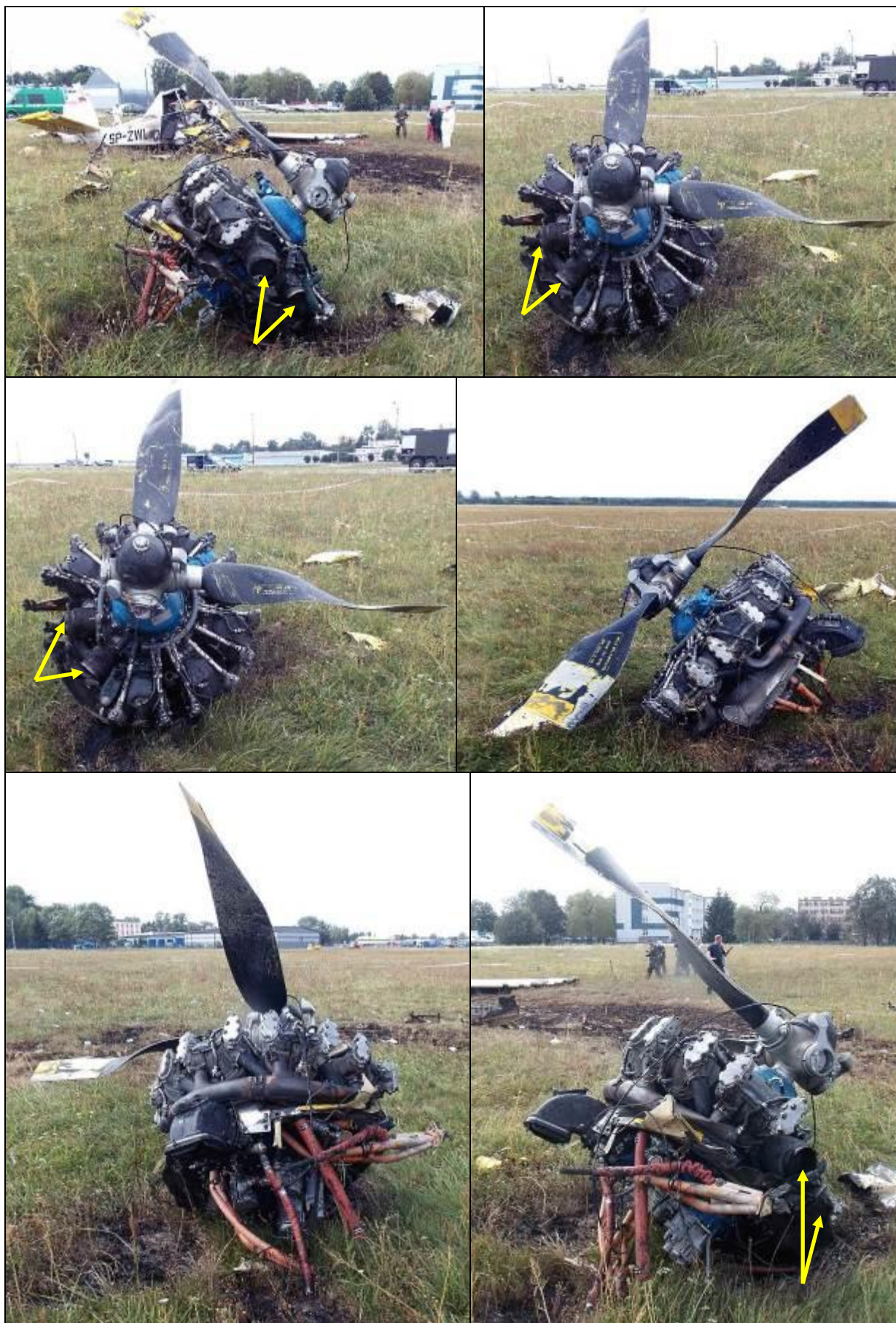
20, 21, 22, 23, 24, 25, 26 – Silnik oderwany od płatowca, pokazany z różnych stron. Zwraca uwagę brak głowic dolnych cylindrów z prawej strony (strzałki żółte).
