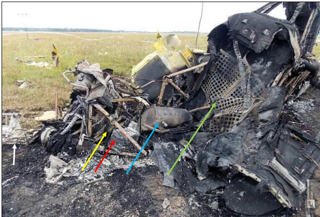
54 – Szczątki przedniej części kadłuba, prawa strona. Strzałka biała – dennica zbiornika chemikaliów, żółta – akumulator instalacji hydraulicznej, czerwona – akumulator instalacji elektrycznej, niebieska – zbiornik detektoru, zielona – perforowane przegrody wnętrza zbiornika chemikaliów.
