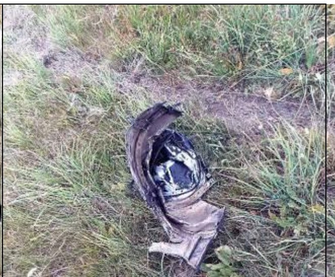
30 – Obudowa chłodnicy oleju. Nad nią dobrze widoczna bruzda – ślad przemieszczania się silnika po oderwaniu od płotowca.
