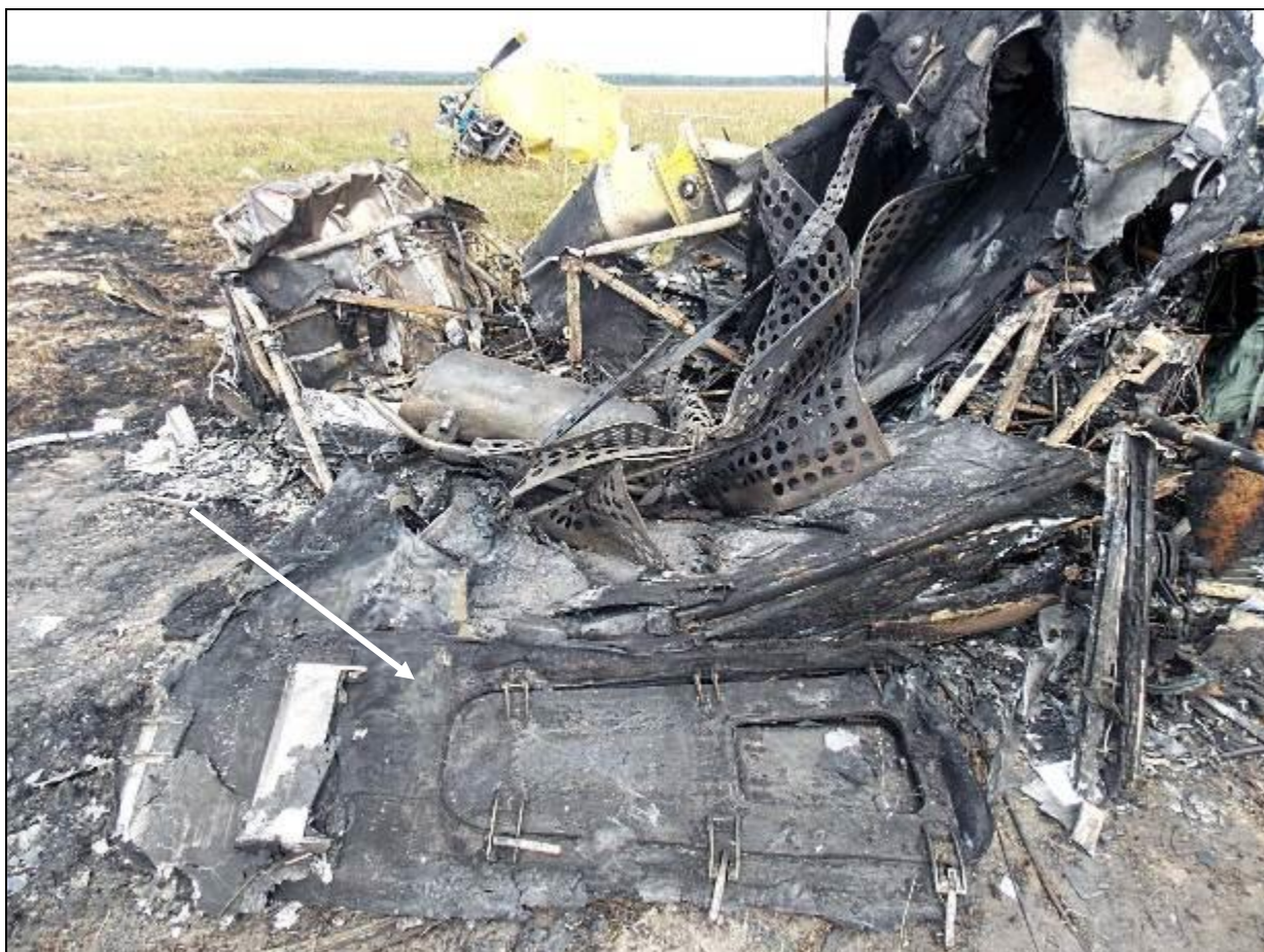
53 – Górna część pokrycia zbiornika chemikaliów z pokrywą zasypową.
