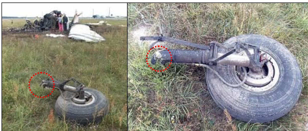
74, 75 – Koło lewego podwozia głównego z dużym fragmentem goleni. Kierunek łamania goleni – ku końcówce lewego skrzydła.
