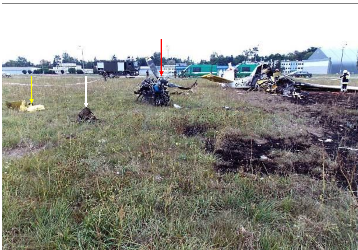
19 – Widok wzdłuż kierunku przesuwania się samolotu na ziemi, po lewej stronie szlaku szczątków i śladów pożaru paliwa. Czerwoną strzałką wskazany silnik z dwiema łopatami śmigła, żółtą – prawa lotka centroplata, białą – obudowa chłodnicy oleju.
