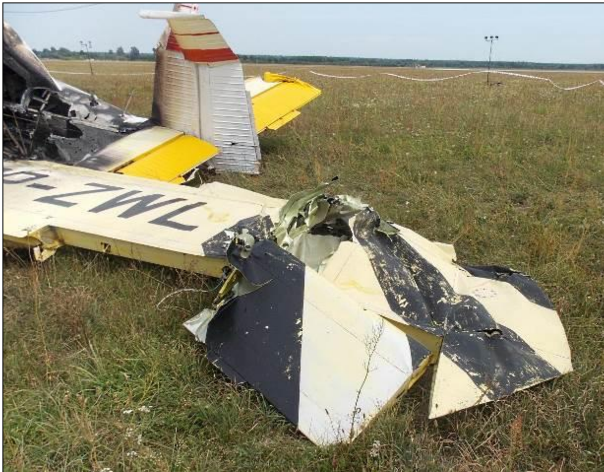
62 – Końcówka prawego skrzydła i fragmenty prawej lotki pozostałe przy skrzydle. Na drugim planie usterzenie samolotu.
