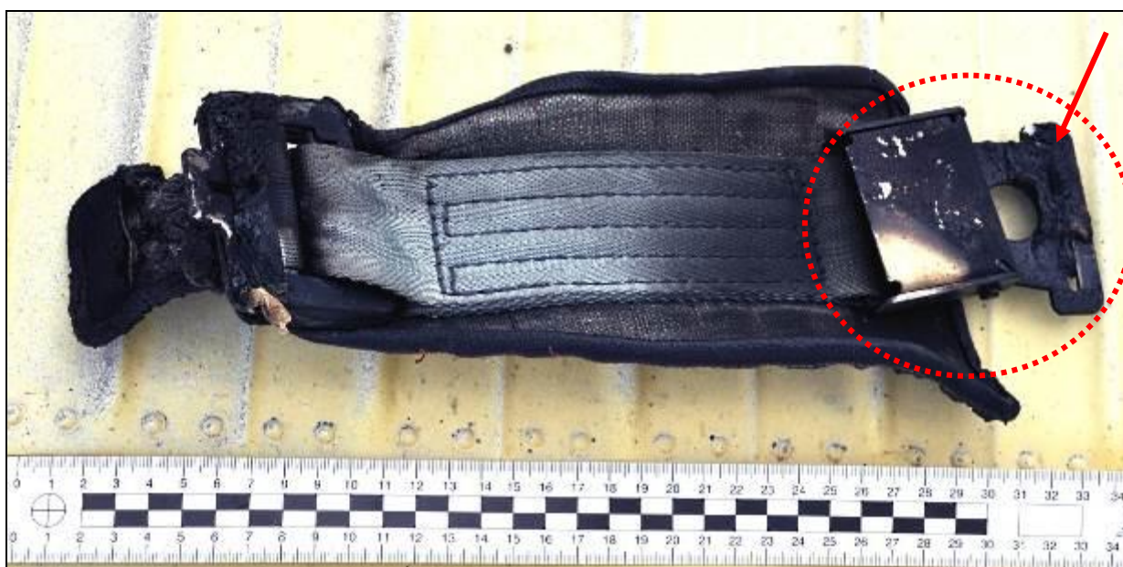
59 – Lewy pas biodrowy pilota. Klamra zniszczonego prawego pasa (strzałka czerwona) widoczna w zamku, co świadczy o tym, że pas był zapięty [foto: Żandarmeria Wojskowa].
