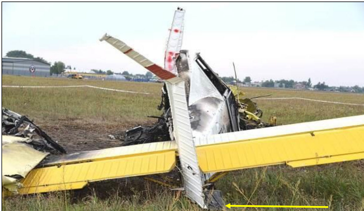
48 – Zbliżenie na kadłub od tyłu. Strzałką wskazane charakterystyczne odgięcie dolnej części usterzenia pionowego, spowodowane obrotem kadłuba podczas jego przemieszczania po ziemi [foto: Żandarmeria Wojskowa].
