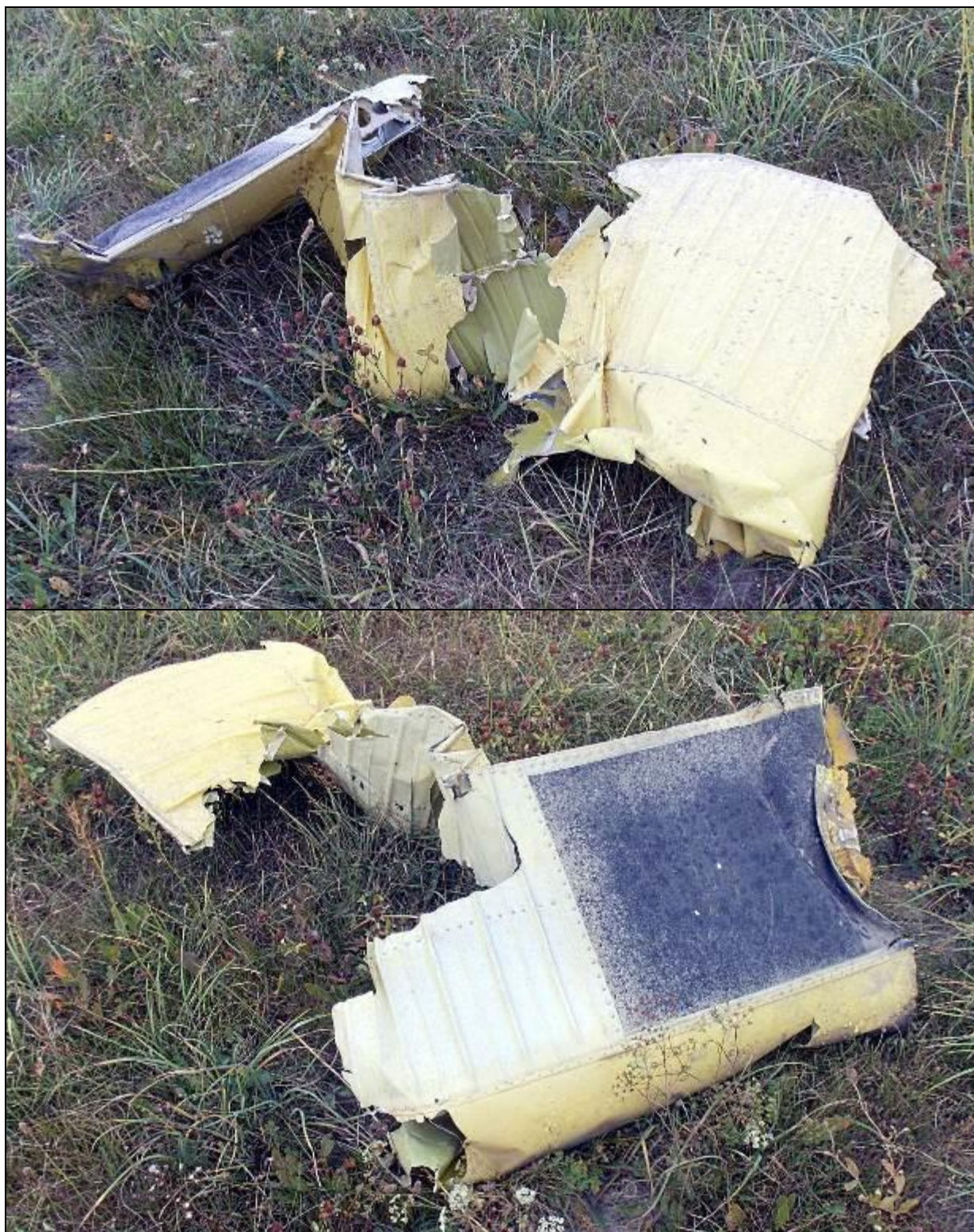
32, 33 – Zniszczona prawa kłapa centroplata.
