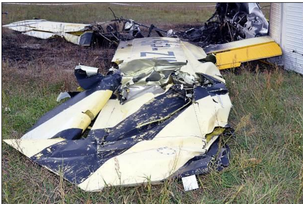
61 – Prawe skrzydło od strony zniszczonej końcówki [foto: Zandarmeria Wojskowa].
