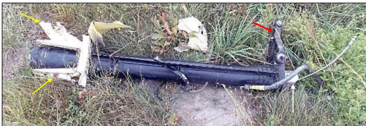
16 – Goleń prawego podwozia głównego, wylamana ze skrzydła. Z lewej strony widoczne fragmenty mocowania goleni w skrzydle (strzałki żółte), z prawej górna połówka nożyc (strzałka czerwona) i złamana tuleja amortyzatora (strzałka biała).
