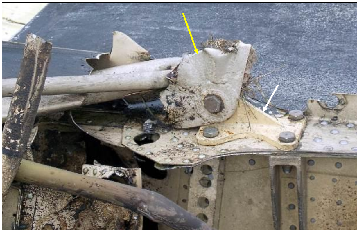
72 - Lewe tylne okucie mocowania centroplata do kadłuba (strzałka biała) i odpowiadające mu okucie na kratownicy kadłuba (strzałka żółta).
