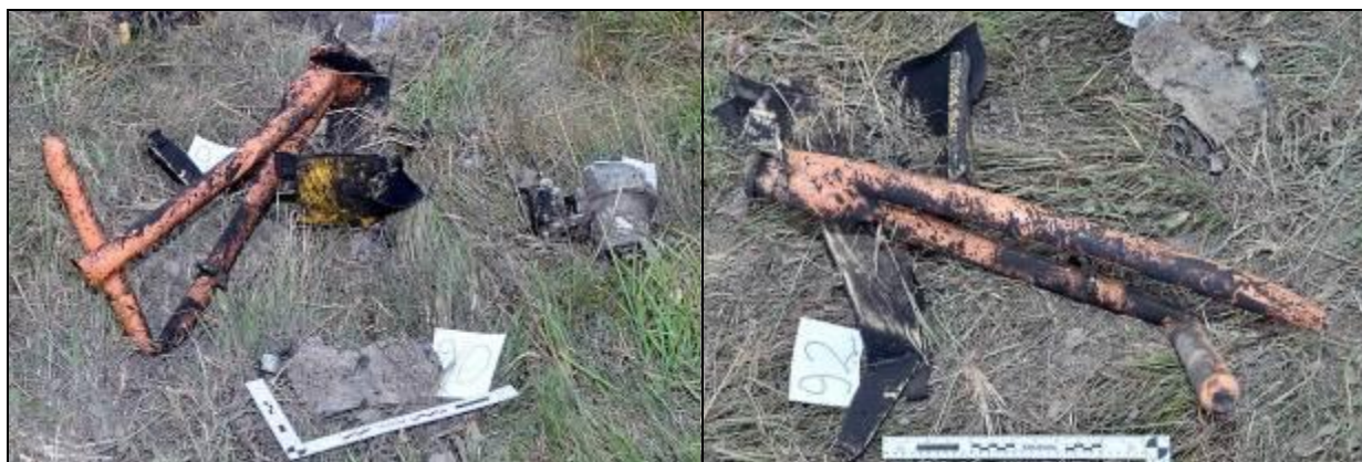
79, 80 – Fragmenty zniszczonego łoża silnika [foto: Żandarmeria Wojskowa].
