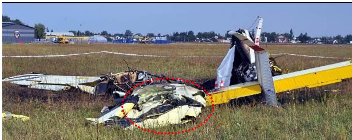
43 – Widok ogólny wraku od tyłu – zbliżenie na zniszczoną końcówkę prawego skrzydła [foto: Żandarmeria Wojskowa].
