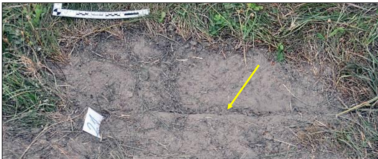
15 – Ślad goleni prawego podwozia dobrze widoczny w ziemi – zwraca uwagę wyraźny odcisk noża do przecinania drutów [foto: Żandarmeria Wojskowa].
