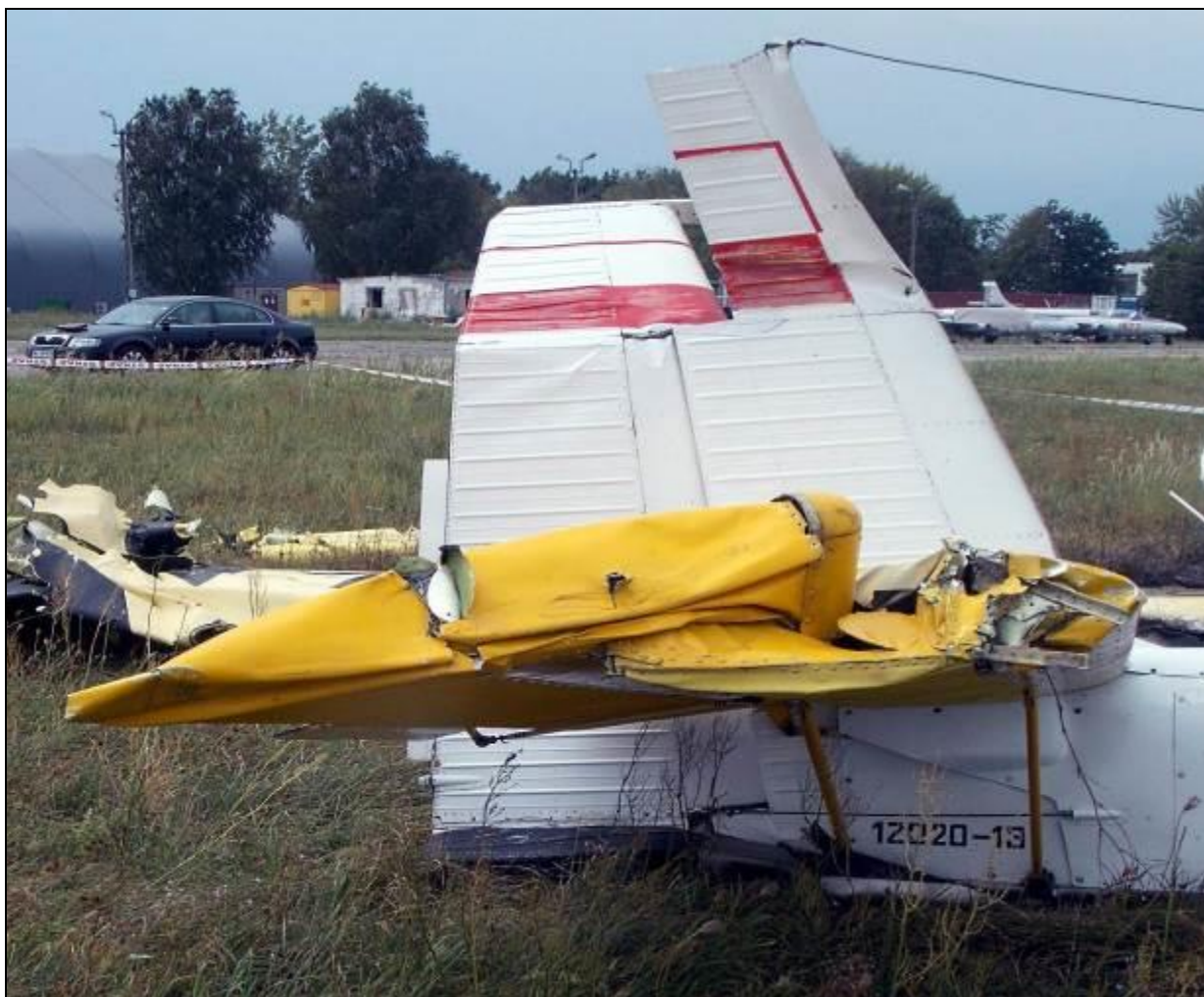
49 – Zbliżenie na usterzenie z prawej strony. Widoczne uszkodzenie końcówki usterzenia poziomego i złamanie górnej części steru wysokości wskutek oddziaływania siły bezwładności od masy wyważającej ster.
