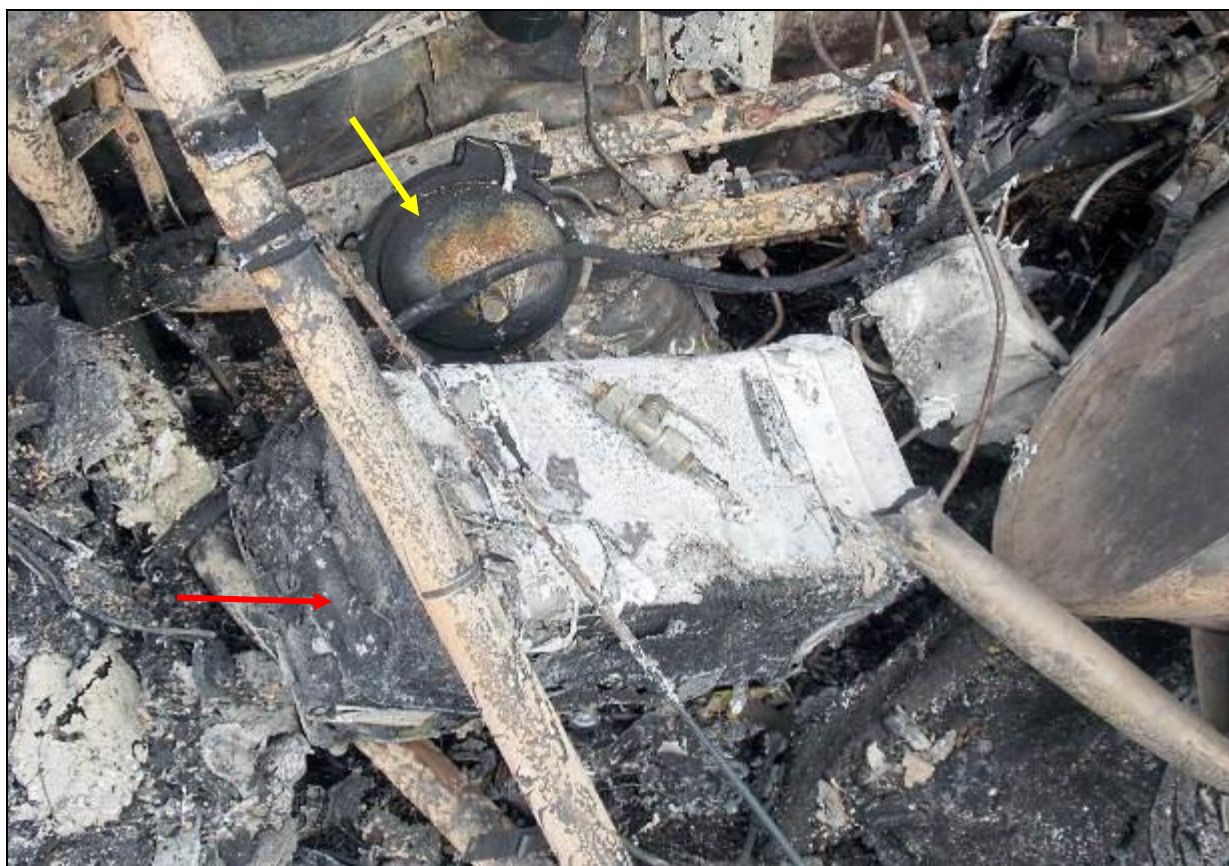
55 - Szczątki przedniej części kadłuba, zbliżenie. Strzałka żółta – akumulator instalacji hydraulicznej, czerwona – akumulator instalacji elektrycznej.
