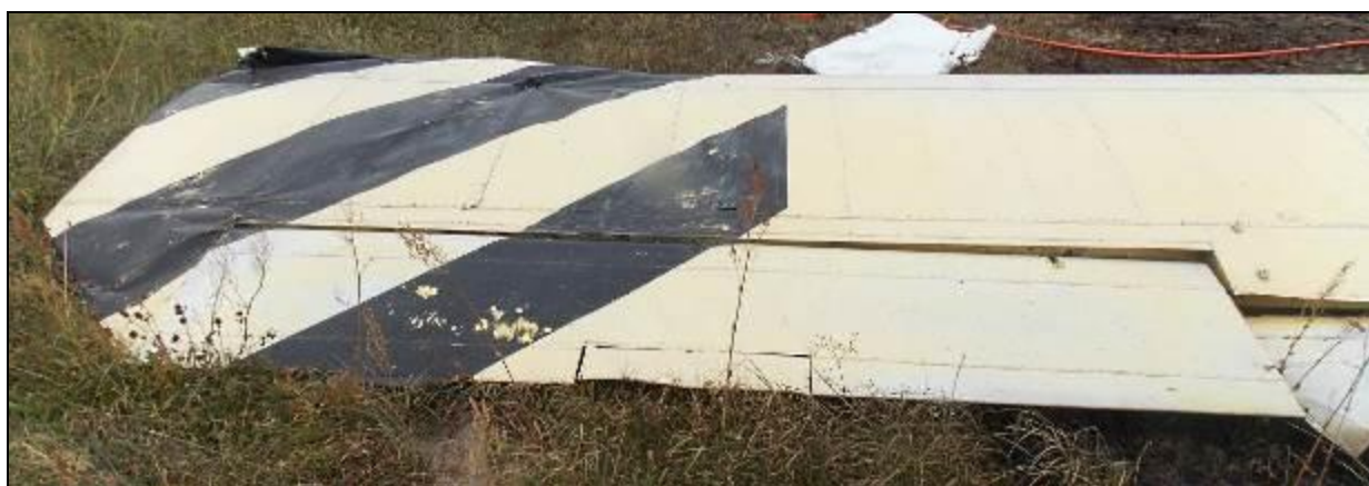
68 – Końcowa część lewego skrzydła zewnętrznego z lotką.
