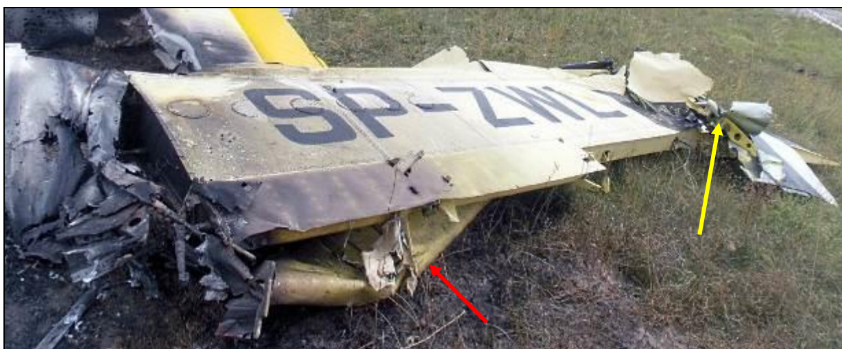
63 – Prawe skrzydło od strony zniszczonej prawej części centroplata. Strzałką czerwoną wskazana zniszczona i podwinięta pod spód skrzydła prawa kłapa skrzydłowa, strzałką żółtą – fragmenty prawej lotki pozostałe przy skrzydle.
