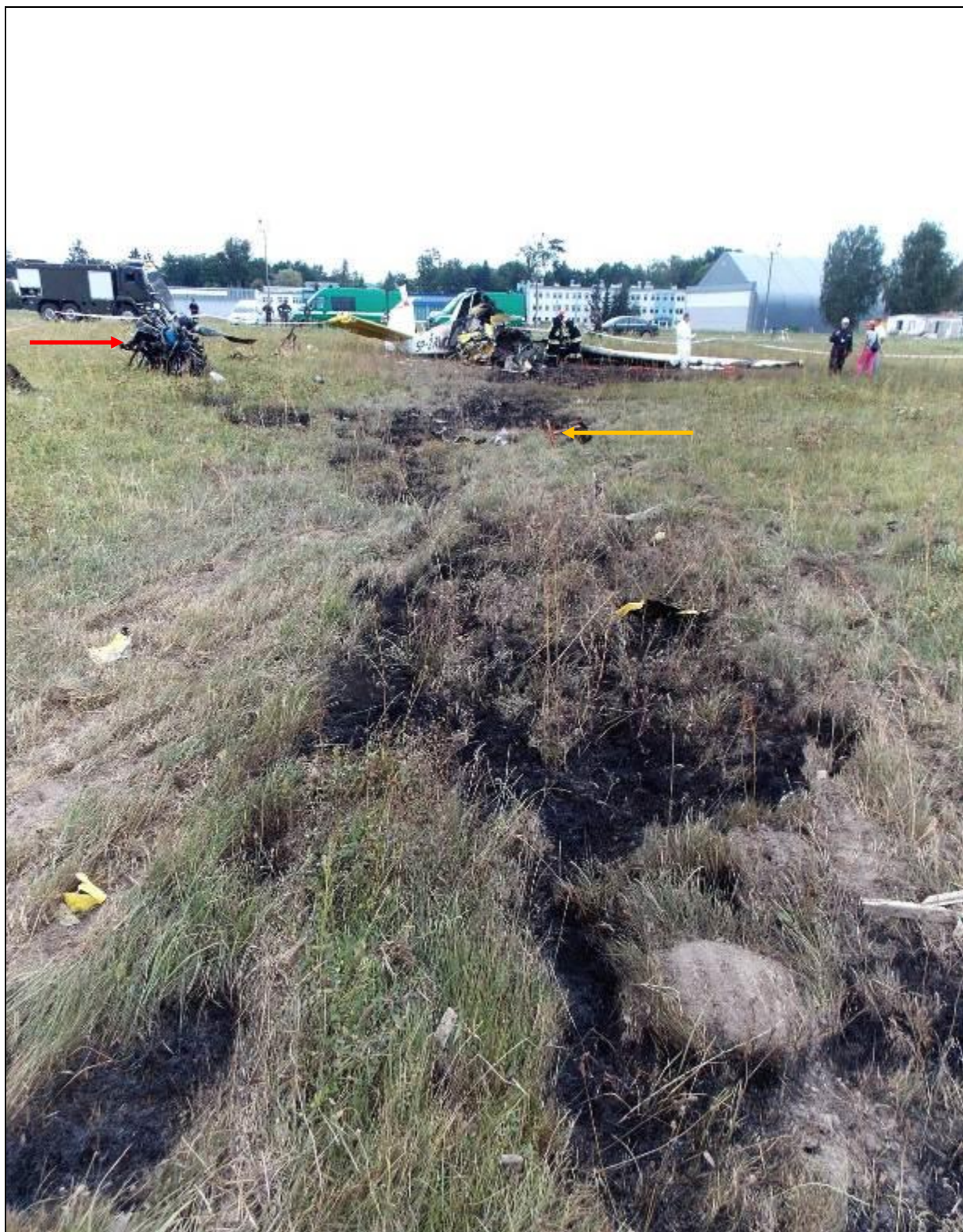
20 – Ślad przesuwania się samolotu po ziemi i ślad pożaru paliwa. Na pierwszym planie widoczne drobne szczątki pokryć skrzydeł i kadłuba, dalej widać silnik (strzałka czerwona) i fragmenty zniszczonego łoża silnika (strzałka pomarańczowa).
