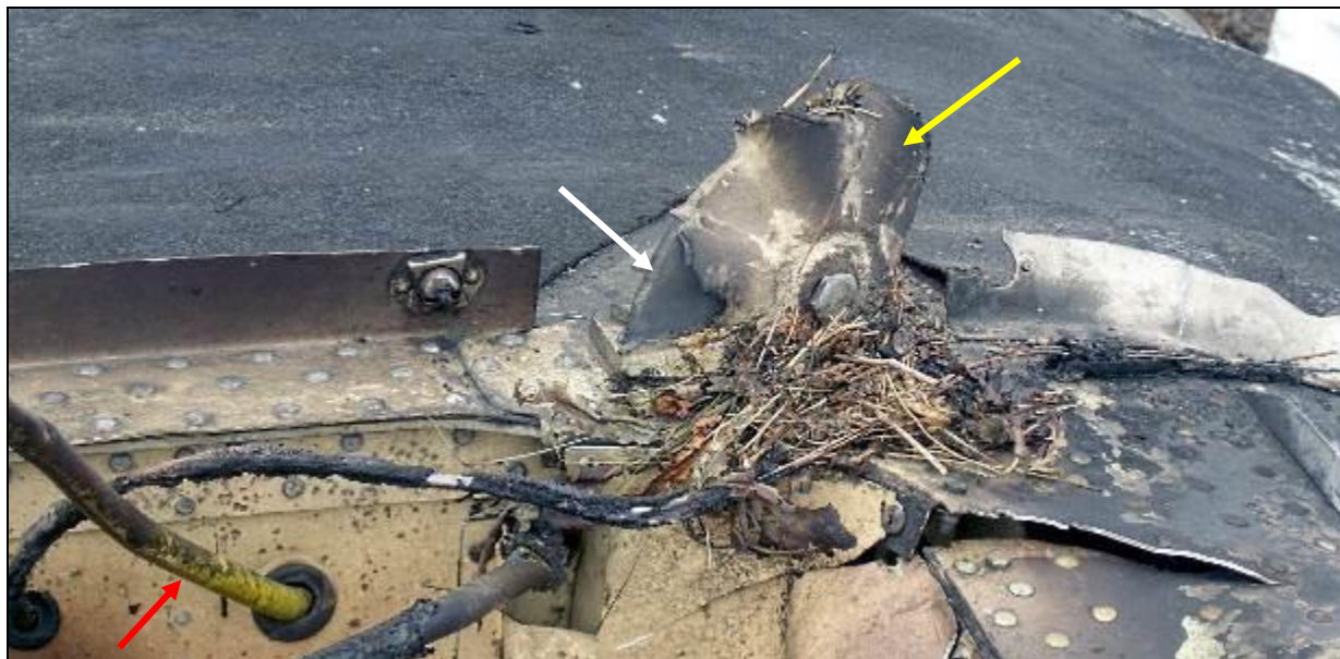
71 - Lewe przednie okucie mocowania centroplata do kadłuba (strzałka biała) i odpowiadające mu okucie na kratownicy kadłuba (strzałka żółta). Strzałką czerwoną wskazany przewód paliwowy.
