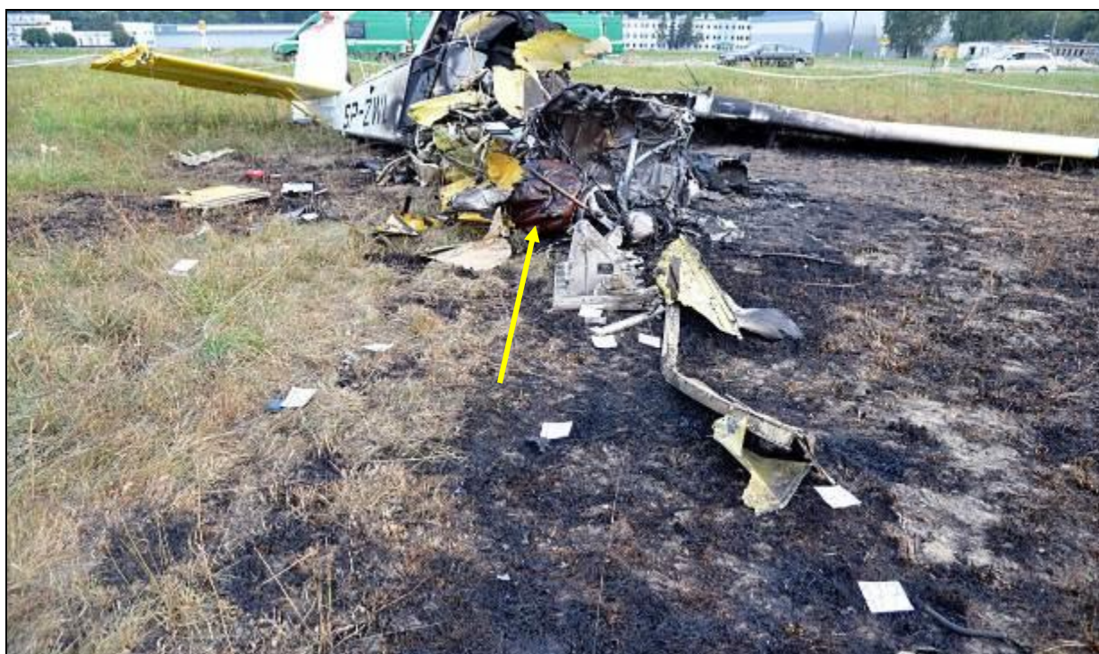
45 – Widok ogólny wraku \frac{3}{4} od przodu i z prawej strony kadłuba – zbliżenie. Żółtą strzałką wskazany zniszczony zbiornik oleju. [foto: Żandarmeria Wojskowa].
