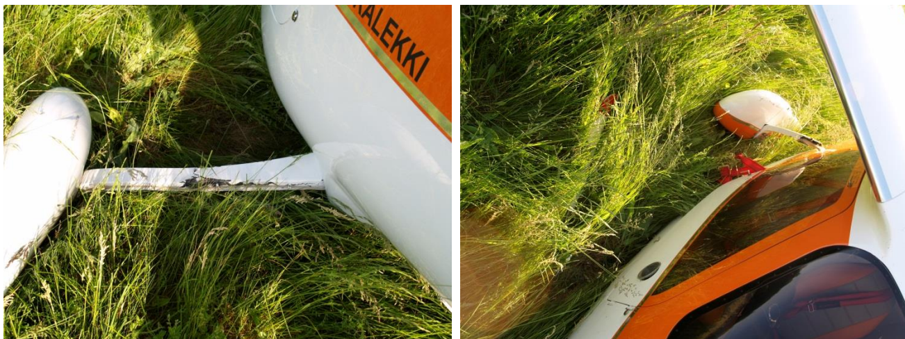
Uszkodzenia lewej i prawej nogi podwozia głównego
