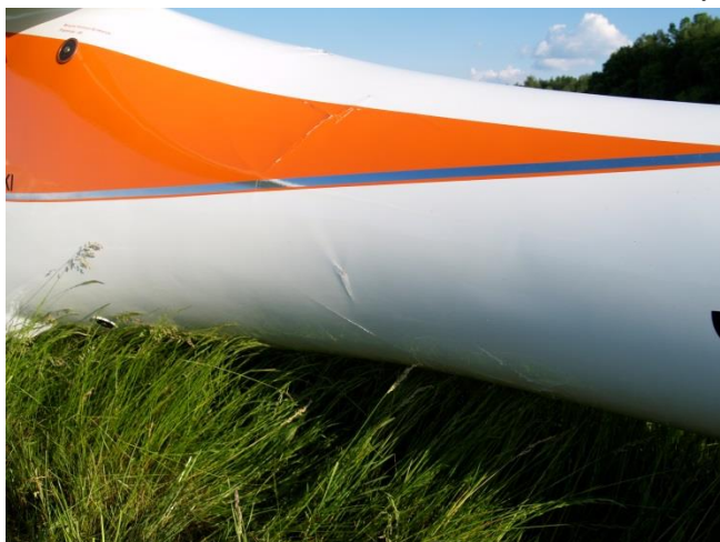
Uszkodzenia kadłuba oraz widok kabiny (pierwszy na dole z lewej strony wskaźnik wychylenia kłapy)
