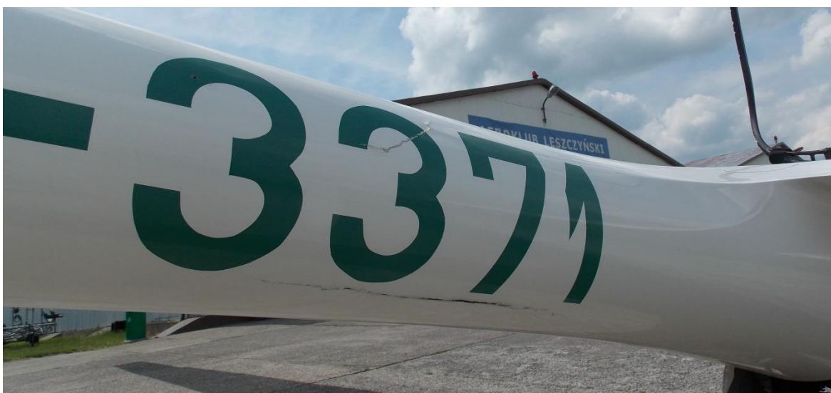
Rys. 4. Uszkodzenia poszycia belki ogonowej.
