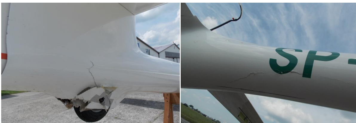
Rys. 2. i 3. Uszkodzenia w rejonie zabudowy tylnego kółka i poszycia belki ogonowej.
