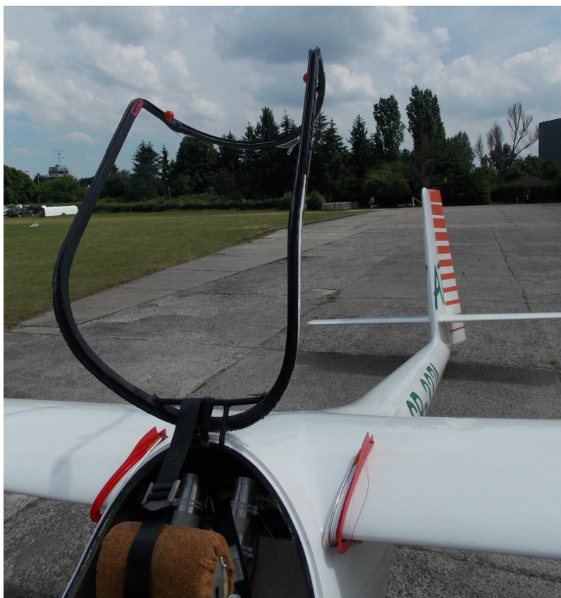
Rys. 5. Stan osłony kabiny po wypadku. Widoczny brak oszklenia.
