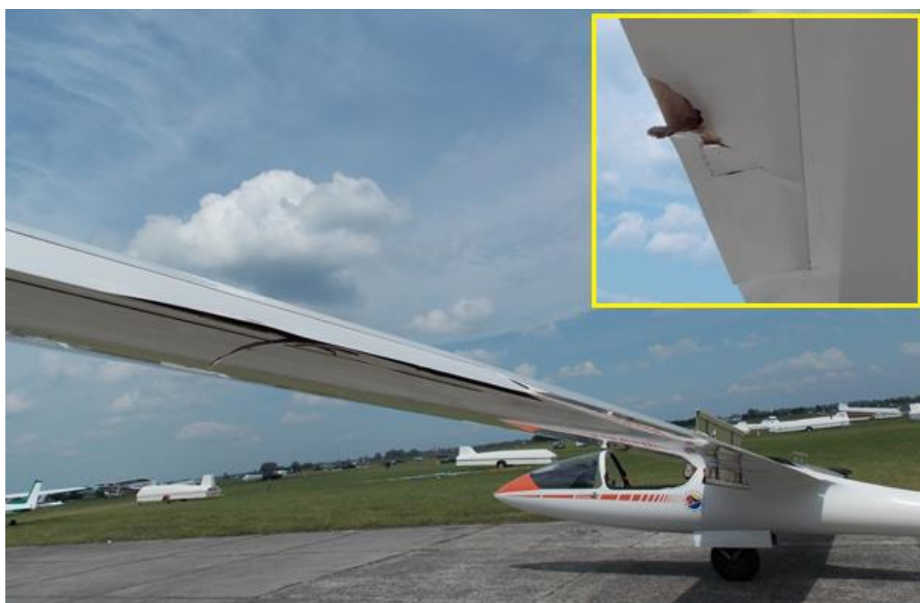
Rys. 6. Uszkodzenia lotki lewego skrzydła. W żółtej ramce pokazano uszkodzenie dolnego poszycia lotki przy końcówce.
