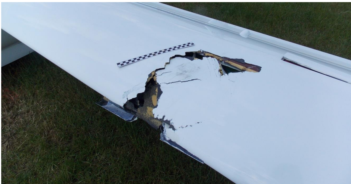
Rys. 7. Uszkodzenia kesonu i hamulca aerodynamicznego lewego skrzydła.
