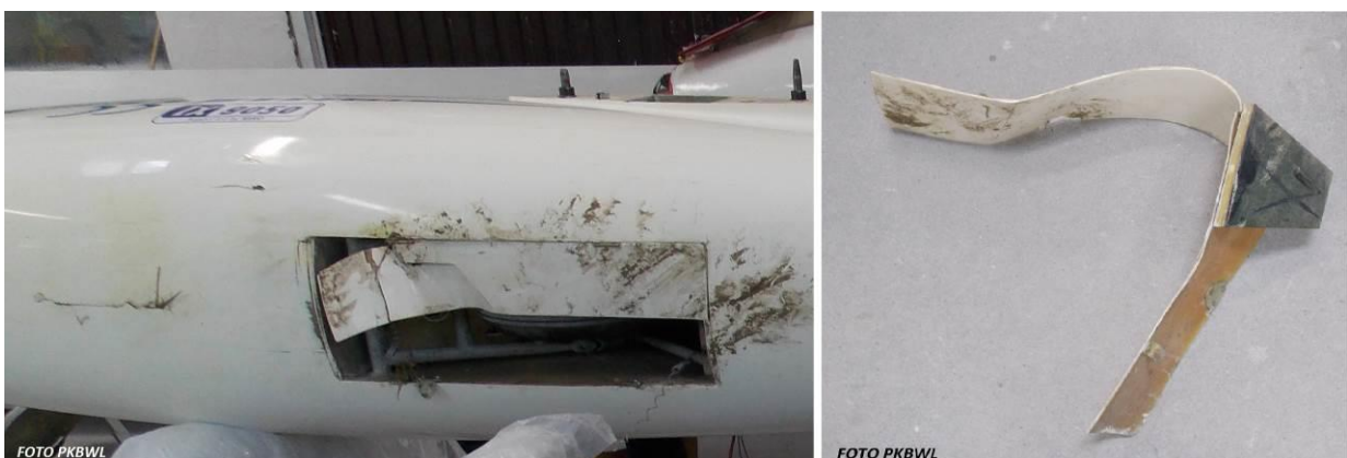
Ilustracja nr 3. Uszkodzenia kadłuba. Widoczne pęknięcia poszycia i powyginane klapki podwozia.
