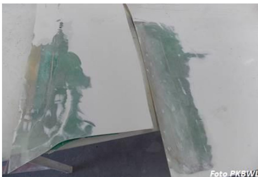
Ilustracja nr 9. Ślady naprawy prawego skrzydła - od dźwigara w kierunku krawędzi spływu.
