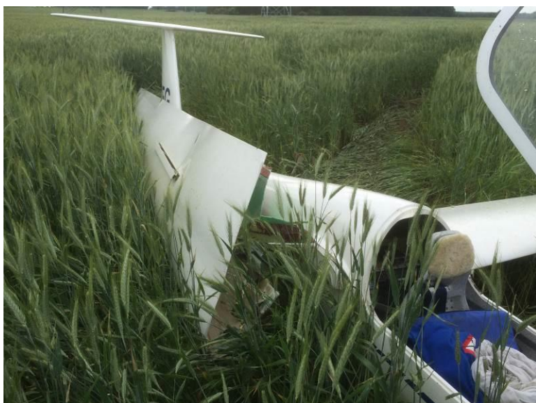
Ilustracja nr 8. Uszkodzony szybowiec po lądowaniu w terenie przygodnym. Widoczny ślad dobiegu pozostawiony przez szybowiec w trakcie lądowania w zbożu.
