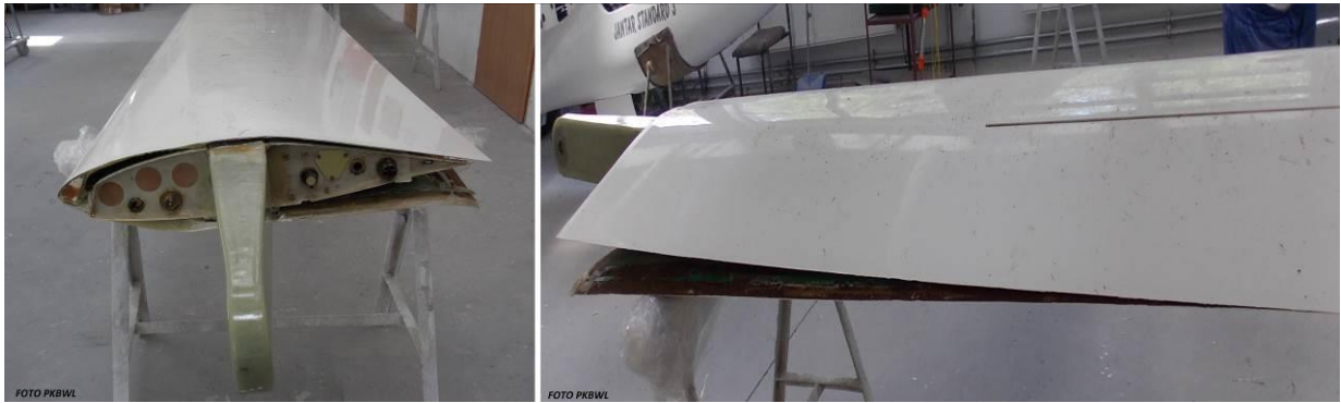
Ilustracje nr 1. Uszkodzenia prawego skrzydła. Widoczne wylamane żebro zamykające skrzydło od strony kadłuba.
