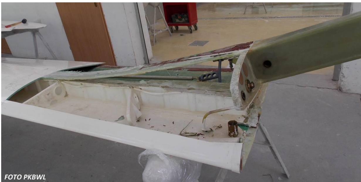
Ilustracja nr 2. Widoczny zakres uszkodzeń po zdjęciu poszycia prawego skrzydła.
