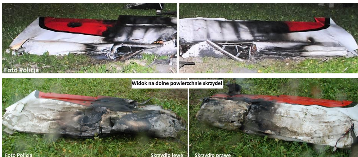
Ilustracje nr 11. Na górnym zdjęciu, widoczna górna powierzchnia skrzydeł samolotu, rozerwane zbiorniki paliwa i podgięte do góry krawędzie natarcia skrzydeł. Na dolnym zdjęciu widać popalowane poszycie przedniej części poszycia dolnej powierzchni skrzydeł.
