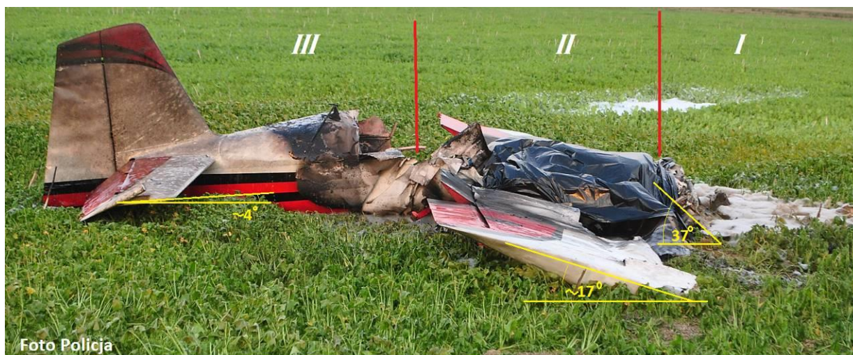
Ilustracja nr 10. Uszkodzony samolot, widoczne trzy części na jakie się przelamał. Zaznaczono przybliżone kąty przelamanych części w stosunku do poziomu.
