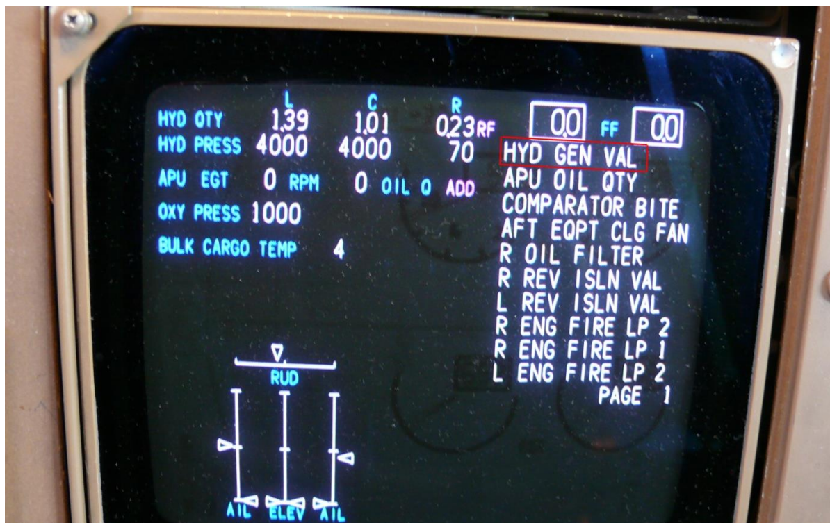
Ilustracja 16. Komunikat HYD GEN VAL na ekranie EICAS
