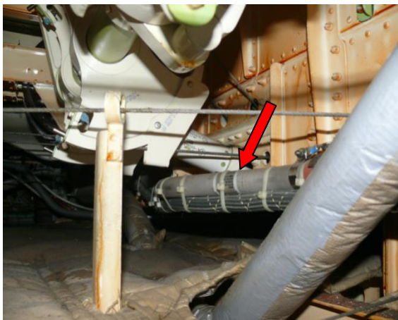
Ilustracja 19. Ogranicznik przeciążeń alternatywnego systemu wypuszczania przedniego podwozia. (Źródło – PKBWL)
