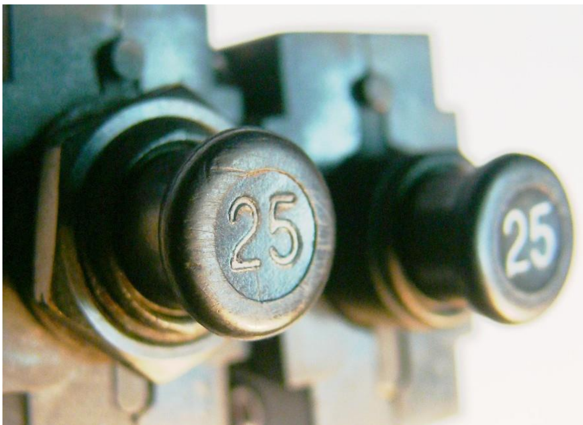
Ilustracja 9. Główki bezpieczników C829 (z lewej strony z samolotu SP-LPC, z prawej nowy)
