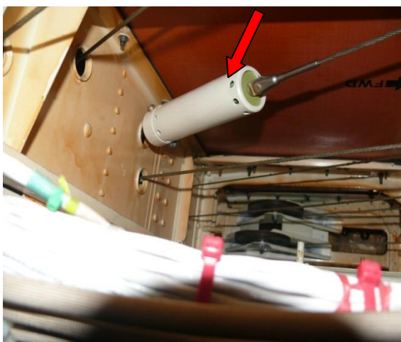
Ilustracja 20. Ogranicznik przeciążeń alternatywnego systemu wypuszczania lewego podwozia głównego. (Źródło – PKBWL)
