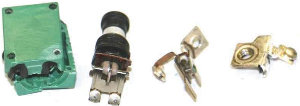
Ilustracja 22: Rozmontowany bezpiecznik BACC18Z7R.
