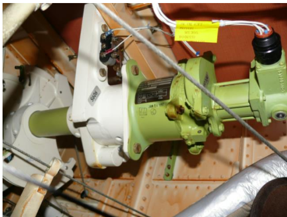
Ilustracja 18. Siłownik elektryczny alternatywnego systemu wypuszczania podwozia. (Źródło – PKBWL)
