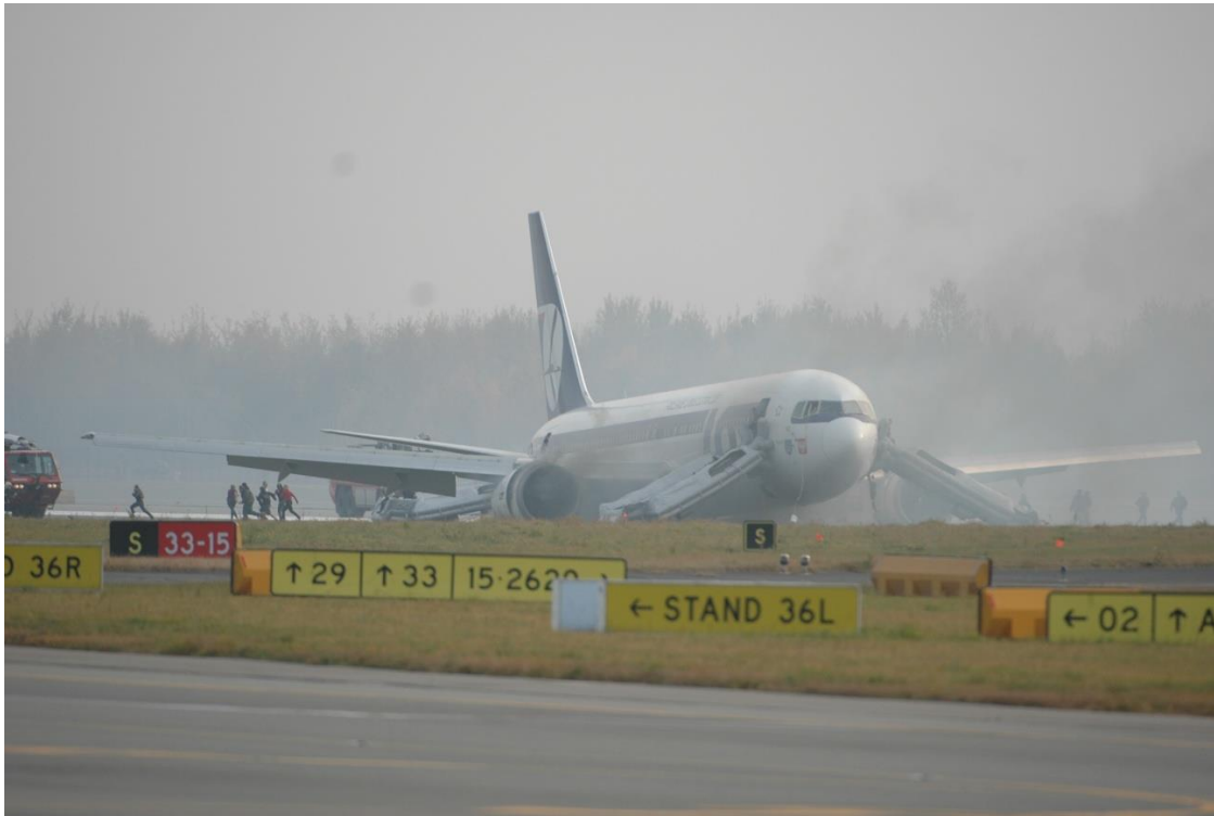
Ilustracja 10. Wypuszczone trapy samolotu SP-LPC i ewakuacja pasażerów.
