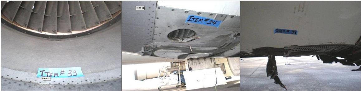
Ilustracja 3. Uszkodzenia lewej gondoli silnika – od lewej wewnątrz wlotu wentylatora, dół i odwracacz ciągu. (Źródło –Boeing).
