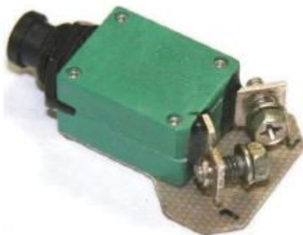
Ilustracja 6. Bezpiecznik BACC18Z7R w stanie, w jakim został odebrany.
