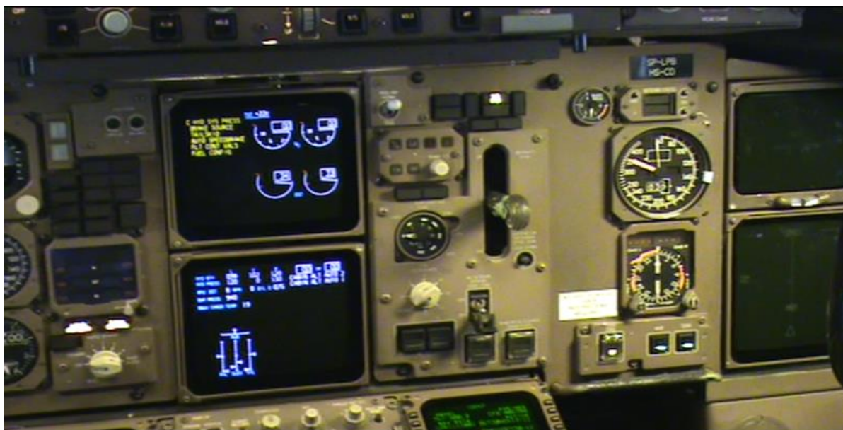
Ilustracja 2. Test wypuszczania podwozia z bezpiecznikiem C829 (A1) w pozycji OFF
