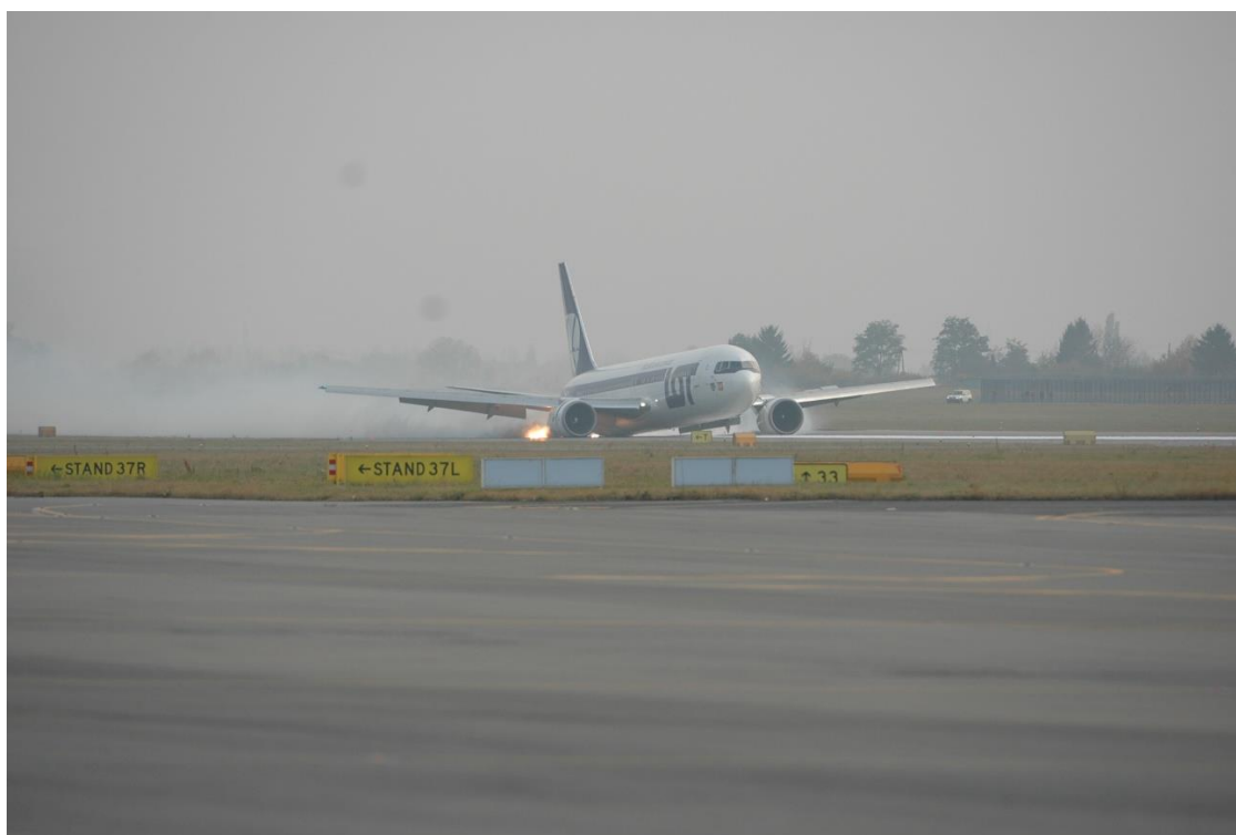
Ilustracja 7. Dobieg samolotu SP-LPC i pożar prawego silnika.
