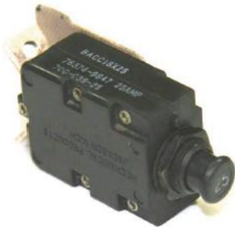
Ilustracja 8. Bezpiecznik BACC18X25 w stanie, w jakim został odebrany.
