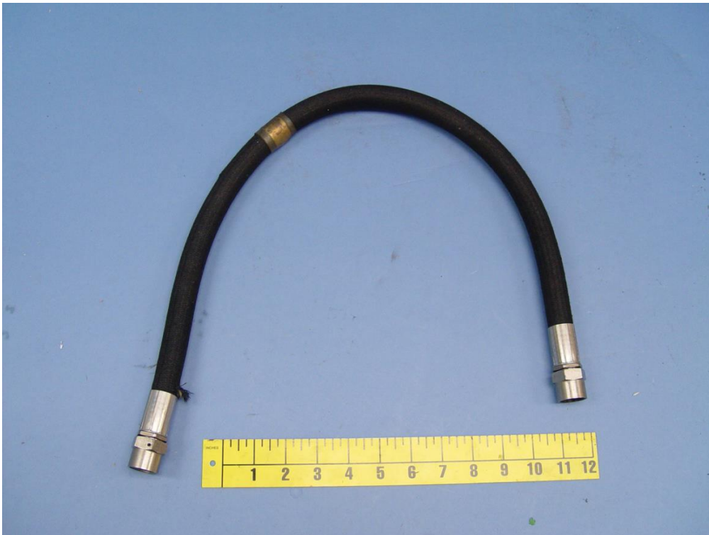
Ilustracja 1. Ogólny widok przewodu hydraulicznego z wypadku.
