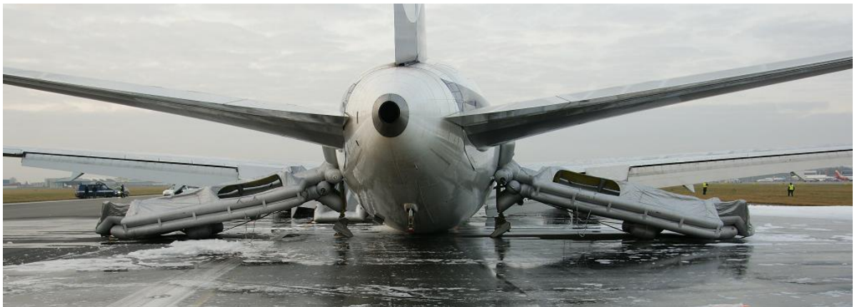
Ilustracja 16. Ułożenie tylnych trapów samolotu SP-LPC po awaryjnym lądowaniu.
