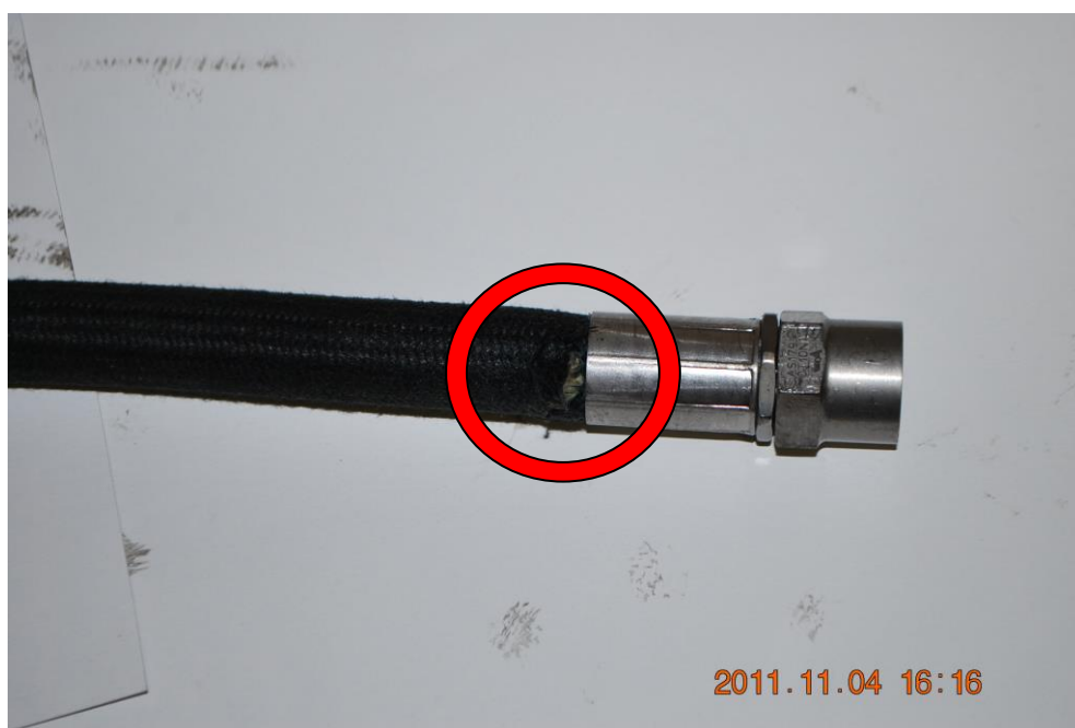
Ilustracja 24. Uszkodzenie przewodu z instalacji hydraulicznej samolotu SP-LPC - zbliżenie. (Źródło: PKBWL)
