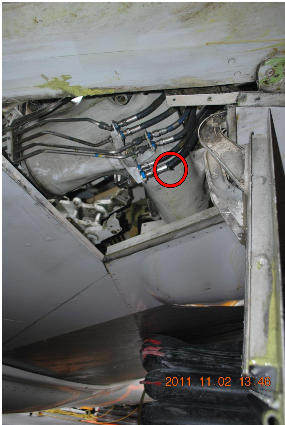
Ilustracja 22. Uszkodzony przewód hydrauliczny (zaznaczony czerwonym okręgiem) na prawym podwoziu głównym samolotu SP-LPC. (Źródło – PKBWL)
