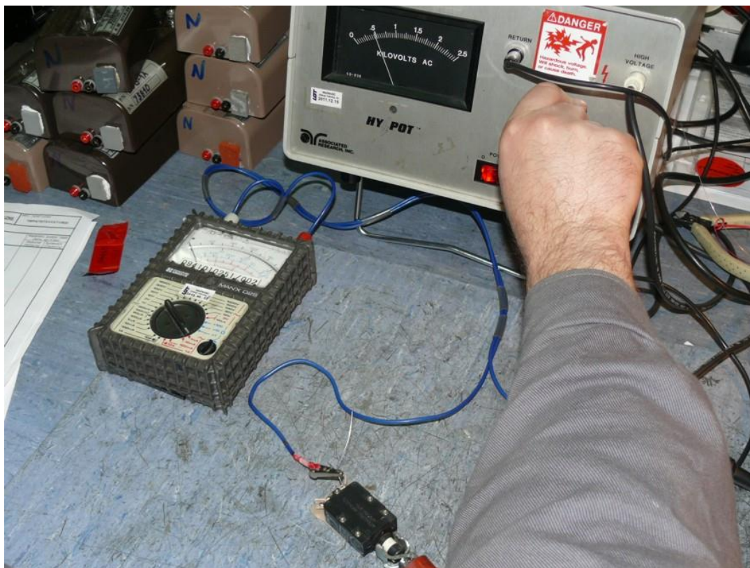
Ilustracja 14. Pomiar wytrzymałości napięciowej bezpiecznika C829
