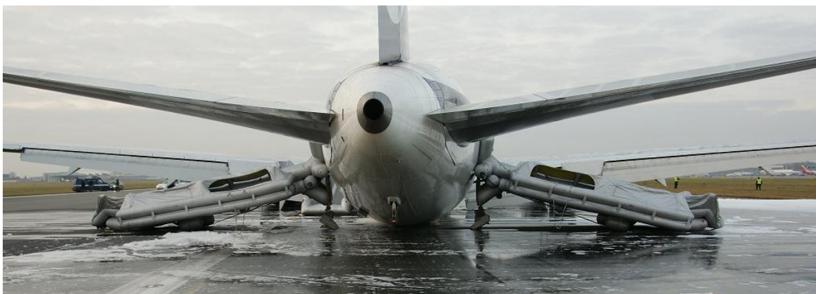
Ilustracja 4. Ułożenie tylnych trapów samolotu SP-LPC po lądowaniu ze schowanym podwoziem.
