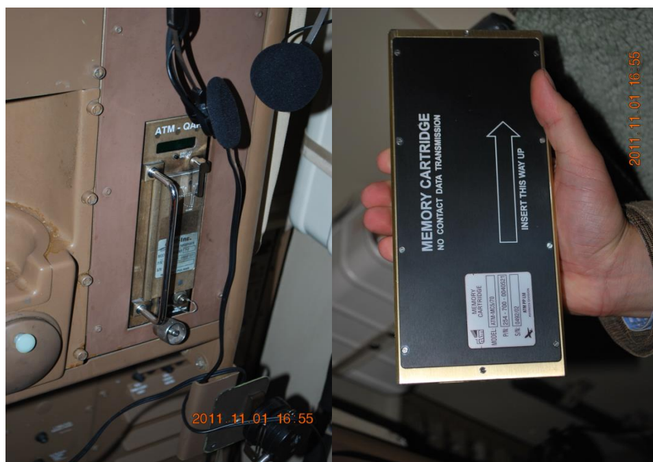
Ilustracja 9. Rejestrator QAR wraz z kasetą pamięci z samolotu SP-LPC. (Źródło: PKBWL)
