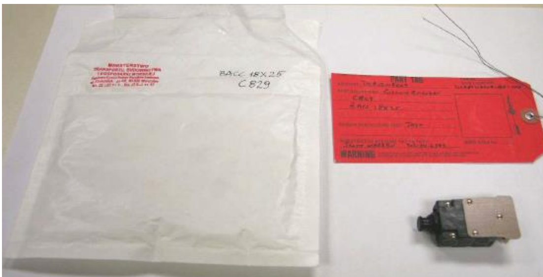
Ilustracja 4. Bezpiecznik BACC18X25 wyjęty z opakowania.
