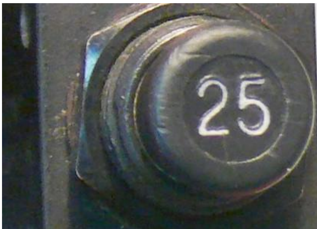
Ilustracja 10. Widok główki bezpiecznika C829 z samolotu SP-LPC
