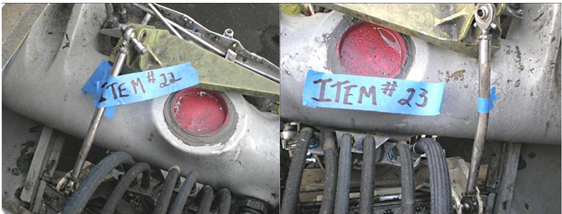
Ilustracja 2. Uszkodzone zastrzały pokryw luków podwozia głównego (lewy i prawy). (Źródło – Boeing).
