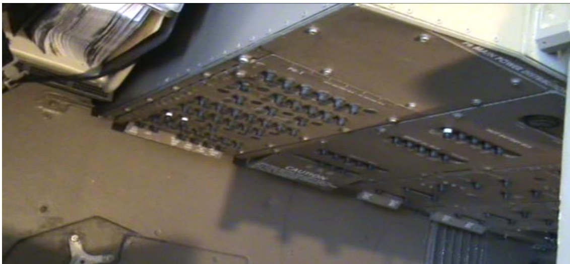
Ilustracja 3. Widok z fotela FO na panel bezpieczników P6 bez walizki
