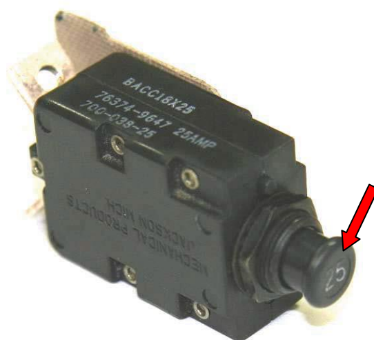
Ilustracja 5. Bezpiecznik C829 wybudowany z samolotu SP-LPC. Bezpiecznik w stanie włączonym/wciśniętym. Czerwona strzałka wskazuje główkę bezpiecznika (Źródło –Boeing).
