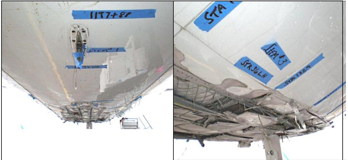
Ilustracja 1. Uszkodzenia dolnej części kadłuba w rejonie sekcji 46 – widok od przodu i zbliżenie. (Źródło – Boeing).
