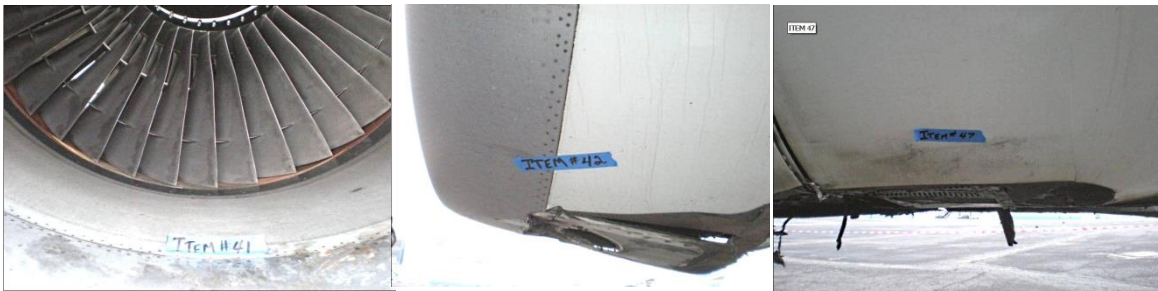
Ilustracja 4. Uszkodzenia prawej gondoli silnika – od lewej wewnątrz wlotu wentylatora, dół i odwracacz ciągu. (Źródło –Boeing).
