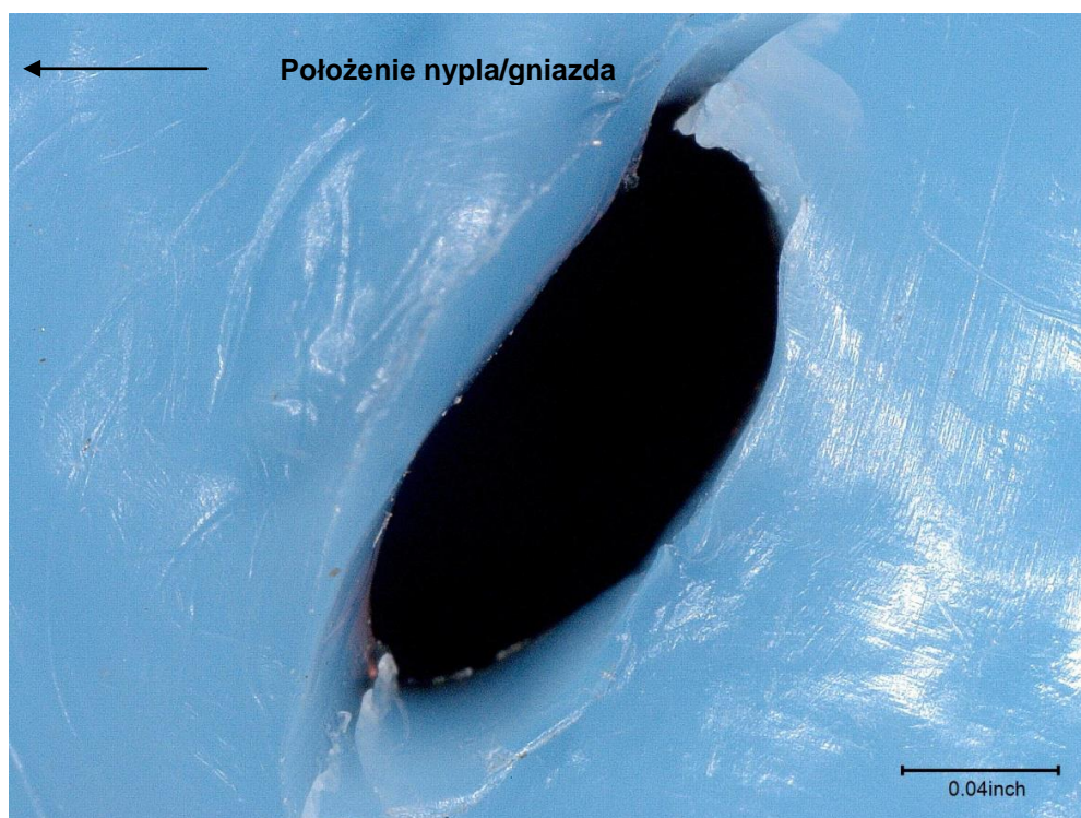
Ilustracja 4. Zdjęcie szczeliny w ścianie bocznej przewodu w powiększeniu.
