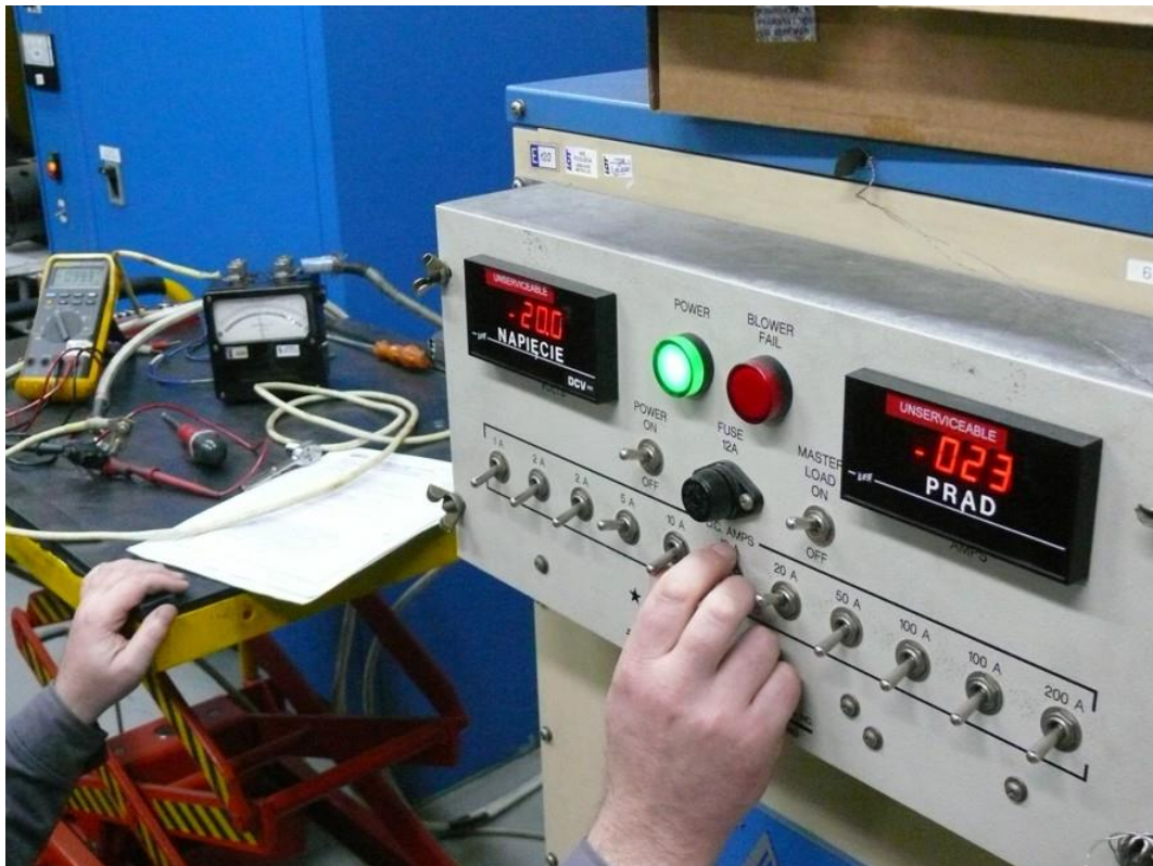
Ilustracja 13. Pomiary prądów bezpiecznika C829
