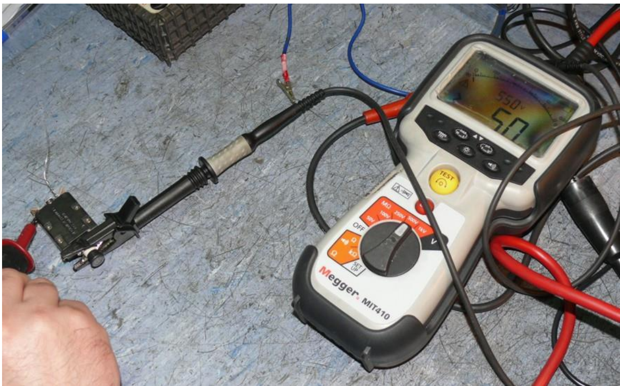
Ilustracja 12. Pomiar rezystancji izolacji bezpiecznika C829
