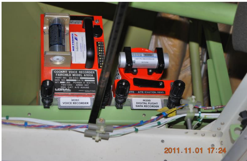
Ilustracja 8. Rejestratory SSFDR i CVR z samolotu SP-LPC. (Źródło: PKBWL)
