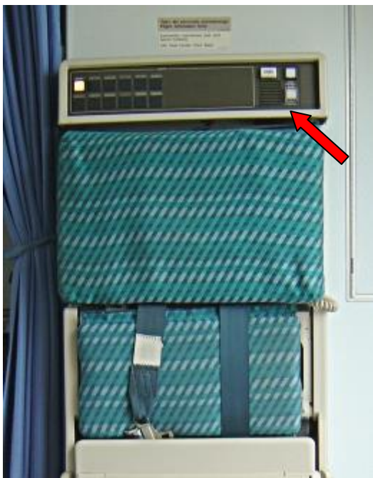
Ilustracja 6. System sygnalizacji do ewakuacji nad fotelem CC5.
