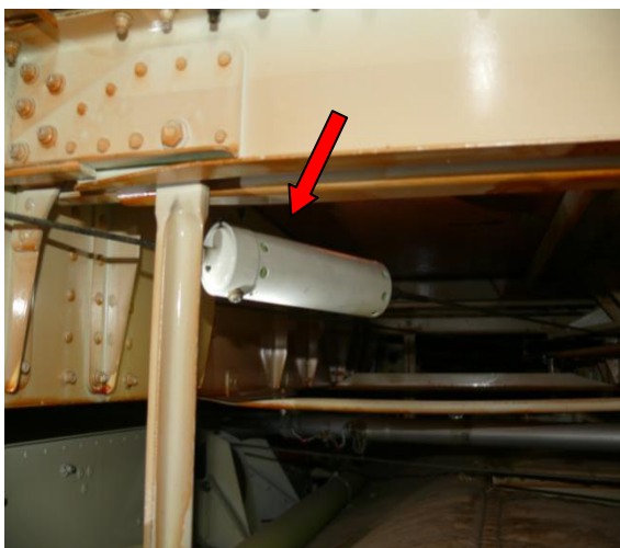
Ilustracja 21. Ogranicznik przeciążeń alternatywnego systemu wypuszczania prawego podwozia głównego. (Źródło – PKBWL)
