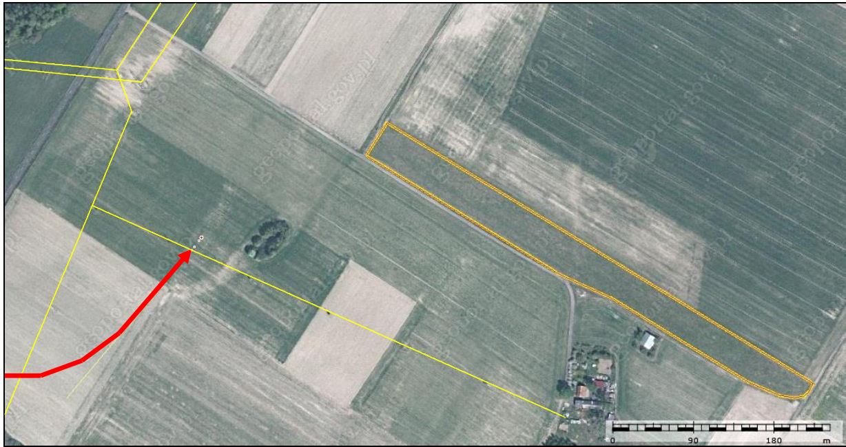
3 – Najbliższe otoczenie miejsca wypadku na ortofotomapie, zaznaczone elementy sytuacji – kolorem żółtym linie energetyczne, pomarańczowym granice lądowiska, czerwonym końcowy odcinek podejścia [geoportal].
