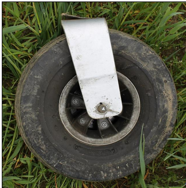
23 – Oderwane od goleni wraz z widelcem koło lewego podwozia głównego [fot.Policja].
