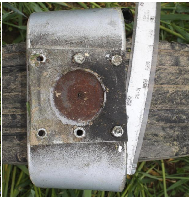
24 – Oderwane od goleni wraz z widelcem koło lewego podwozia głównego – widok z góry [fot.Policja].
