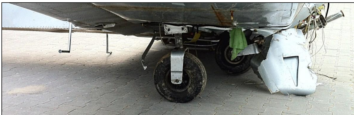
10 – Widok od spodu na prawe skrzydło i prawe podwozie główne.
