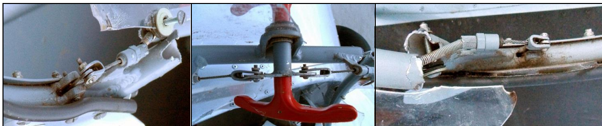
18, 19, 20 – Centralna dźwignia otwierania i zamykania osłony na tylnym łuku jej szkieletu w samolocie OK-LUA47 (zdjęcie środkowe) oraz lewe i prawe wyprowadzenie linek napędu zamków na tylnych dolnych narożach szkieletu osłony.
