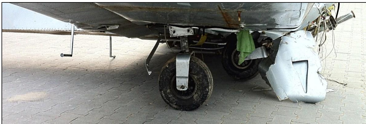
25 – Widok od spodu na prawe skrzydło i prawe podwozie główne oraz wyłamane podwozie przednie.
