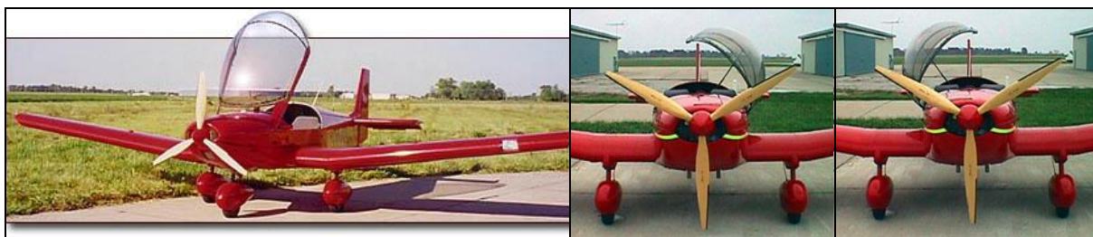
7, 8, 9 – Różne systemy mocowania i otwierania osłony kabiny samolotu CH-601 Zodiac [foto: internet].
