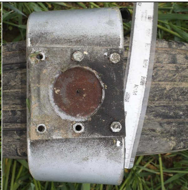
27 – Oderwane od goleni wraz z widelcem koło lewego podwozia głównego – wid. z góry [fot.KPP Wągrowiec].
