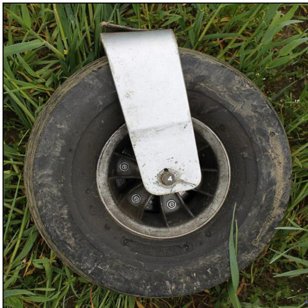
26 – Oderwane od goleni wraz z widelcem koło lewego podwozia głównego [fot.KPP Wągrowiec].
