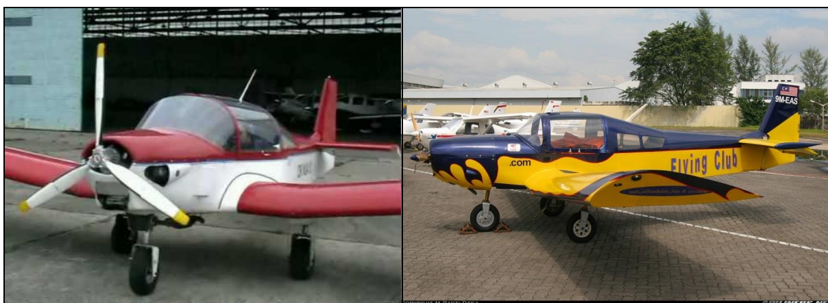
10, 11 – Przykłady oszklenia kabiny samolotu CH-601 Zodiac z podziałem na wiatrochron i osłonę odsuwaną do tyłu [foto: internet].
