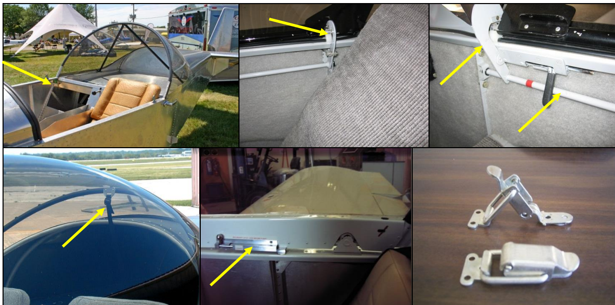
12, 13, 14, 15, 16, 17 – Różne zamki oraz sposoby i środki dodatkowego zabezpieczenia osłony kabiny przed otwarciem podczas lotu [foto: internet].
