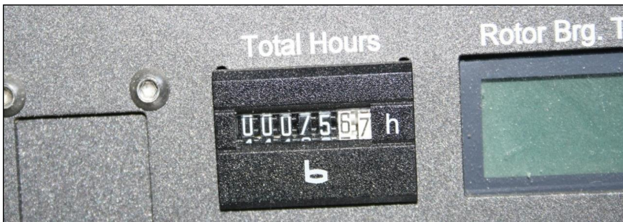
Rys.2 . Liczba wylatanych motogodzin wg licznika w kabinie w dniu zdarzenia (foto: PKBWL).
