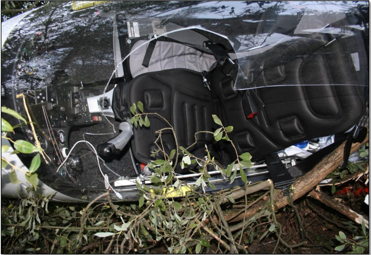
Rys.5. Widoczne uszkodzenie kabiny wiatrakowca (foto: PKBWL).
