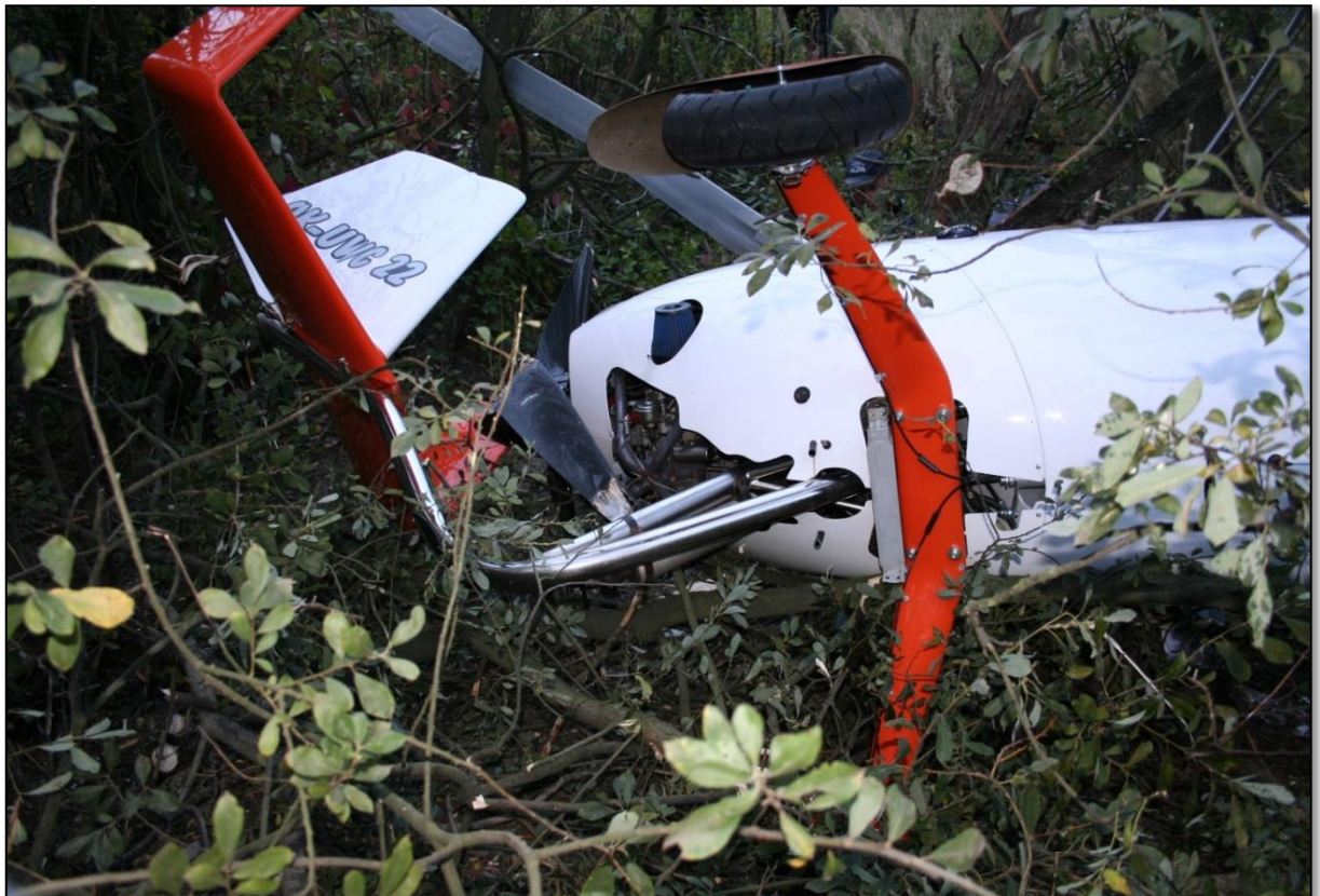
Rys.6. Widoczne uszkodzenia kadłuba , podwozia , statecznika (foto: PKBWL).
