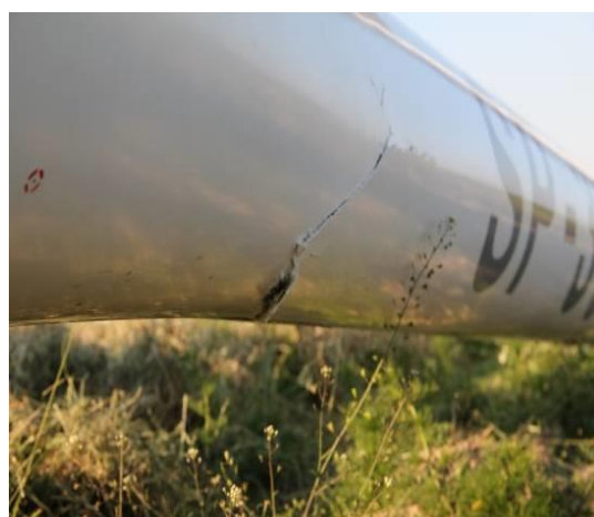
Rys. 2 Uszkodzenia kadłuba szybowca: widok z góry i z lewej strony
