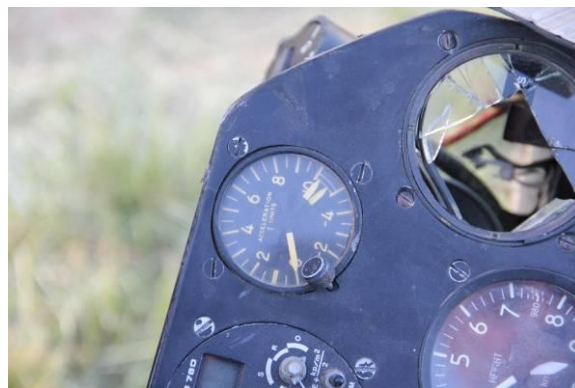
Rys.8 Fragment tablicy przyrządów. Przeciężeniomierz wskazuje graniczne wartości jego wskazań: +10g, -5g.
