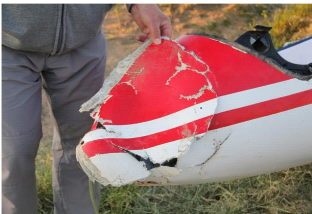
↑ Rys. 11 Wgniecenie części nosowej szybowca wskazuje na zderzenie kadłuba z ziemią w lewym ślizgu.
