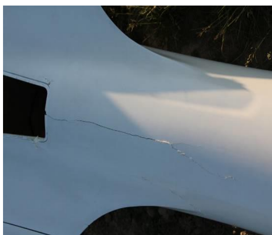
Rys. 2 Uszkodzenia kadłuba szybowca: widok z góry i z lewej strony
