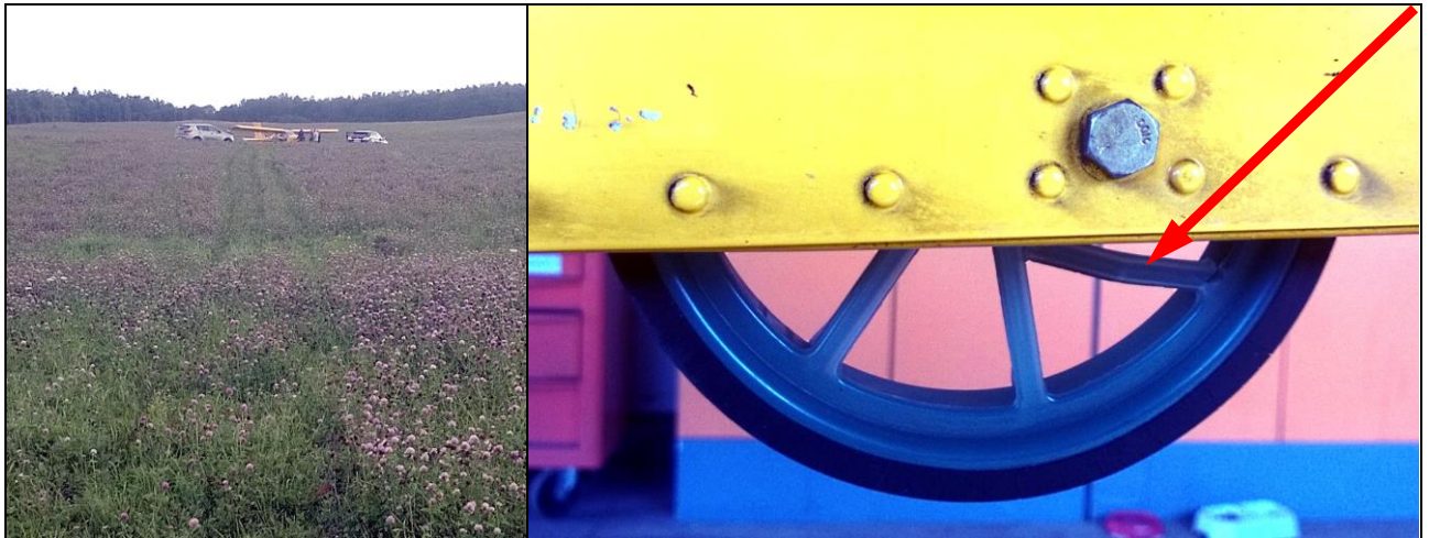
1, 2 – Miejsce lądowania z widocznym śladem i uszkodzone kółko ogonowe.
