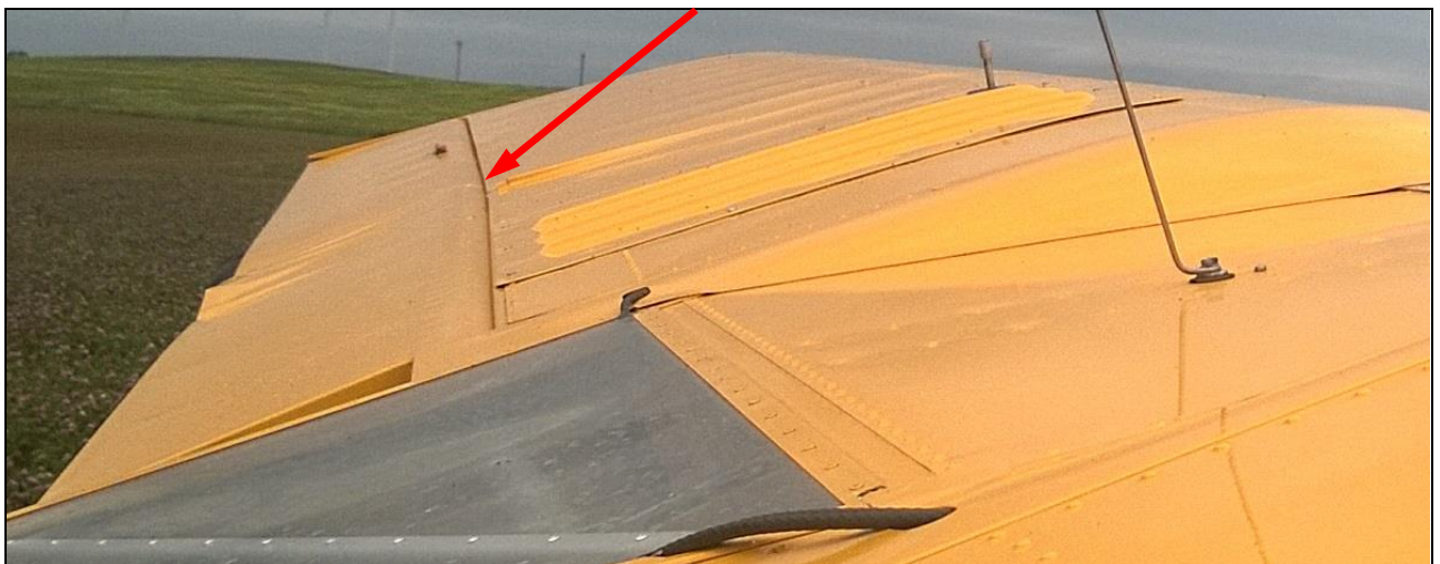
3 – Widok na górną powierzchnię lewego skrzydła. Zwraca uwagę widoczne załamanie szczeliny klapolotki.
